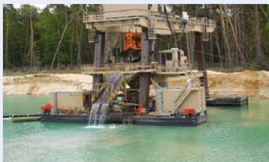
Auch aus sehr großen Wassertiefen können Schwimmgreifer große Mengen auch grobkörniger Kiessande gewinnen. Moderne, sehr große Schwimmgreiferanlagen kosten über 4 Mio. €, Foto: BGR.
