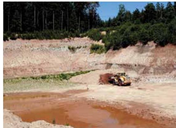
*Im Sandtagebau Gsteinach der Fa. Sand Adler GmbH & Co. KG wird sehr mürber, rund 210 Mio. Jahre alter „Burgsandstein“ mittels Hydraulikbagger abgebaut und mittels Radlader zur Produktionsanlage transportiert, Foto: BGR.*
