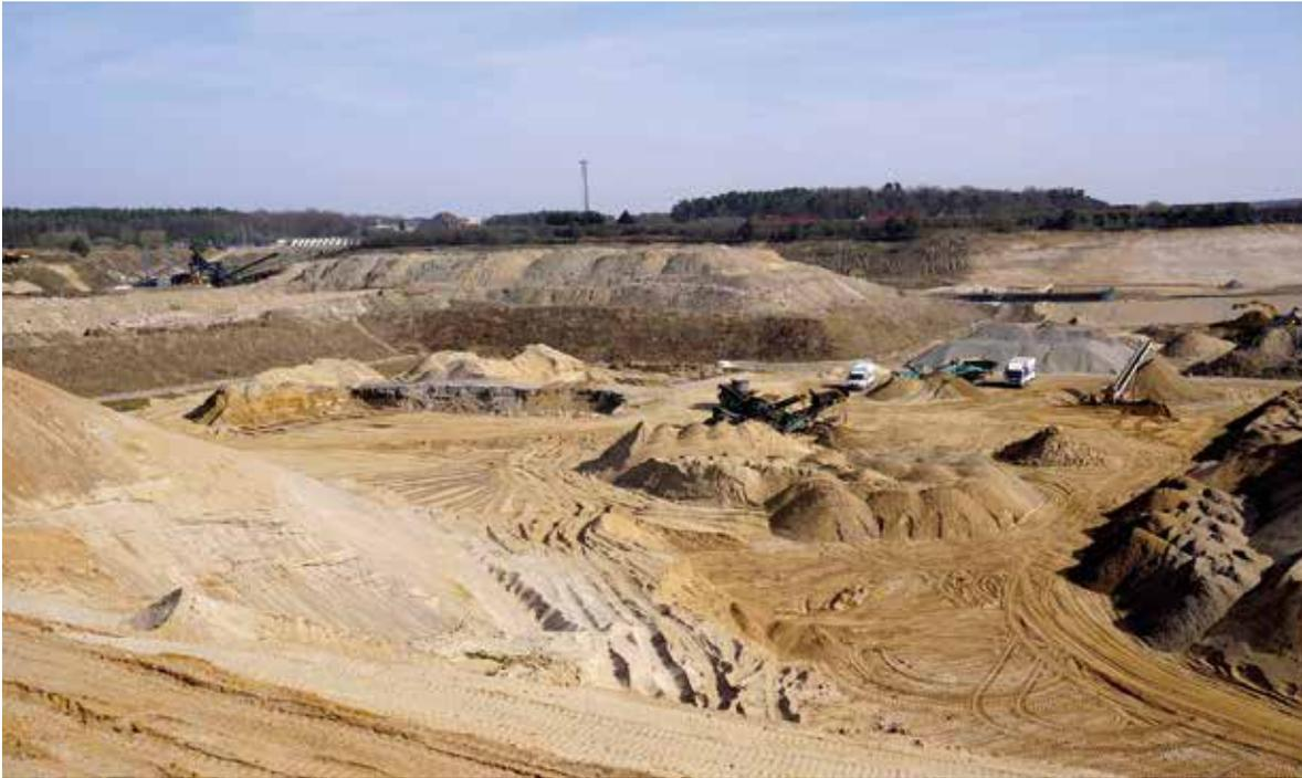
*Am Standort Consrade wird nicht nur im Trockenen Kiessand abgebaut, sondern zudem in großem Umfang Bauschutt recycelt, Boden aufbereitet und auch deponiert, Foto: BGR.*
