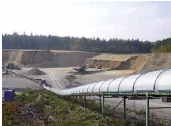
*Das KW Gräfelfing der Bernhard Glück Kies-Sand-Hartsteinsplitt GmbH wird seit über 50 Jahren aus einem Abbaugebiet in Planegg mit Rohmaterial versorgt. Der Transport erfolgt über ein 2,5 km langes, größtenteils in einem unterirdischen Tunnel verlegtes Förderband, Foto: BGR.*
