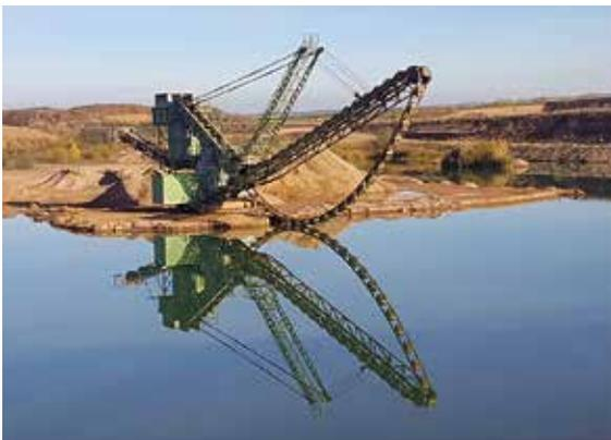
*Im KW Arnstadt ist ein landgestützter Eimerkettenbagger zur Gewinnung der Kiessande unterhalb des Grundwasserspiegels im Einsatz, Foto: Märker Kies GmbH (mit frdl. Genehmigung).*
