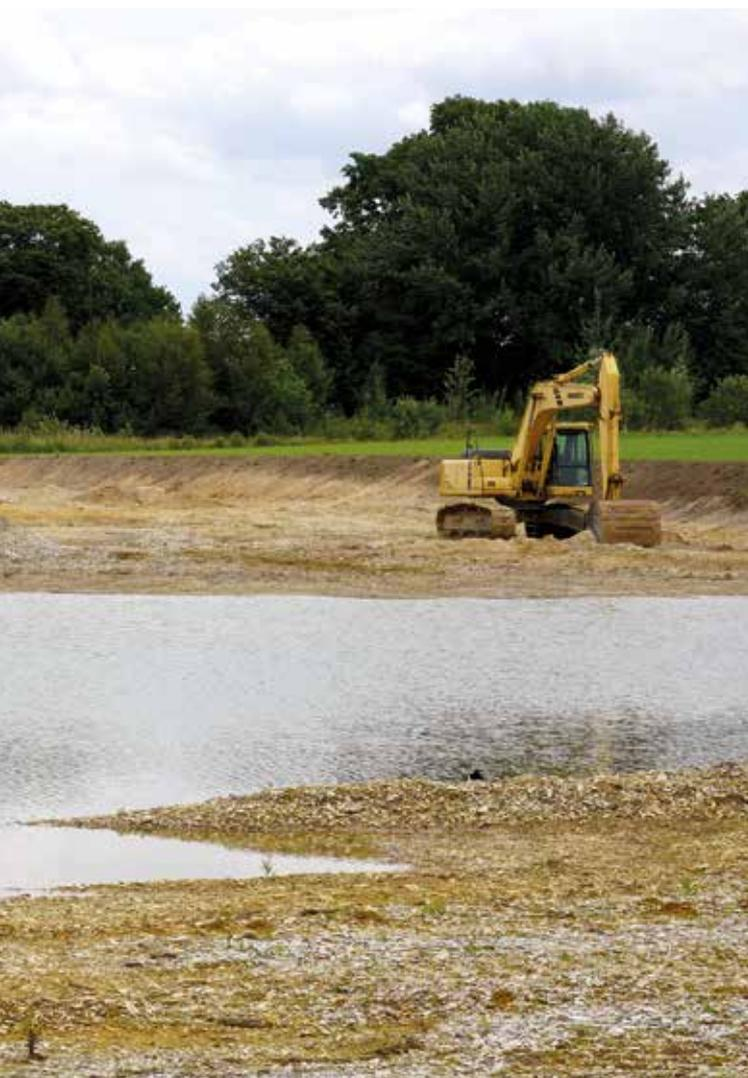
*Nachdem der 1,5 – 2 m mächtige Abraum mit einem Standardhydraulikbagger geräumt wurde, erfolgt im Abbaufeld „Brockhofsee“ die Gewinnung der Plänerschotter der Lippe-Niederterrasse mit einem Saugbagger. Auf der bereits geräumten Rohkiesfläche brüten derweil Austernfischer, Foto: BGR.*
