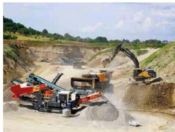
*Im KW Engen-Anselfingen der Kohler Kieswerk GmbH sind zum Brechen des Überkorns und des Grobkieses verschiedene mobile Brecher im Einsatz, Foto: BGR.*
