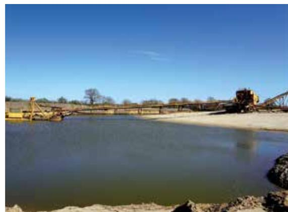
*In der Gewinnungsstelle Klein Rheid – Tillhorn der Firma Jans-Naturkies wird der Rohkiessand mittels Saugbagger gewonnen, die Kiesfraktion abgetrennt und der Sand gleich danach wieder verspült, Foto: BGR.*
