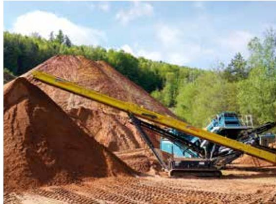
*Aus unbelastetem Bodenaushub gewinnt die Fa. Matthias Groh e.K. bei Niederwürzbach hochwertigen Sand für den Kanal- und Rohrleitungsbau und schont damit unsere natürlichen Ressourcen, Foto: BGR.*
