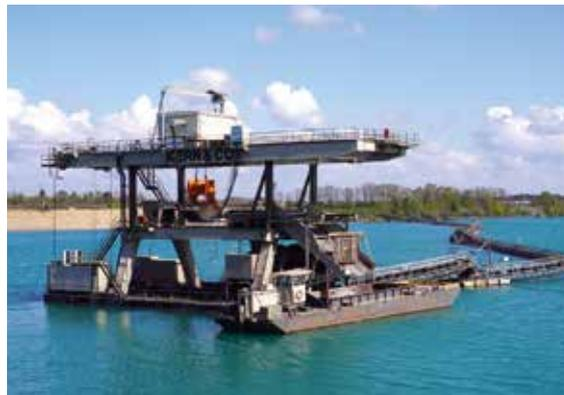
*Die Fa. KBI Kieswerk und Baustoff-Industrie Kern GmbH & Co. KG setzt zur Auskiesung einen 8 m<sup>3</sup>-Hydraulikgreifer ein, von dem der Kiessand nach Abtrennung von großen Steinen per Förderband in die Aufbereitungsanlage transportiert wird, Foto: BGR.*
