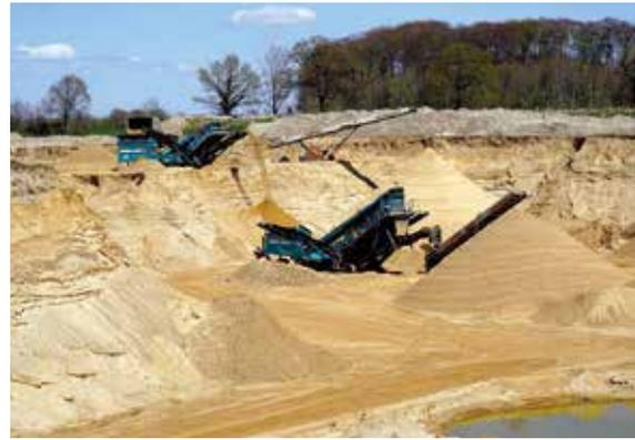
*Im KW Borstel der Giese Kiesaufbereitungsges. mbH werden die dort bis zu 15 m mächtigen Kiessande sowohl aus zwei Baggerseen, als auch im Trockenem gefördert, Foto: BGR.*
