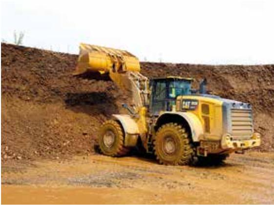
*Im KW Aue der Gebr. Gropengießer GmbH werden die Flussschotter der Oderaue mittels Radlader aus der Wand gewonnen und dann über ein derzeit 2.450 m langes Förderband in die Aufbereitungsanlage transportiert, Foto: BGR.*
