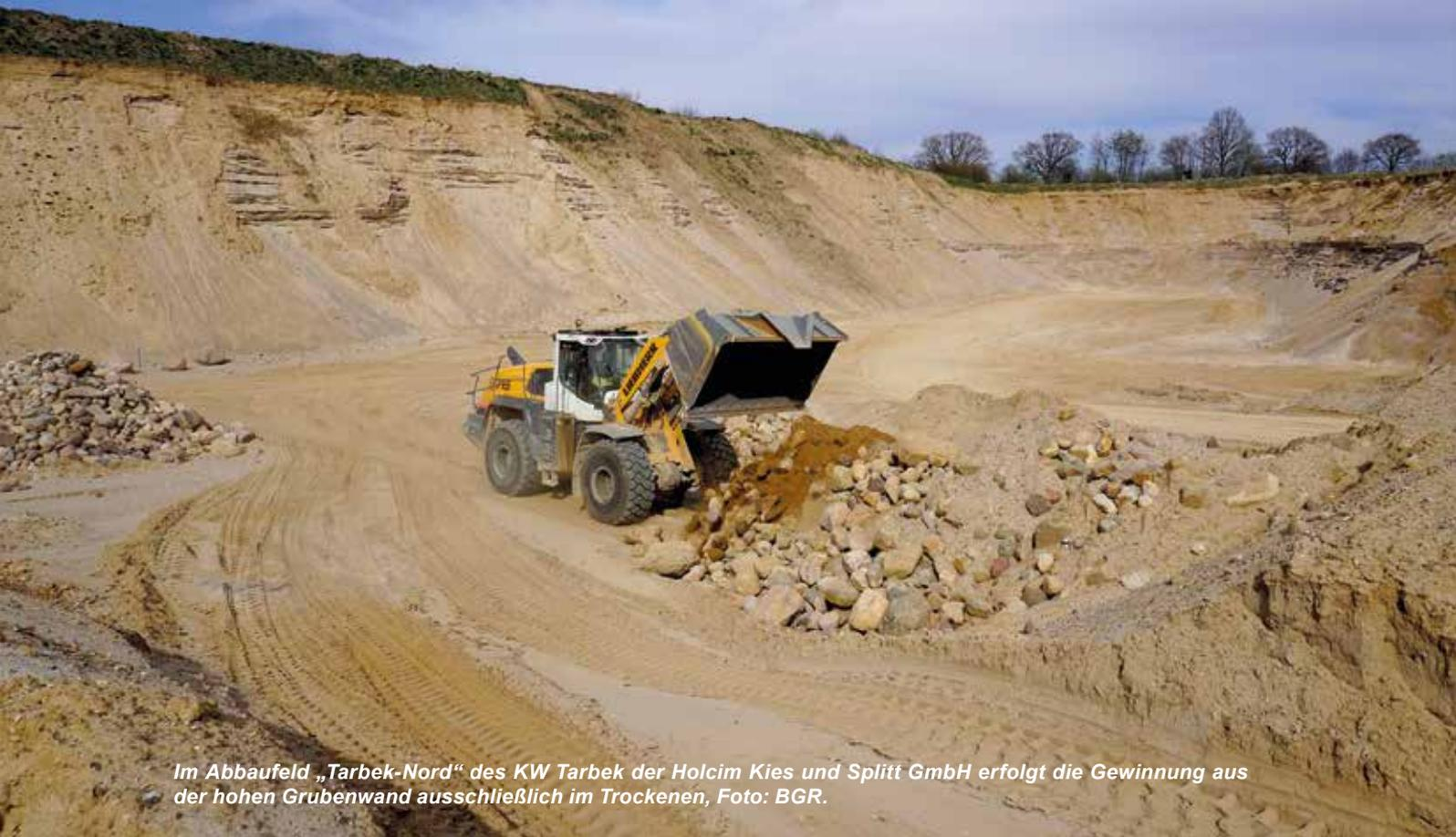
*Im Abbaufeld „Tarbek-Nord“ des KW Tarbek der Holcim Kies und Splitt GmbH erfolgt die Gewinnung aus der hohen Grubenwand ausschließlich im Trockenem, Foto: BGR.*
