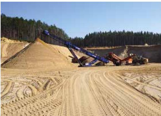
*Im KW Steinwalde-Ost der CEMEX Kies Mecklenburg-Strelitz GmbH wird zu Beginn der Aufbereitung der Sand trocken abgeseibt, Foto: BGR.*
