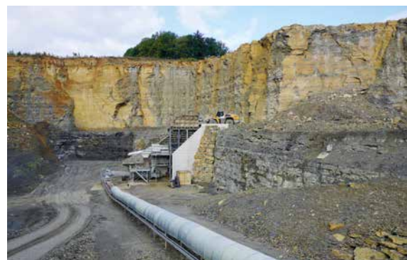
Im schmalen Steinbruch Buchen-Eberstadt gelangt das über einen Backenbrecher vorzerkleinerte Haufwerk über ein langes Förderband in die stationäre Aufbereitungsanlage, Foto: BGR.
