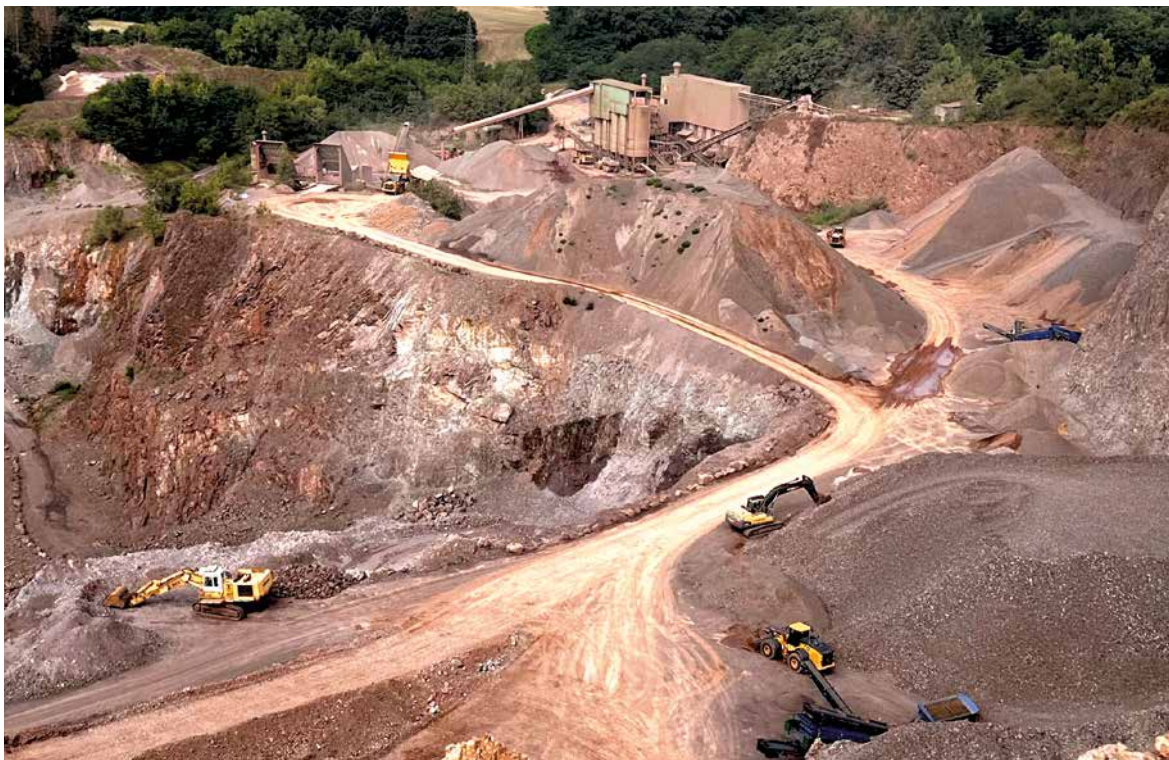
Blick in den Andesitsteinbruch Beckingen-Reimsbach mit Abbautätigkeit auf verschiedenen Sohlen, Foto: Gebr. Arweiler GmbH & Co. KG (mit frdl. Genehmigung).
