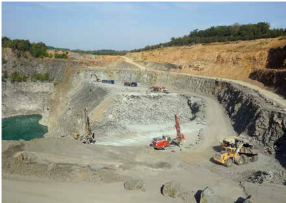
In der Abbaustelle Glockenpöhl des Steinbruchs Bösenbrunn wird Diabas unter tonigem Abraum abgebaut, Foto: BGR.
