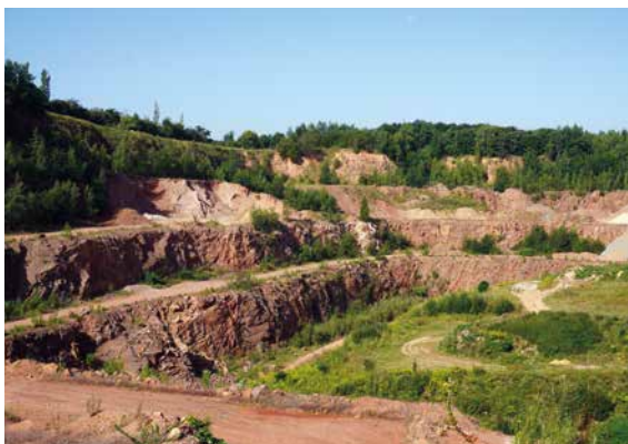
Das Natursteinwerk Mittweida stößt im Feld Mittweida I an seine Abbaugrenzen, wobei durch die südliche Abbauwand (links im Foto) über einen Tunnel der Anschluss an das Abbaufeld Roter Berg erfolgen könnte, Foto: BGR.
