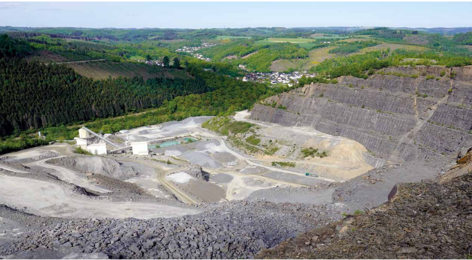
Der große Steinbruch Werdohl-Kleinhammer hat mit 180 m seine Endtiefe erreicht, Foto: BGR.
