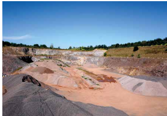
Große Halden von Baustoffgemischen im Steinbruch Wurgwitz künden von einer gerade laufenden kampagnenweisen Aufbereitung des abgebauten Andesits, Foto: BGR.
