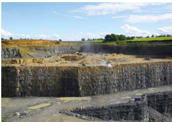
Im Steinbruch Kirchberg-Zwingelhausen wird der Kalkstein des Oberen Muschelkalk zu vielfältigen Produkten, zwei Kalksteinbänke innerhalb der Dolomitsteinschichten des Oberen Muschelkalk auch zu Trockenmauersteinen verarbeitet, Foto: BGR.
