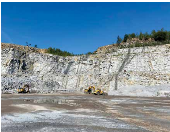
Blick in den Steinbruch Kindisch, in dem der Granodiorit von zahlreichen Basaltgängen durchschlagen wurde, Foto: ProStein GmbH & Co. KG (mit frdl. Genehmigung).
