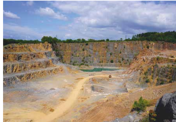
Blick in den Kalksteinbruch Sanssouci bei Balve, in dem die Verkarstungszonen (in braun) gut sichtbar sind, Foto: BGR.
