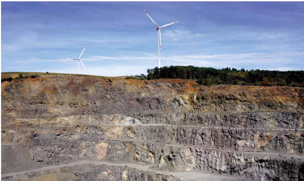
Der mit 160 m bereits sehr tiefe Diabassteinbruch Blasbach kann aufgrund Platzmangels nicht weiter vertieft werden und zeigt einen Querschnitt eines intrusiven Diabaskörpers im Lahn-Dill-Gebiet mit Linsen von Tonschiefern und Eisenerz, Foto: BGR.
