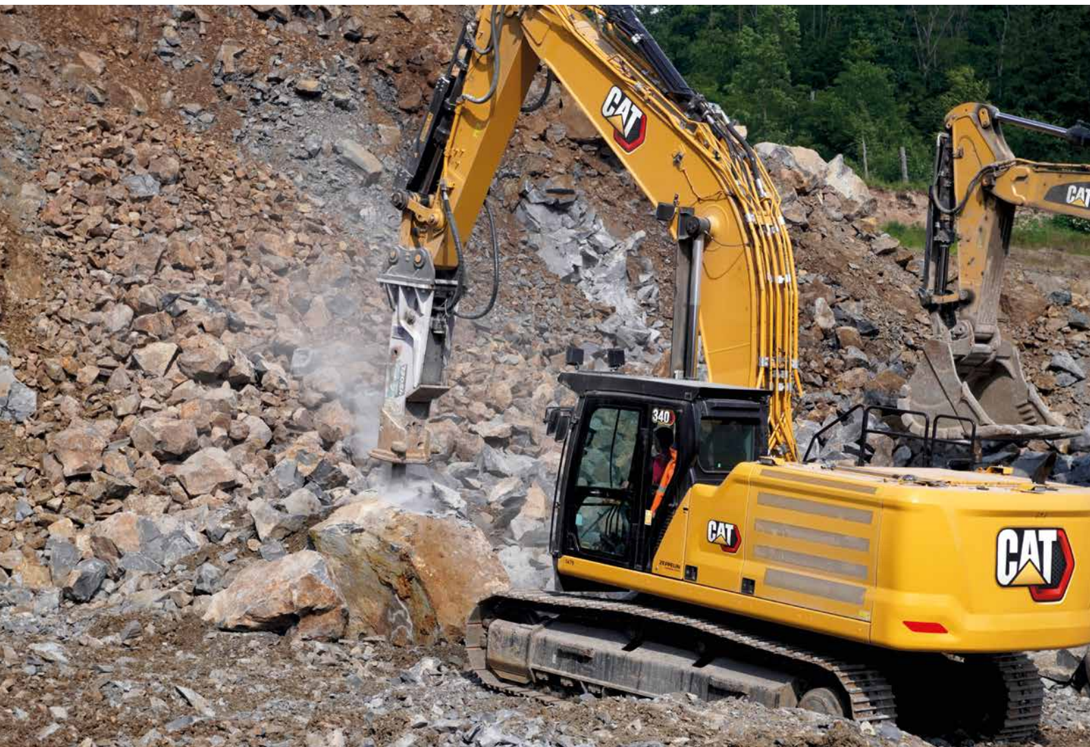
Eine weitere Methode zum Zerkleinern von Knüppeln ist das Spechten, d. h. die Zerkleinerung mit einem hydraulischen, an einen Bagger befestigten Hammer, Foto: BGR.
