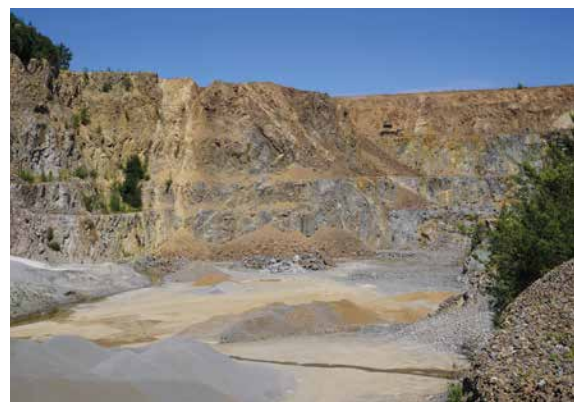
Im Steinbruch Böhmischbruck ist der zähe Gneis sichtbar, der im dortigen Schotterwerk zu einer Vielzahl von Gesteinskörnungen verarbeitet wird. Foto: BGR.
