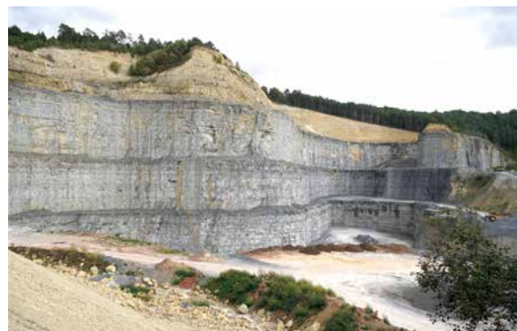
Der Steinbruch Werbach verfügt zwar noch über Gesteinsvorräte für eine Fortsetzung des Abbaus für viele Jahre, doch ist die Gewinnung des Kalksteins durch teils mächtigen Abraum behindert, Foto: BGR.
