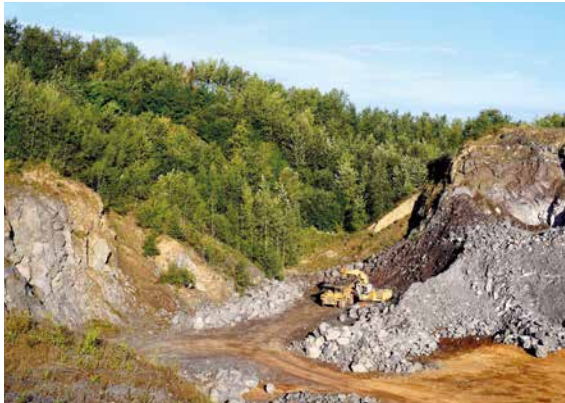
Selektiver Abbau von Basaltlava im Steinbruch Ochtendung der Dr. Clement GmbH & Co. KG, Foto: BGR.
