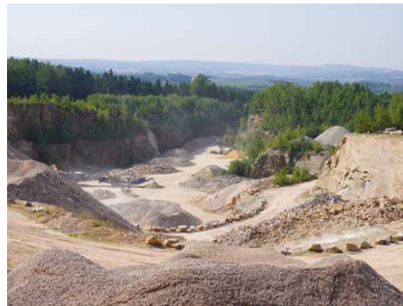
Der Granitsteinbruch bei Wildenau wurde als Hangaufschluss angelegt und liefert heute vor allem Gemische, Wasserbausteine sowie Naturbruchsteine, Foto: BGR.
