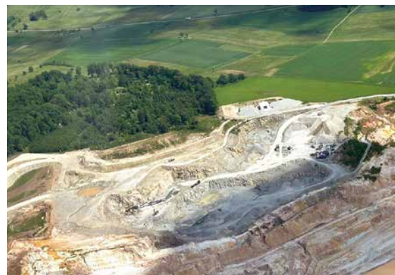
Im Nordwesten des Tontagebaus „Stemmer“ (Bildvordergrund rechts) liegt der Trachyt-Tagebau „Barbara“, in dem seit einigen Jahren Trachyt als Abraum beräumt und zur Produktion von Gesteinskörnungen genutzt wird, Foto: Blasius Schuster GmbH & Co. KG (mit frdl. Genehmigung).
