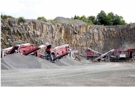
Im Basaltsteinbruch „Üdersdorf 14“ kommt eine vom Unternehmen Scherer zusammen mit Partnern speziell entwickelte, semimobile Aufbereitungsanlage zur Produktion von Edelbrechsand und Edelsplitten zum Einsatz, Foto: BGR.
