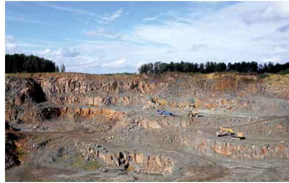
Im Steinbruch Bolsdorf der Firma Lava Stolz GmbH werden durch die Pächter jährlich zwischen 350.000 und 400.000 t Basaltlava abgebaut und zu hochwertigen Gesteinskörnungen verarbeitet, Foto: BGR.
