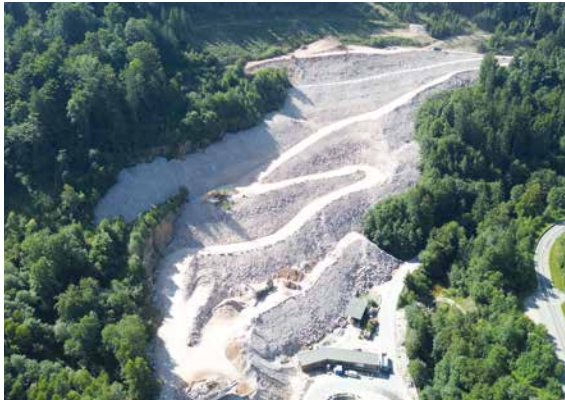
Luftbild des Murgschifferschaftbruchs in Raunünzach, in dem das Tunnelausbruchmaterial zwischengelagert wird, Foto: VSG Schwarzwald-Granit Werke GmbH & Co. KG (mit frdl. Genehmigung).
