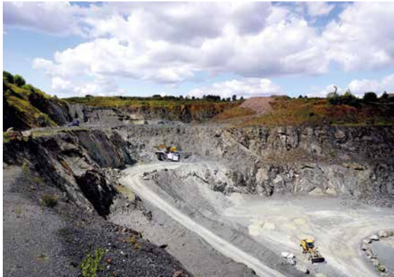
Im Steinbruch Friedrichswalde der ProStein GmbH Co. KG wird ein stark tektonisch und kontaktmetamorph überprägter extrusiver Diabas abgebaut, Foto: BGR.
