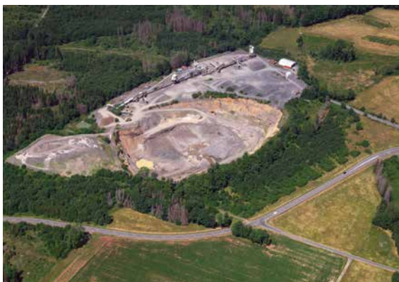
Luftbild des Basaltsteinbruchs Wetzstein im Juli 2023. Eine Erweiterung ist nicht möglich, da es sich um einen räumlich scharf begrenzten Basaltschlot handelt, Foto: Bergisch-Westerwälder Hartsteinwerke (mit frdl. Genehmigung).
