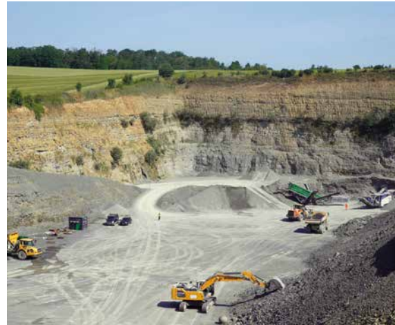
Am Standort Helmstadt wird seit einigen Jahren ein neuer Steinbruch aufgeföhren, der mit zunehmender Hanglage auch mit erhöhter Abraummächtigkeit (braune Gesteine) zu kämpfen hat, Foto: BGR.
