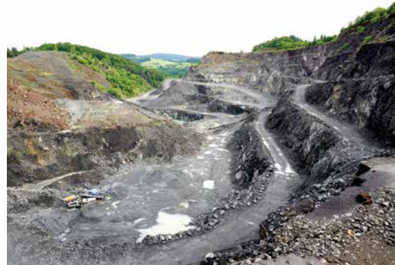
Blick in den bereits bis zu 125 m tiefen Diabassteinbruch Oberscheld mit mobiler Brech- und Siebanlage auf dem Sohlentiefsten, Foto: BGR.
