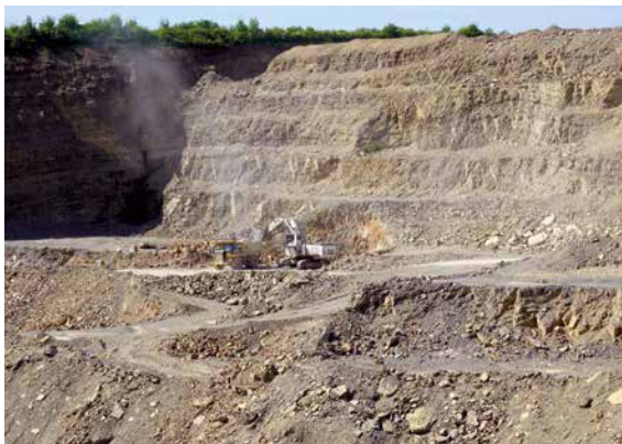
Der Kalksteinbruch in Bartrup-Sonneborn der Schiewe GmbH & Co. KG ist rund 29 ha groß, 60 m tief und liefert durchschnittlich 390.000 t Gesteinskörnungen im Jahr, Foto: BGR.
