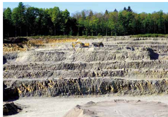
Im Kalksteinwerk Emme der Hermann Wegener GmbH & Co. KG südlich Göttingen bzw. der Autobahn A38 kann das Gestein meist direkt mittels Hydraulikbagger auf SKWs verladen werden, Foto: BGR.
