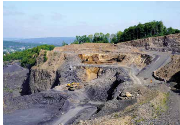
Blick in den Steinbruch SBH der MB Mineral- und Baustoff GmbH & Co. KG, den eine große Störungszone (Bildmitte in braun) mit nicht-nutzbaren Gesteinen durchzieht, Foto: BGR.
