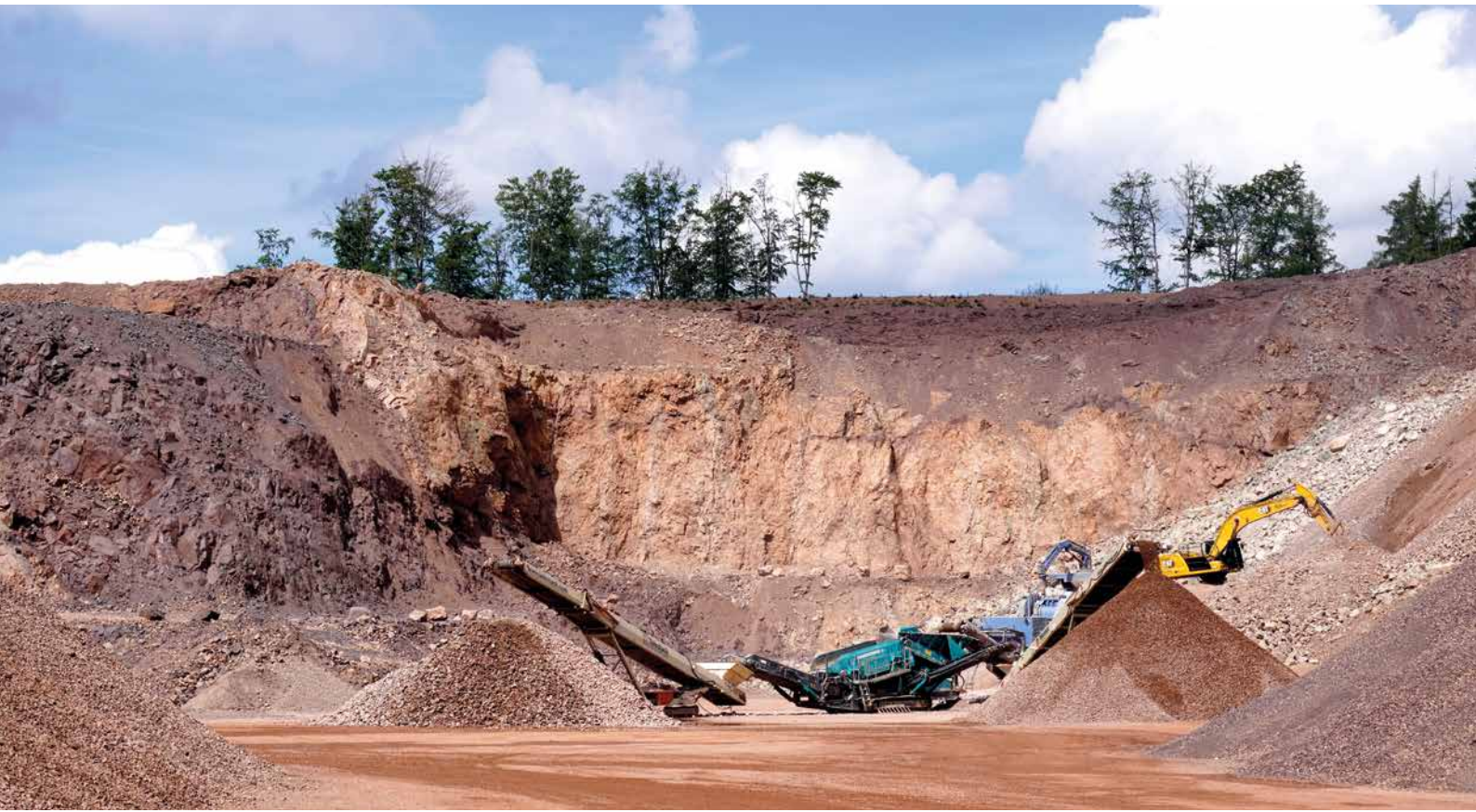
Blick in die Abbaustelle Krötenkopf des Rhyolithsteinbruchs Etterwinden, in dem die bisherige mobile Brech- und Siebanlage bald durch eine stationäre Aufbereitungsanlage ersetzt werden wird, Foto: BGR.
