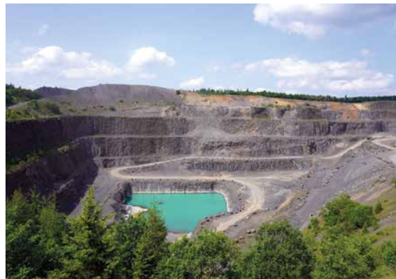
Blick in den Basaltsteinbruch Billstein. Im Hintergrund zeigen die leuchtenden Farben Einschlüsse von Tuffen und Lavaschlacken an, die auf die dortige Nähe des ehemaligen zentralen Vulkanschlots hinweisen, Foto: BGR.
