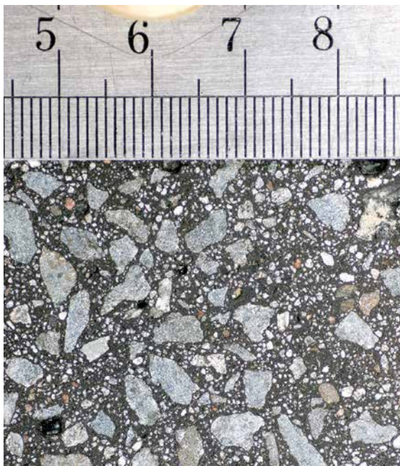
Querschnitt eines Gussasphalts mit einem Edelsplitt-Edelbrechsand-Gemisch 0/5 mm, Foto: Uwe Glaubach/Wikipedia.
