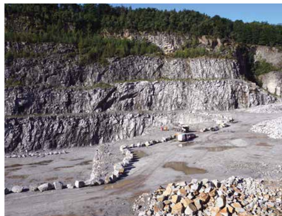
Blick in den Steinbruch Demitz-Thumitz der Hartsteinwerke Bayern-Mitteldeutschland, in dem seit weit über 150 Jahren ein mittelkörniger Granodiorit abgebaut wird, Foto: BGR.
