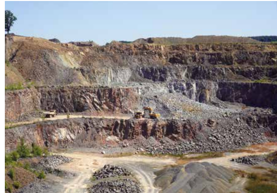
Verladung des bei der letzten Sprengung im Steinbruch Breitenau gelösten Haufwerks auf SKWs, Foto: BGR.
