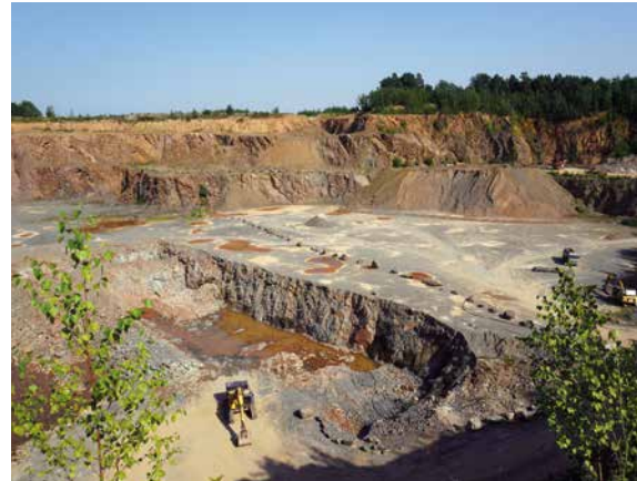
Im „Andalusit-Glimmer-Fels“-Steinbruch Schelmburg lagert das nutzbare Gestein unter einer bis zu 18 m mächtigen, kaum nutzbaren Verwitterungsschicht, Foto: BGR.
