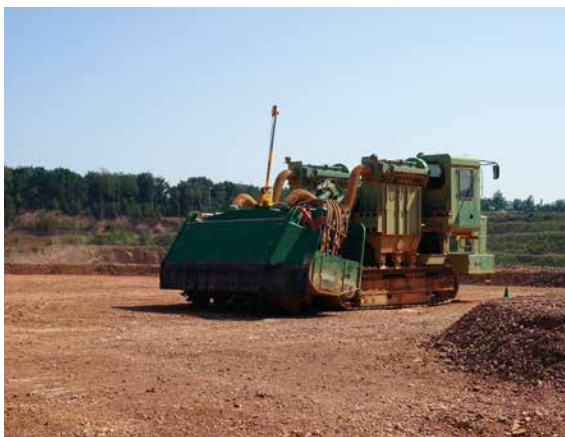
Im Quarzporphyrtuffstein-Bruch Leukersdorf kommt einmalig in Deutschland auch eine Gesteinsfräse zum Abbau des Gesteins zum Einsatz, Foto: BGR.
