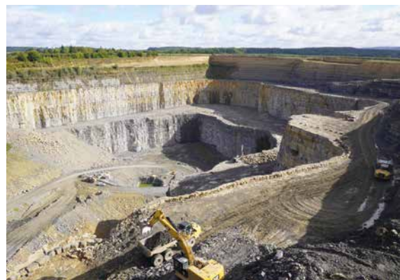
Auch im bis zu 100 m tiefen Steinbruch Mundelsheim wird nicht nur der Kalkstein, sondern auch der darüber lagernde Schilfsandstein weitestgehend genutzt, Foto: BGR.
