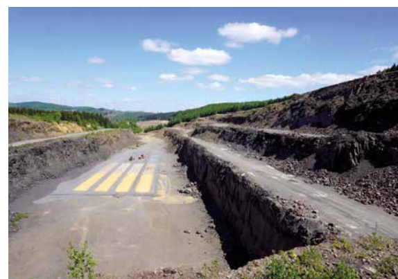
Im Abbaufeld Hillerberg der Steinwerk Raumland Böhl GmbH in Bad Berleburg wird auf der tiefsten Sohle die Wasserdurchlässigkeit von Asphaltdecken getestet, Foto: BGR.
