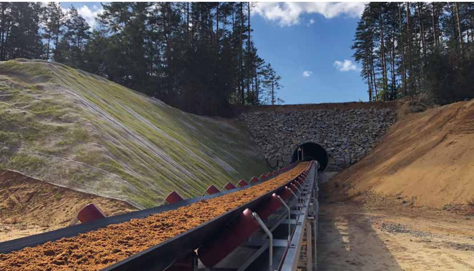
darunter dem längsten Band mit einem Achsabstand von 2.250 Metern, ermöglicht den nahezu geräuschlosen und CO<sub>2</sub>-armen Transport von Kies über eine Distanz von mehr als drei Kilometern in die Aufbereitungsanlage. Die innovative Lösung reduziert nicht nur die Lärmemissionen, sondern minimiert auch den CO<sub>2</sub>-Ausstoß erheblich.
