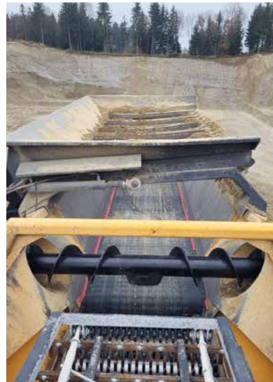
600.000 m 3 aus lehmhaltigen Jungeszeit-Moränenwällen-Überdeckungen werden mit einem Sternsieb aufbereitet.
