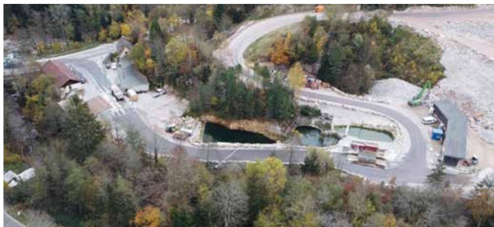
**Um den Materialstrom von bis zu 4.500 t am Tag annehmen zu können, mussten große Umbauarbeiten in dem doch kleinen Steinbruch durchgeführt werden.**
