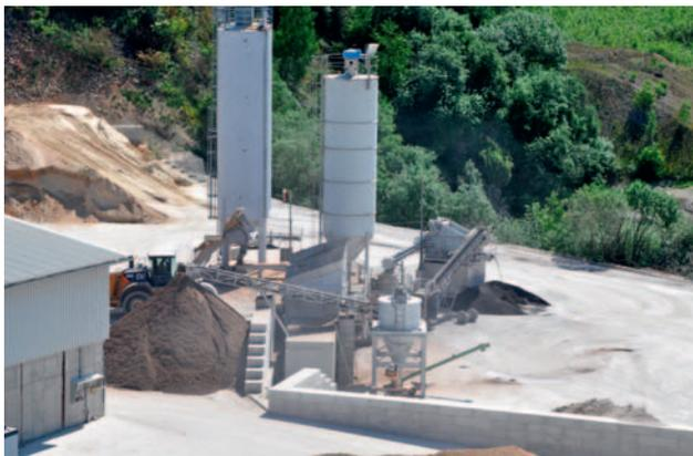
**Mit einer selbst konzipierten Aufbereitungs- und Mischanlage bereitet Trollius Brennraumasche auf, die ansonsten deponiert werden müsste.**
