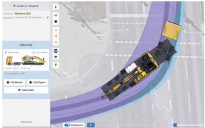
**ERLEICHTERUNG:** Heavy-Goods berechnet Achslasten, Biegemomente, Kippstabilität, Überlastgrenzen, Ladungssicherung und Schleppkurven.
