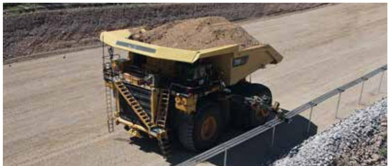
**NUR JAHRZEHNTE SPÄTER** wird an Technologien der Zukunft getüftelt, wie dem Dynamic Energy Transfer System (DET). Es greift auf ein elektrifiziertes Schienensystem zurück, das an die Fahrwege angepasst werden kann und Energie sowohl an diesel- als auch an batterieelektrische Großmuldenkipper überträgt. Fotos: Caterpillar
