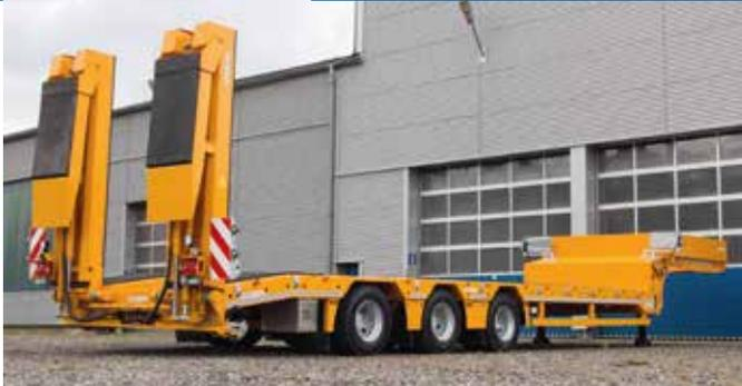
**NEUE LEISTUNGSKLASSE:** Das besondere ST-Rahmenkonzept verknüpft einen zentralen Kastenrahmen im Tiefbett mit den außen liegenden Rahmenträgern im Hochbett. Fotos: Zandt cargo
