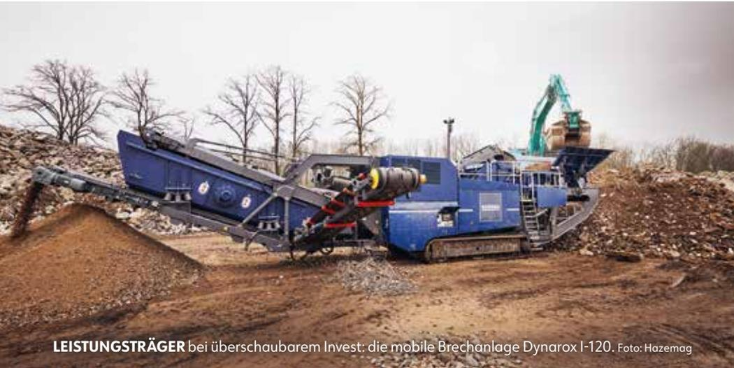
LEISTUNGSTRÄGER bei überschaubarem Invest: die mobile Brechanlage Dynarox I-120. Foto: Hazemag
