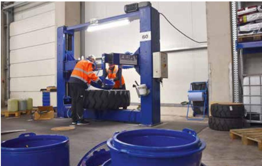
**MANUFATURARBEIT:** Für mehrteilige Felgen-Reifen-Kombinationen wurden eigene Anlagen entwickelt. Hydraulische Greifer und Werkzeuge erleichtern die Montage.
