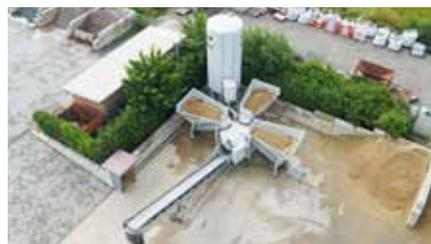
**IN DER FLIEGL BTS** können dank ihrer sternförmigen Bauweise bis zu vier verschiedene Materialien gleichzeitig gelagert werden. Foto: Fliegl Baukom
