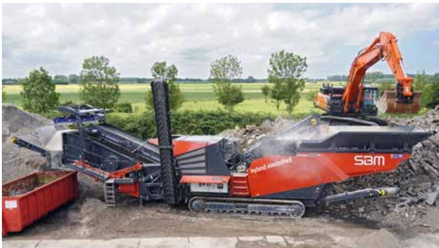
**MIT EINDECK-ANBAUSIEB UND DOPPELTER MAGNETAUSRÜSTUNG** ist der Großbrecher Remax 600 in München zu sehen. Foto: SBM Mineral Processing
