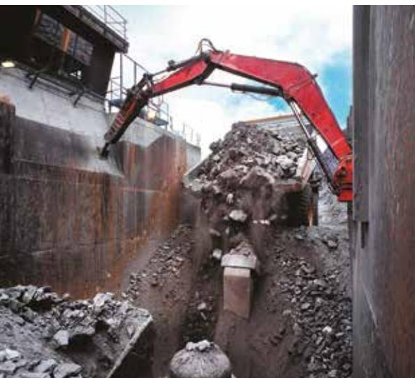
**WARTUNGSINTERVALL VERDOPPELT:** Die Auskleidung eines Brechereinlasses mit Hardox-500-Verschleißblech macht es möglich. Fotos: SSAB
