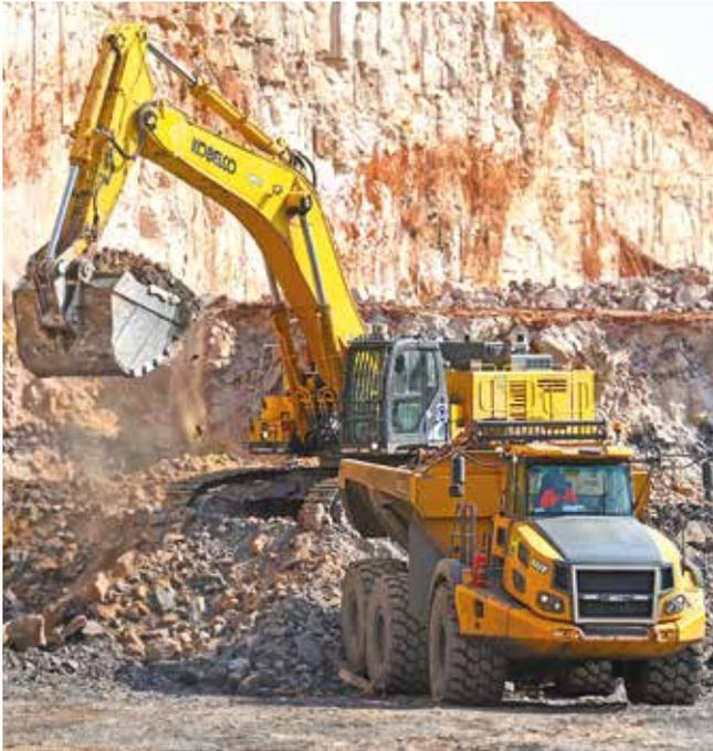
**IM STEINBRUCH** harmoniert die 27,5-m<sup>3</sup>-Mulde des Bell B50E auch mit gängigen Ladegeräten. Foto: Bell Equipment
