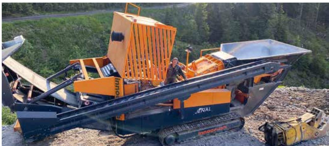
**DIE ZUSÄTZLICH HOCHKLAPPBARE MOTORHAUBE** der Innocrush-Anlage gewährt eine gute Zugänglichkeit zu allen Komponenten.
