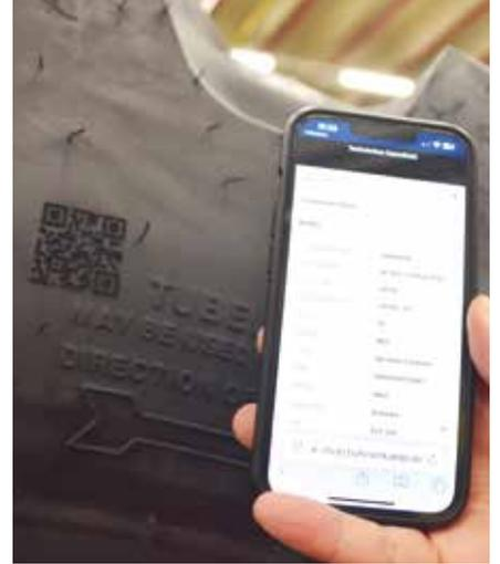
**DIGITAL EXTRA:** Dank des per Laser eingebrannten QR-Codes und einer App lassen sich die Basisdaten zum Produkt stets nachvollziehen.
