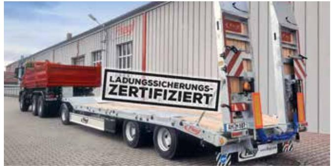
**DREI-ACHS-TIEFLADEANHÄNGER** DTS 300 mit einer technischen Nutzlast von 30 t, Seitenverbreiterung und Ladungssicherungs-Zertifizierung. Foto: Fliegl Trailer
