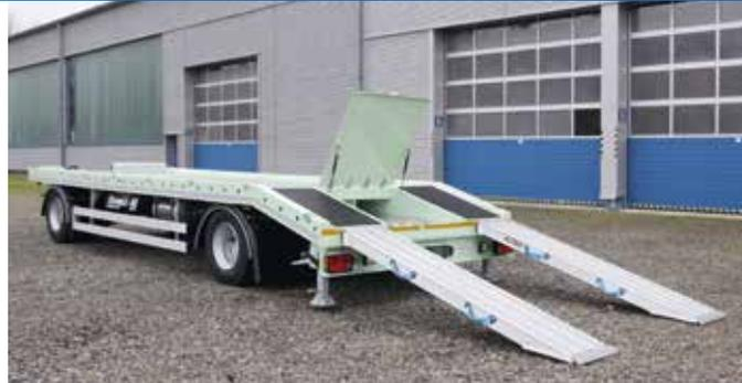
**MESSEPREMIERE** feiert die Baureihe AP-BTA. Das flexible Baukonzept mit Alurampen, pneumatischen Klemmen und abgestimmtem Zurrkonzept lässt vielfältige Transportmöglichkeiten zu.
