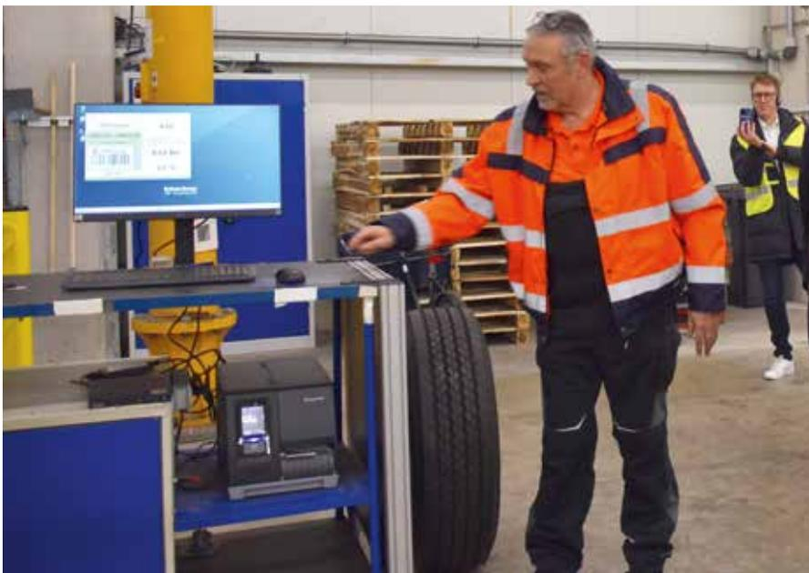
**KONTROLLE:** Über einen speziellen Tisch erfolgt von der Seite die Funktionsprüfung jedes kundenspezifischen RDKS.
