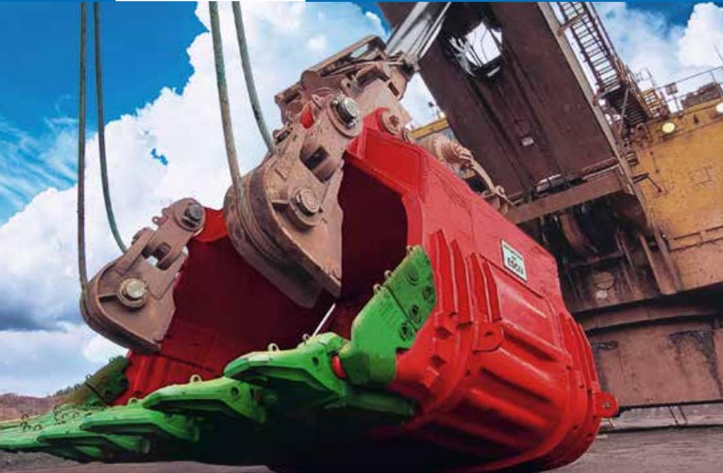
**ZEITGEMÄSS UND LEISTUNGSSTARK:** Nexsys-Bergbaulippensystem für Seilschaufeln. Foto+Grafiken: Esco Weir
