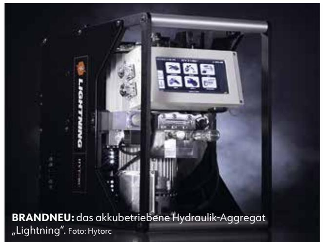
**BRANDNEU:** das akkubetriebene Hydraulik-Aggregat „Lightning“. Foto: Hytorc
