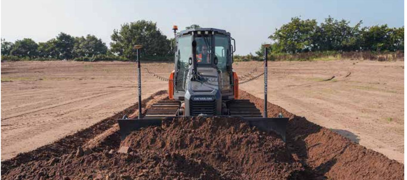
**NEUE FUNKTION FÜR TIEFEN BODEN:** Die Develon-Raupen können jetzt mit GPS-Technik einfacher und präziser fahren. Foto: Leica
