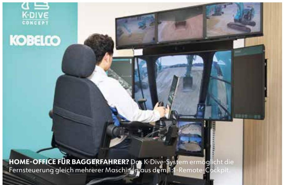
**HOME-OFFICE FÜR BAGGERFAHRER?** Das K-Dive-System ermöglicht die Fernsteuerung gleich mehrerer Maschinen aus dem 1:1-Remote-Cockpit.
