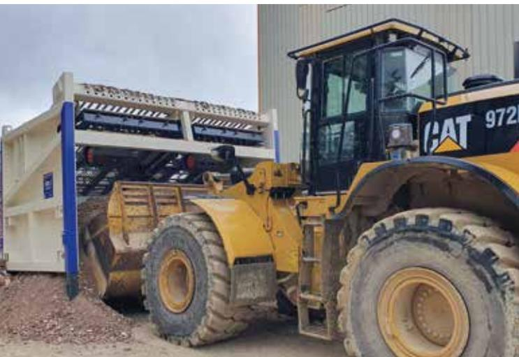
**MARKTEINFÜHRUNG:** Das Baustoff-Recyclingsieb SBR5 wird offiziell vorgestellt. Es kann mit großen Radladern perfekt beschickt werden. Foto: EAG
