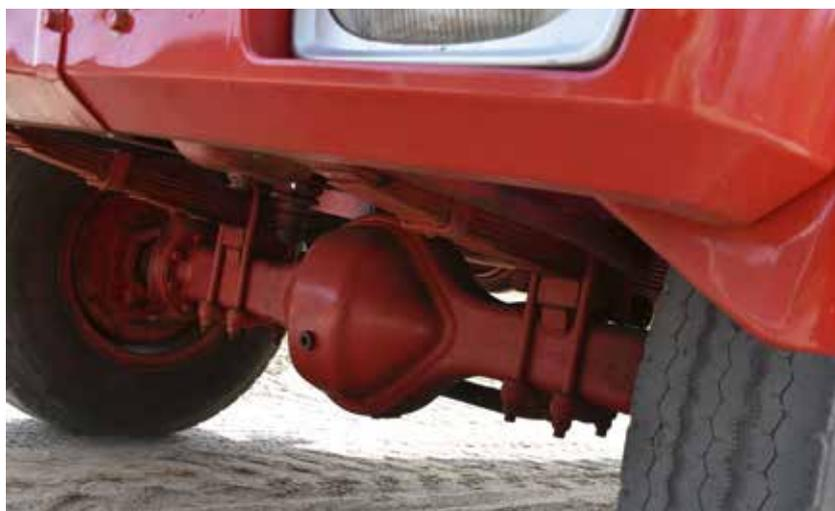
**GUT AUSGERÜSTET:** Für unwegsames Gelände abseits befestigter Wege war der Magirus mit Allradantrieb bestens ausgestattet. Ein Wettbewerbsvorteil für die Baufahrzeuge waren die zuverlässigen Allradantriebe von Magirus-Deutz.
