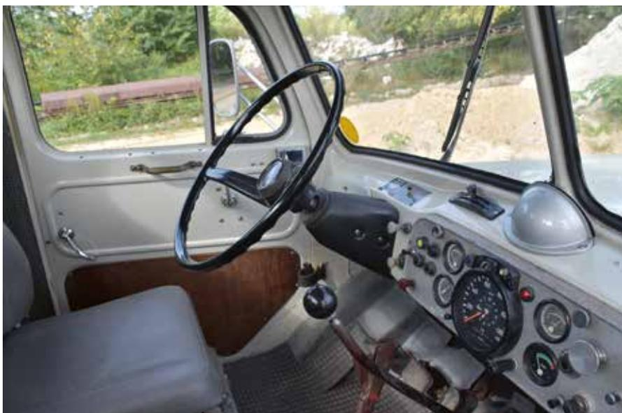
**ERSTE ANZEICHEN:** Das sogenannte Topflenkrad nahm bei den späten Modellen der zweiten Generation bereits den Generationswechsel vorweg. Es ersetzte die weißen Drei-Speichen-Lenkräder.
