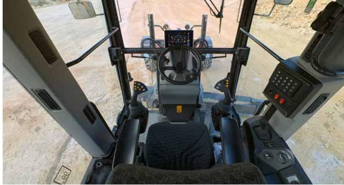
**KOMFORT AN BORD:** Daran haben die gute Sicht, eine elektrohydraulische Joystick-Steuerung sowie ein geräumiges Staufach ihren Anteil.
