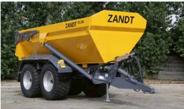
**WEITER OPTIMIERT:** Die Muldenform mit gerader Stirnkante verbessert die seitliche Sicht von der Maschinenkabine auf die Mulde. Foto: Zandt cargo
