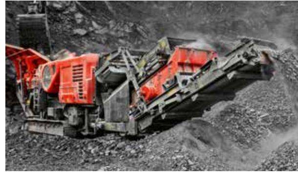
**IN EINER MASCHINE VEREINT** der J-1170AS+ die Flexibilität einer Backenbrecher- und Siebanlage.
