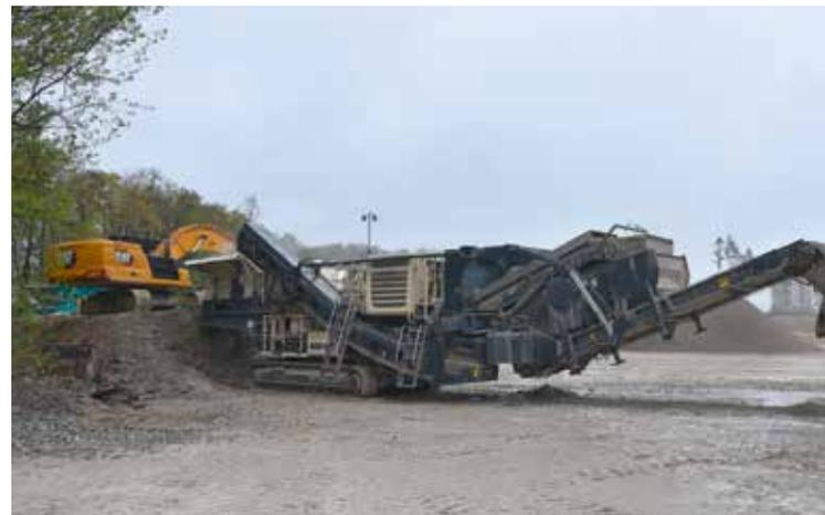
**KOMPLETTE TECHNIK:** Der raupenmobile Metso-Prallbrecher bedient mit Siebkasten und Rückführband eine vollständige Aufbereitungsstufe.
