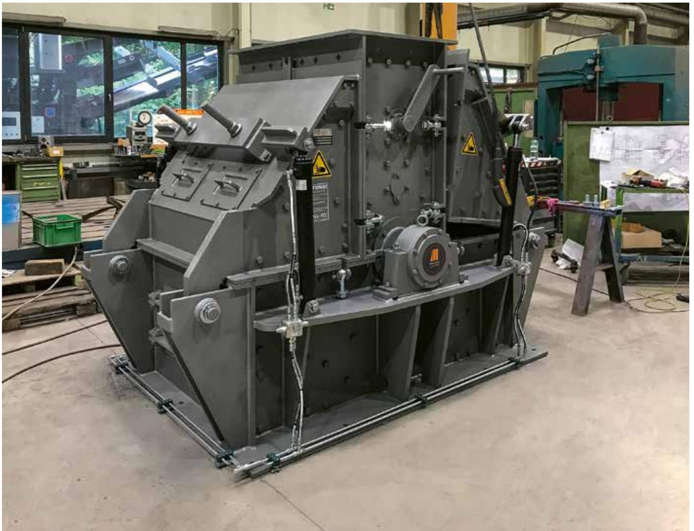
**SORGFÄLTIGE MASSKONFEKTION:** Die Hammermühlen für den stationären Steinbrucheinsatz entstehen bei Prall-Tec in Lengerich als individueller Maschinenbau. Fotos: Prall-Tec
