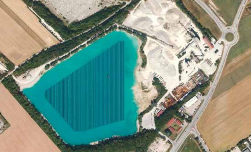
**GEDANKENSPIEL:** So soll es einmal aussehen, wenn 2500 in West-Ost-Ausrichtung installierte „Floating-Skipp“-Module auf dem Kies-See Gilching solaren Strom produzieren. Grafiken: Sinn Power
