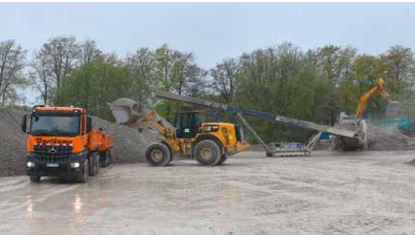
**GERINGER AUFWAND DANK MOBILITÄT:** Ohne Siloanlagen werden die Lkw direkt von der Halde mittels Radlader bedient.
