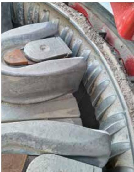
**DIE ALTERNIERENDE DREHRICHTUNG** der Rotorprallmühle bewirkt eine gleichmäßige Abnutzung aller Verschleißteile und reduziert somit den Wartungsaufwand der Anlage.
