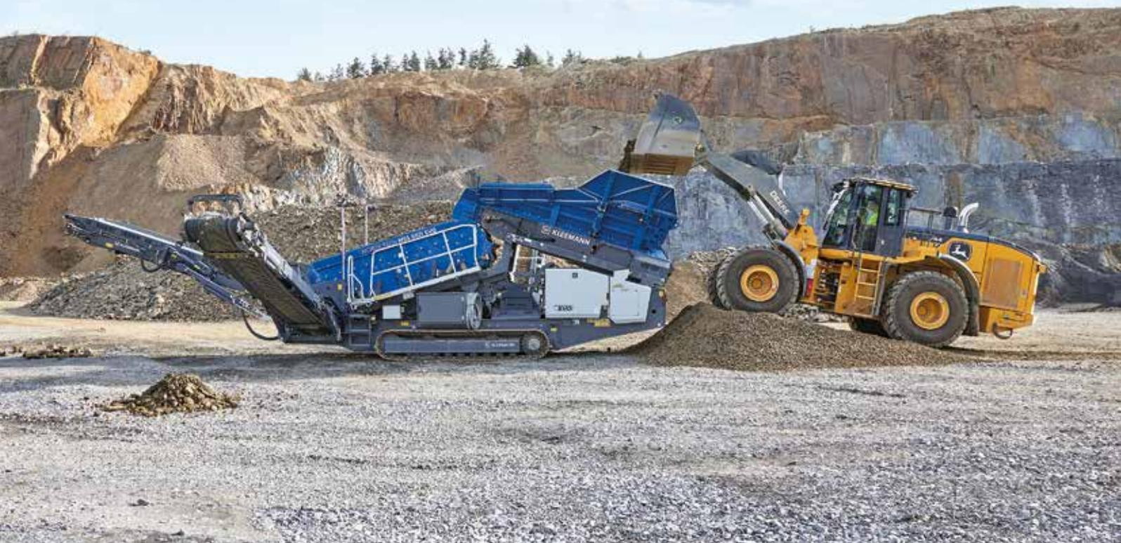
**BIS ZU 350 T/H** Aufgabelleistung stemmt Kleemanns neue mobile Grobstücksiebzanlage Mobiscreen MSS 502(i) Evo. Foto: Wirtgen Group
