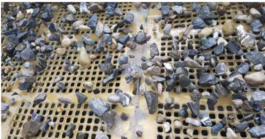
**FÜR SCHWERSTE MEDIEN ENTWICKELT:** Plansieb mit Flachstahlunterbau.
