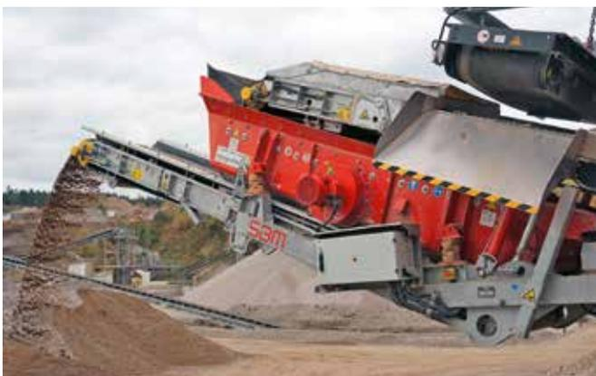
**DAS OPTIONALE EIN-DECK-NACHSIEB** (1300 x 3700 mm) des Remax 400 ist als Kreisschwingersieb mit elektrischem Doppelantrieb ausgelegt und bietet ein großes Haldenvolumen bis zu 160 t.
