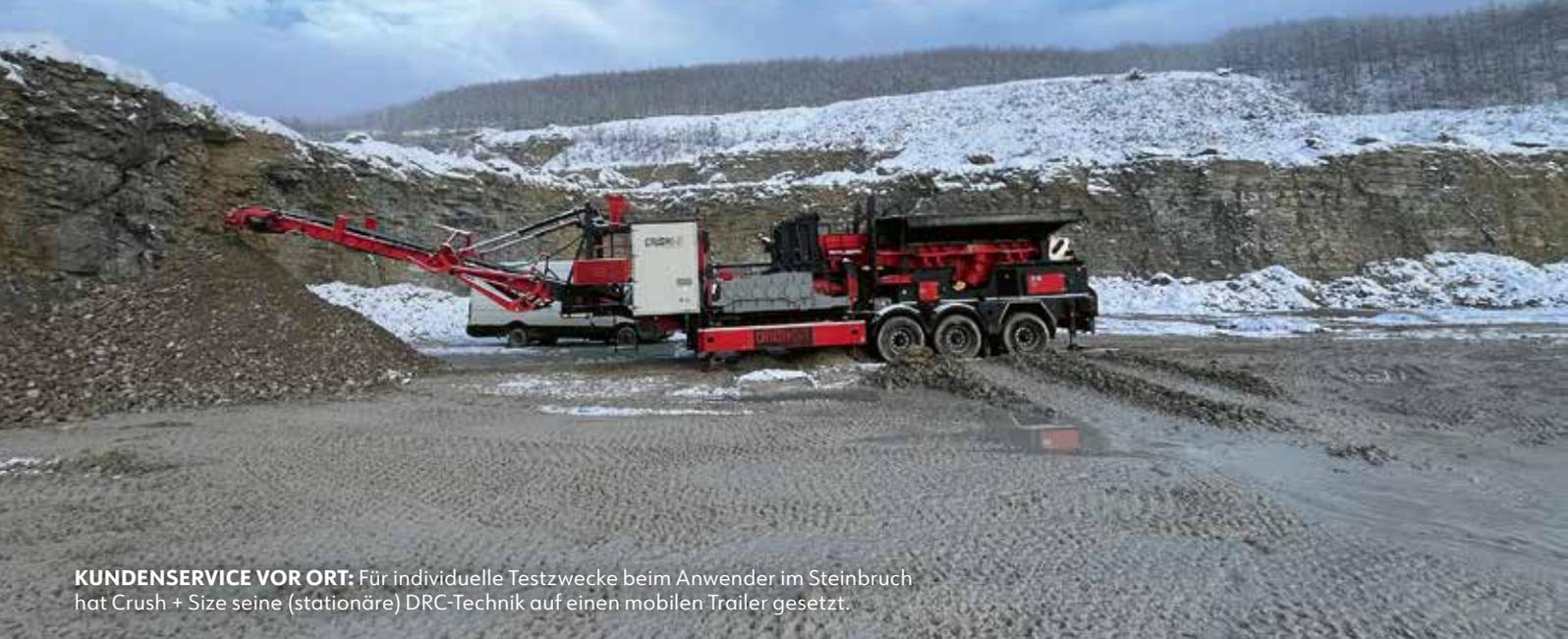
**KUNDENSERVICE VOR ORT:** Für individuelle Testzwecke beim Anwender im Steinbruch hat Crush + Size seine (stationäre) DRC-Technik auf einen mobilen Trailer gesetzt.
