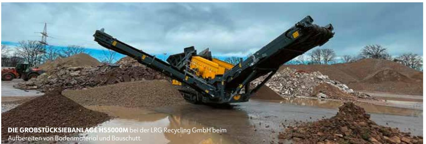
**DIE GROBSTÜCKSIEBANLAGE HS5000M** bei der LRG Recycling GmbH beim Aufbereiten von Bodenmaterial und Bauschutt.
