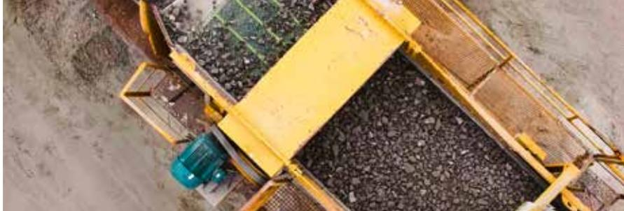
**AKTIV VIBRIERENDE SIEBE** wie Flex-Mat bieten eine effiziente Lösung, um Verblindung, Steckkorn und Verstopfung zu verhindern. Foto: Major Wire
