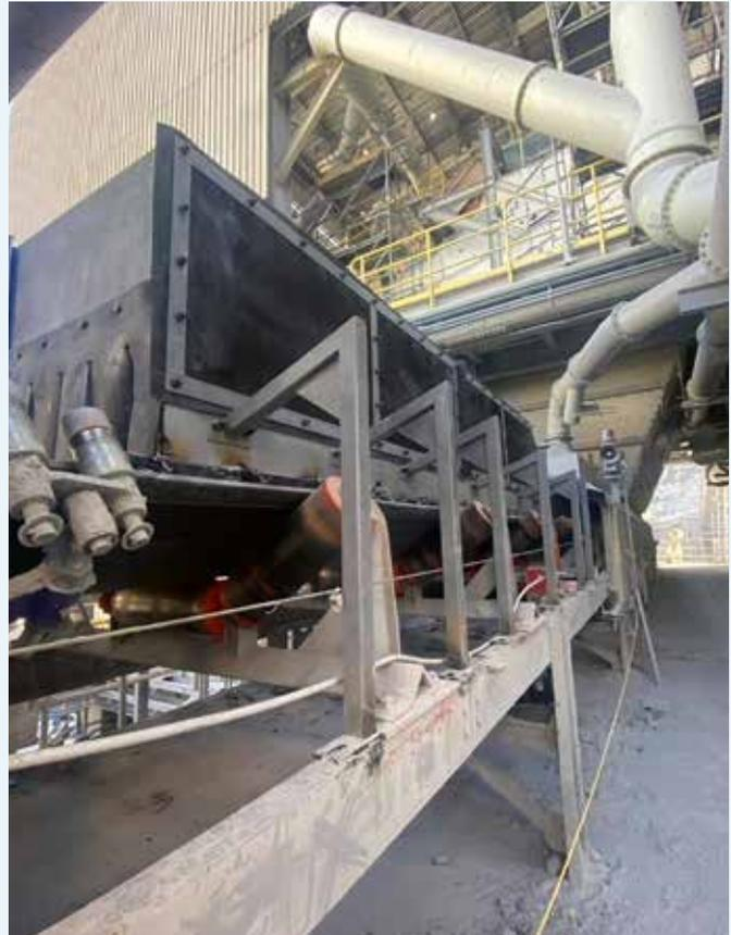
**DURCH EIN FILTERTUCH** gesteuert tritt staubige Luft dank Dustscrape aus – saubere Luft tritt heraus, das Material bleibt im System. Foto: Scrapetec
