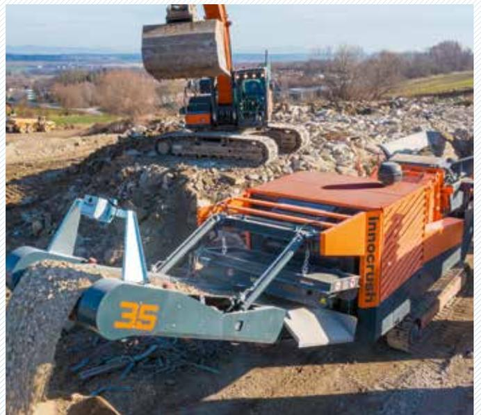
**VOR ALLEM FÜR DAS BAUSCHUTTRECYCLING** wird der Hochleistungsprallbrecher Innocrush ic35 eingesetzt. Foto: Innocrush
