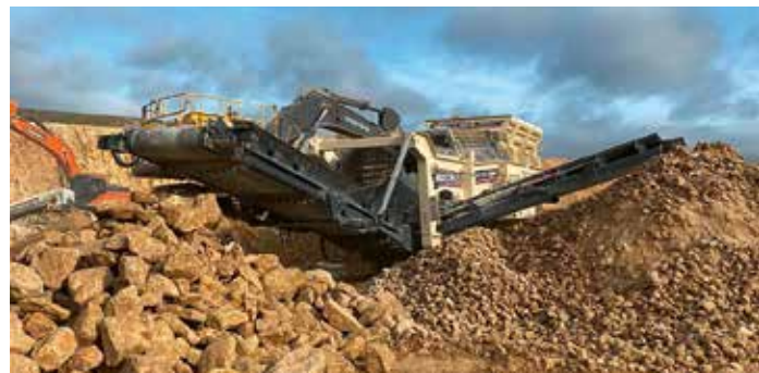
RAUPENMOBILE SIEBTROMMEL: Die MDS M515 reinigt Felsblöcke mit bis zu 800 mm Kantenlänge. Foto: Kölsch
