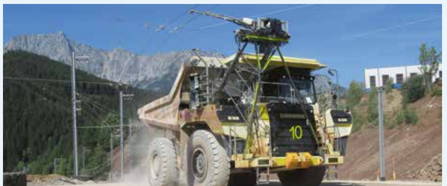
WEIT VORNE: Im österreichischen Erzbergabbau verfolgt der Betreiber mit der Oberleitungselektrifizierung einen zukunftsweisenden Ansatz.
