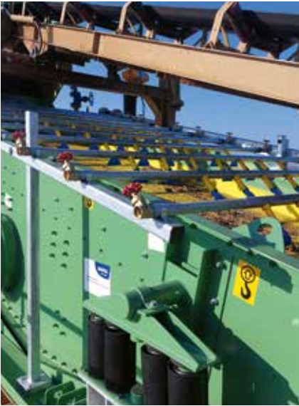
... WEIT GEFEHLT! Mit zwei neuen Siebeinheiten und einer Schwertwäsche ist das Kieswerk Tollwitz wieder zukunftsfit.
