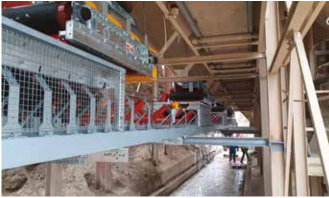
PLATZ GENUTZT: Wo früher die Silodurchfahrt für Lkw war, verläuft jetzt das Abzugs- und Sammelband.
