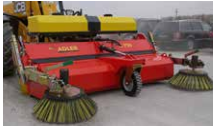
HYDRAULISCH angetrieben und mit 3D-Niveaueingleich ausgestattet: die Kehrmaschine K 750. Fotos: Adler Arbeitsmaschinen
