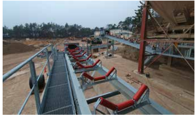
INTELLIGENT: Über mehrere parallel verlaufende Bandstraßen werden die Aufgabebunker mit der Siloanlage verbunden.
