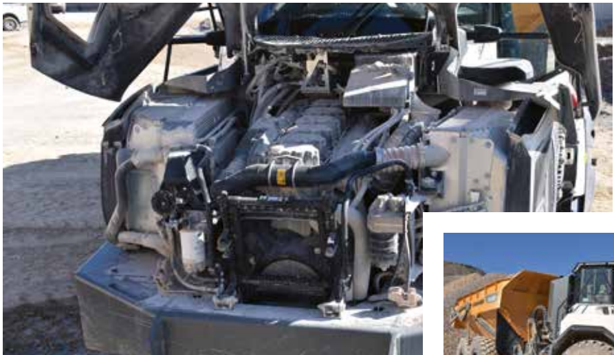
KOMPAKT UNTERGEBRACHT: Der neu konstruierte Motorraum hat ein geneigtes Aggregat. Der kurze, nach vorne abfallende Vorbau war so realisierbar. Dies und die großzügig verglaste Kabine prägen das moderne Design.
