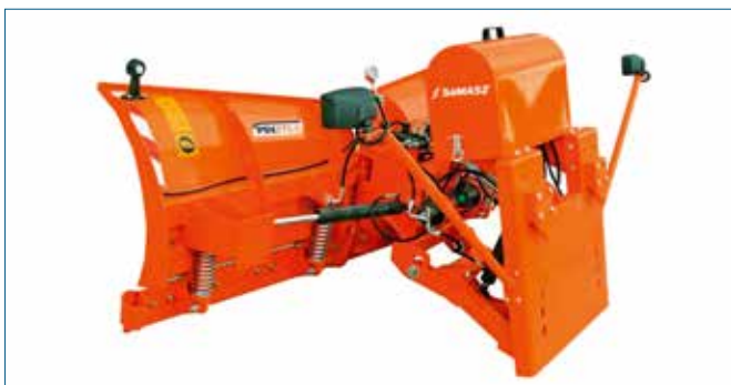
SUPER AM SERVICEGERÄT: Für Radlader bis 6 t ist der einscharige Saphir-Schneepflug PSV vorgesehen. Foto: Baumashop24
