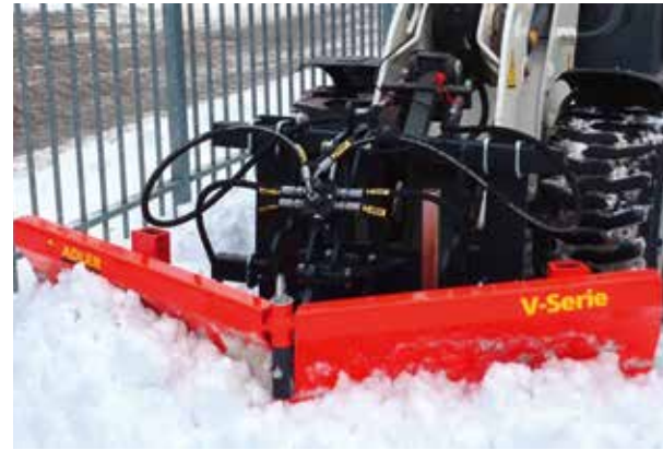
VARIABLE schwenkbar und mit bis 3 m Räumbreite: das Schneeräumschild der V-Serie.
