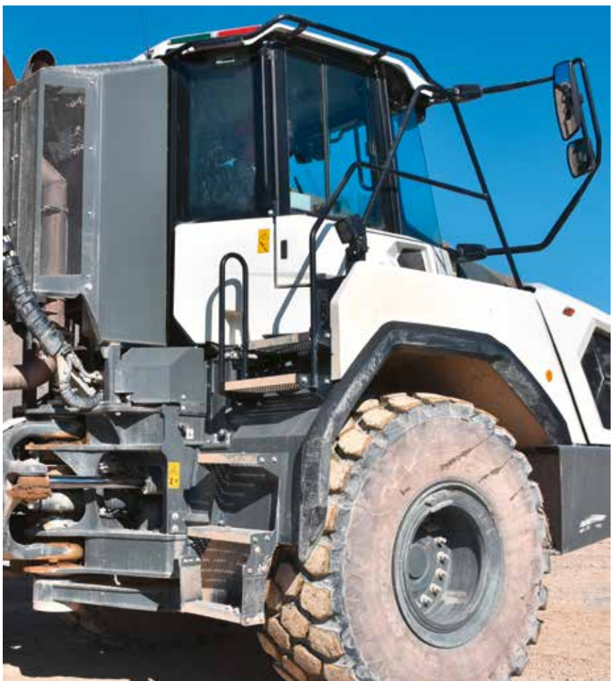
KOMPAKT UNTERGEBRACHT: Der neu konstruierte Motorraum hat ein geneigtes Aggregat. Der kurze, nach vorne abfallende Vorbau war so realisierbar. Dies und die großzügig verglaste Kabine prägen das moderne Design.
