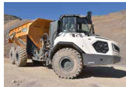
KOMPAKT UNTERGEBRACHT: Der neu konstruierte Motorraum hat ein geneigtes Aggregat. Der kurze, nach vorne abfallende Vorbau war so realisierbar. Dies und die großzügig verglaste Kabine prägen das moderne Design.
