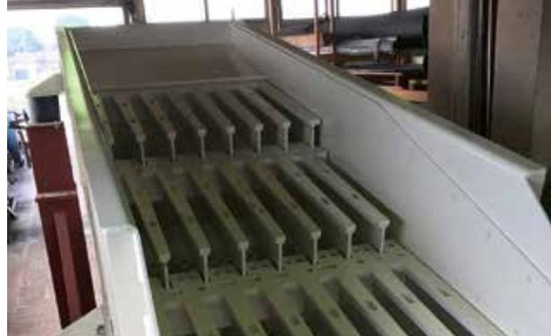
**HART IM NEHMEN:** Stabrostsiebmaschinen zur Vorabsiebung grober Gesteinsanteile müssen sich in rauen Steinbruchumgebungen bewähren. Passend konfektioniert verkraften sie Aufgabegrößen bis zu 1500 mm Kantenlänge. Fotos: Dosiertechnik
