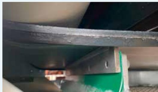
Über den **Abwurfkasten** des Dosierbandes wird auch abgestreiftes Material entsorgt. In besonderen Applikationen wurde Restmaterial nicht vollständig abgestreift und fiel neben das Dosierband. Aus diesem Grund wurde der Abwurfkasten neu konstruiert. In Kombination mit dem neuen Abstreifer ist nunmehr sichergestellt, dass Restmaterial zuverlässig in den Abwurfkasten befördert wird und nicht mehr neben das Dosierband fällt.
