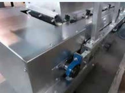
Bei Dosierbändern mit **Schutzeinhausung** an der Umlenktrummel war bisher das Nachschmieren der Lagerstellen ohne Demontage der kompletten Einhausung nicht möglich. Um dies künftig zu vermeiden, wurde das Design überarbeitet und eine neue Schutzeinhausung konstruiert, welche die Stehlager von außen für eine beliebige Nachschmierung frei zugänglich macht und lässt.
