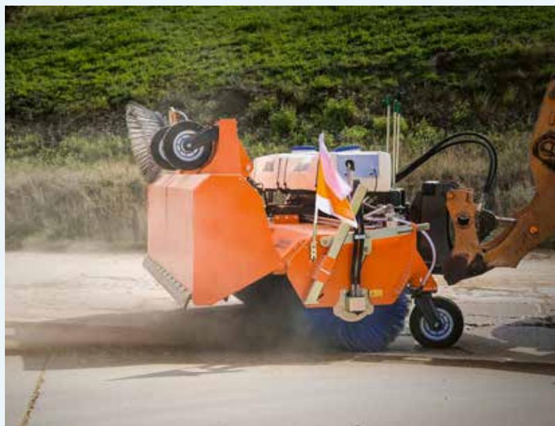
**UNEBCNER UNTERGRUND?** Kein Problem für den Profi Gigant 920 mit 3D-Niveaueausgleich. Das Modell eignet sich zum Anbau an Radlader. Die Wahl zwischen schmutzaufnehmendem und frei kehrendem Einsatz ist ohne Demontage des Sammelbehälters flexibel möglich. Fotos: Tuchel
