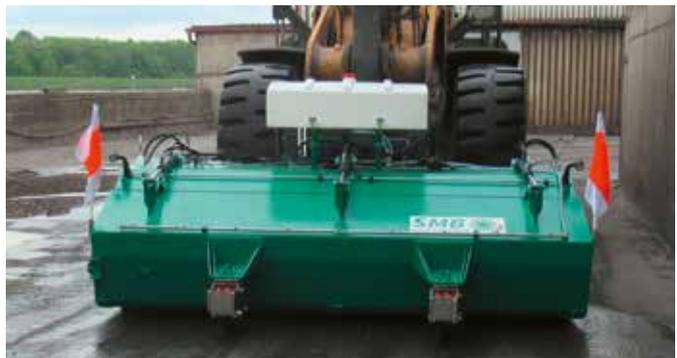
**EXTREME VERSCHMUTZUNGEN** beseitigt die Anbaukehrmaschine BKM Maxi kraftvoll. Dazu kann der Besenaufgedruck feinstufig angepasst werden. Speziell besetzte Premium-Bürstenelemente gewährleisten eine effektive Kehrarbeit bei hoher Standzeit. Fotos: Sobernheimer
