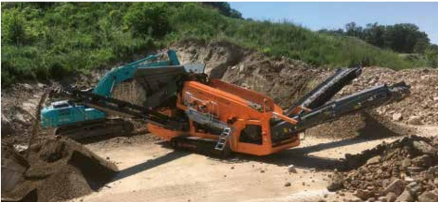
Separiieren von Bauschutt mit der mobilen Grobsiebanlage RSS514
