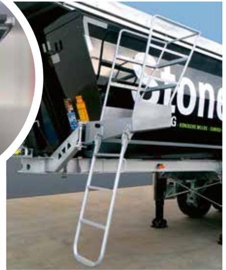
**SICHERUNG UND FESTER STAND:** Ein schwenk- und klappbares Podest ist bei allen Sattelkippern beidseitig montierbar. Davon und vom Fliptop-Schiebeverdeck profitiert nicht nur der Steinmeister. Nachrüstungen sind laut Hersteller möglich.
