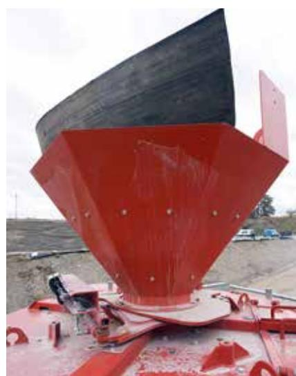
**DIE FÜLLSTANDSREGELUNG AM ÜBERGABETRICHTER** des SBM V8 sorgt für ein ausreichendes Materialpolster und für die korrekte Funktion der patentierten SBM-Einlaufregelung.
