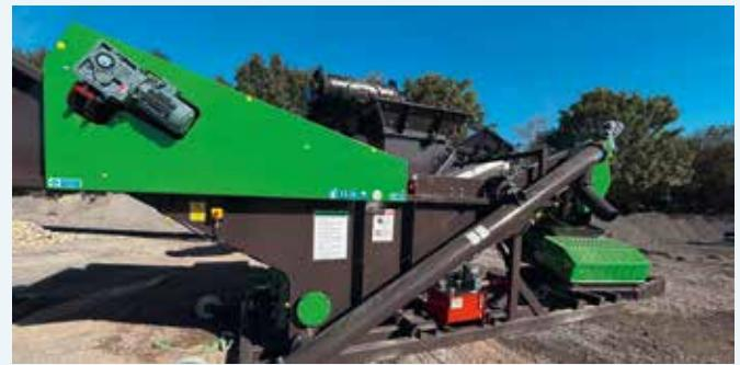
**EFFIZIENTE TRENNUNG** von Leicht- und Schwerstoffen: Der Hako WS 1400 separiert Materialien wie Holz und Styropor von Stein und Beton.
