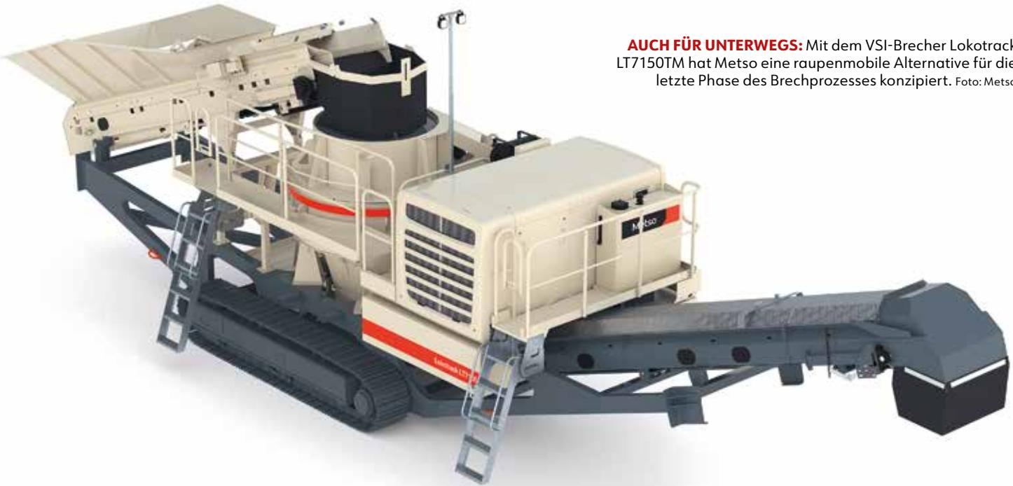
**AUCH FÜR UNTERWEGS:** Mit dem VSI-Brecher Lokotrack LT7150TM hat Metso eine raupenmobile Alternative für die letzte Phase des Brechprozesses konzipiert. Foto: Metso
