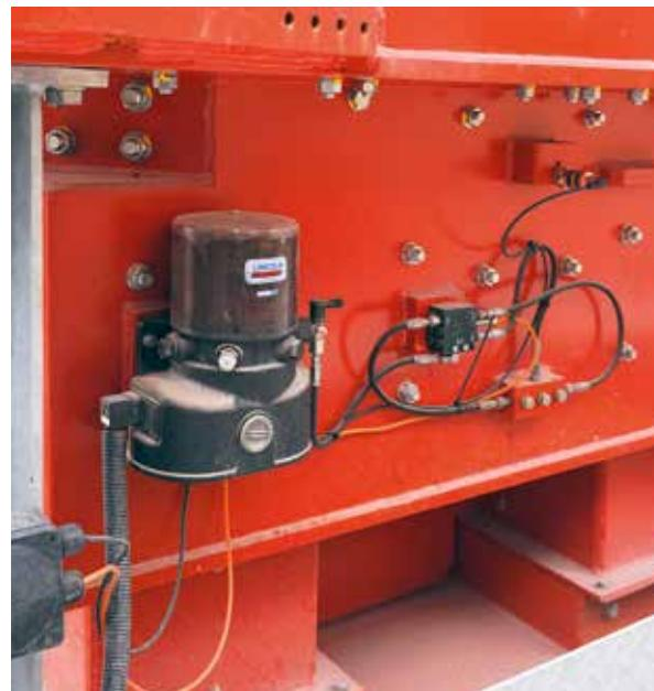
**EIN AUTOMATISCHES SCHMIERSYSTEM** minimiert die Wartungsarbeiten am SBM-Vertikalprallbrecher V8.
