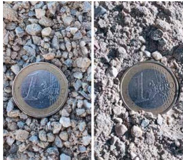
**DIE ENDPRODUKTE** bei Moosleitner zeichnen sich durch eine hervorragende Kornform und eine gute Sieblinie aus. Links zu sehen: Splitt 5/8 mm; rechts: Brechsand 0/4 mm.
