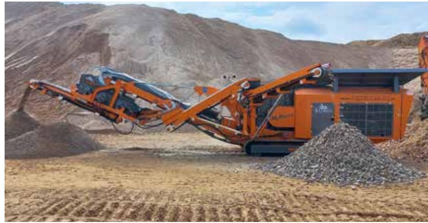
**ZWEI ENDFRAKTIONEN** werden in einem Durchgang erzeugt.
