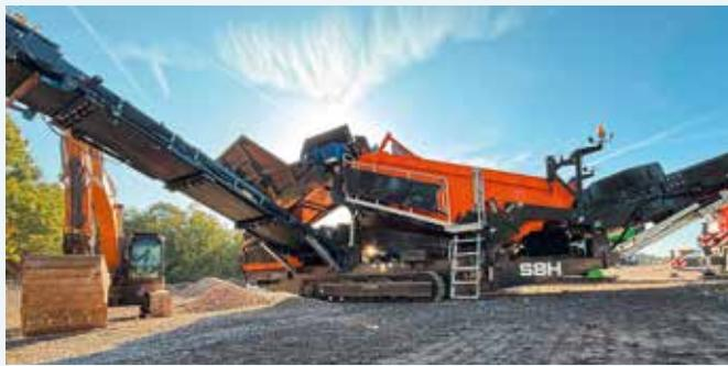
**DIE ENERGIEEFFIZIENTE GROBSTÜCKSIEBMASCHINE** lässt sich mit ihrem hybriden Antrieb autark auf Baustellen einsetzen.
