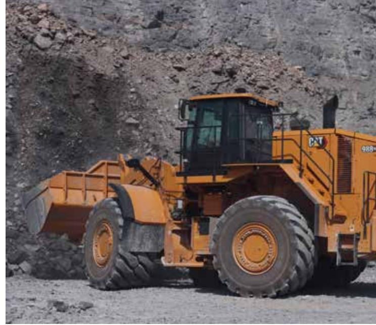
**ERLEICHTERTE ROHSTOFFAUFNAHME:** Dafür sorgt die von Resch-Ka-Tec gefertigte 6,9-m<sup>3</sup>-Trapez-Schaufel mit Sägezähnen.
