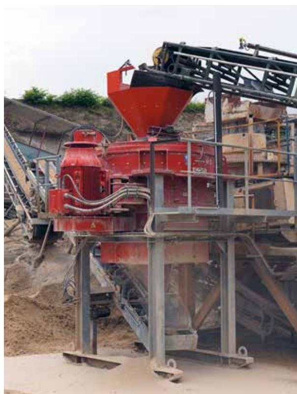
**ALS LEICHT VERSETZTE EINHEIT** ließ sich der Vertikalprallbrecher SBM V8 einfach in die bestehende Brechstation integrieren.
