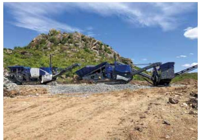
Das Kleemann-Trio besteht aus einem Backenbrecher, einem Kegelbrecher und einer Klassiersiebanlage. Von Europa aus traten die Maschinen ihre lange Fahrt per Schiff in die Stadt Dar-es-Salaam an. Nach der Zollabfertigung ging es weiter – auf Tiefladern, per Zug und schließlich über eine 10 km lange, nicht asphaltierte Straße bis tief hinein ins tansanische Hinterland. Ziel war ein neu
