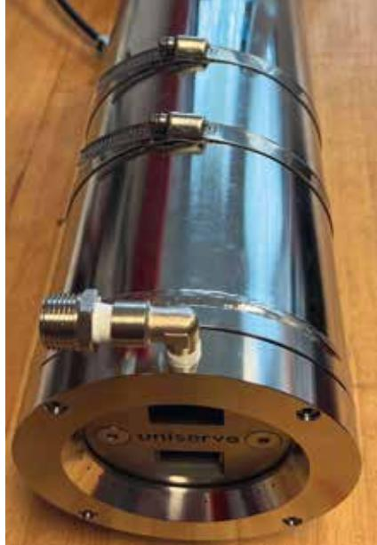
**FÜR HARTE BEDINGUNGEN:** Die gepanzerte Thermalkamera wurde für die Brecherüberwachung entwickelt.
