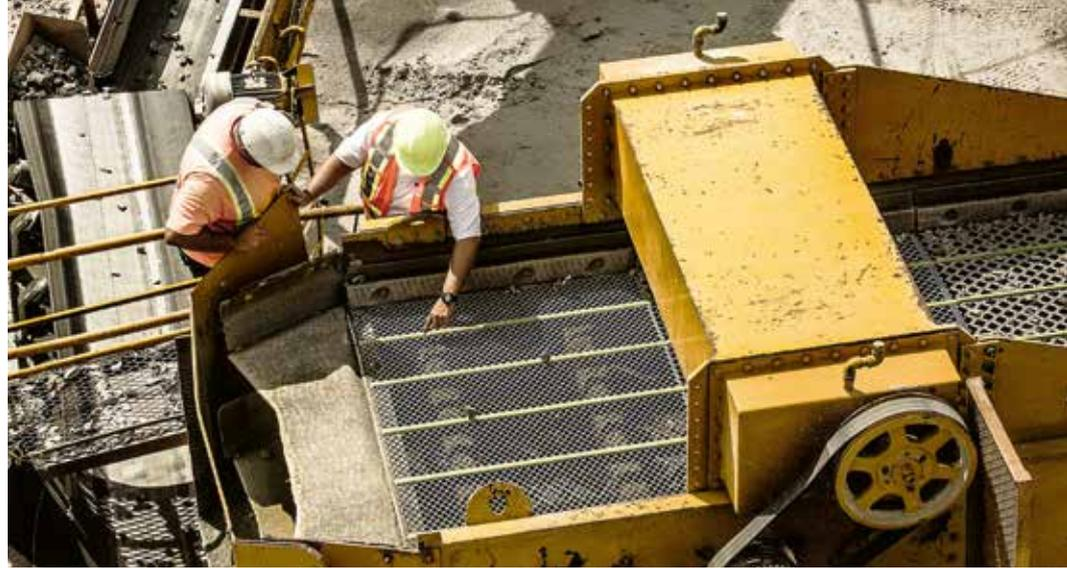
**JE NACH ANWENDUNG** können Flexmat-Hochleistungssiebmedien die Verschleißlebensdauer verlängern, das Verkleben und Verstopfen reduzieren, den Schichtungsprozess beschleunigen und Feinanteile besser entfernen, was die Gesamtqualität des gesiebten Produkts erhöht. Foto: Haver & Boecker
