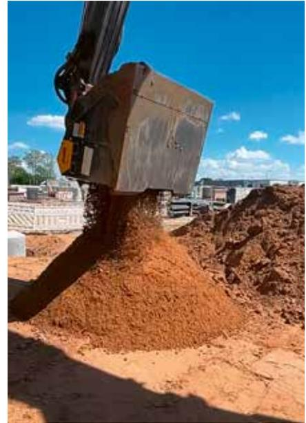
**VIelfältige Effizienz:** Der Schaufelseparator MB-HDS314 wurde zur Reduzierung von Abfällen und zur Verbesserung der Rentabilität von Baustellen entwickelt. Foto: MB Crusher
