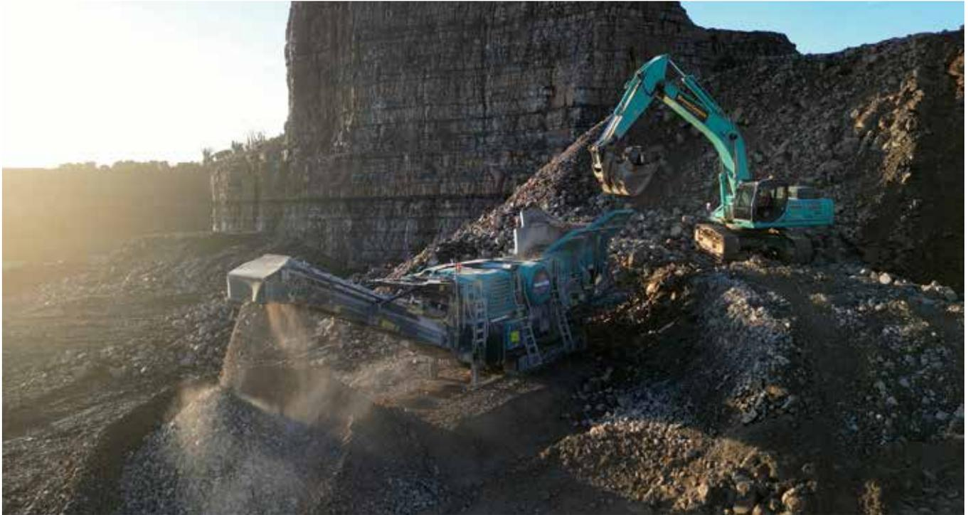
**IM BASALTSTEINBRUCH** zeigt der Backenbrecher PT450 sein Können: Im Vergleich zum Vorgängermodell hat er eine höhere Brechkraft bei nur geringem Zuwachs an Gewicht. Foto: Powerscreen
