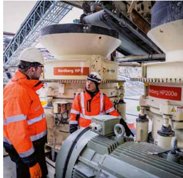
ZWEI IM PARALLELBETRIEB: Der neue Kegelbrecher Nordberg HP200e kommt hier direkt neben dem bewährten Nordberg HP3 zum Einsatz. Beide Systeme sind für die Zusammenarbeit perfekt aufeinander eingespielt. Foto: Metso Outotec
