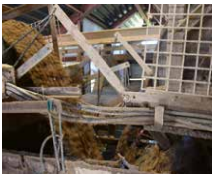
GEMEINSAME AUFBEREITUNG: Unmittelbar vor der Schwertwäsche werden die Rohmaterialien aus Trocken- (l.) und Nassgewinnung (r.) zusammengeführt und gemischt.
