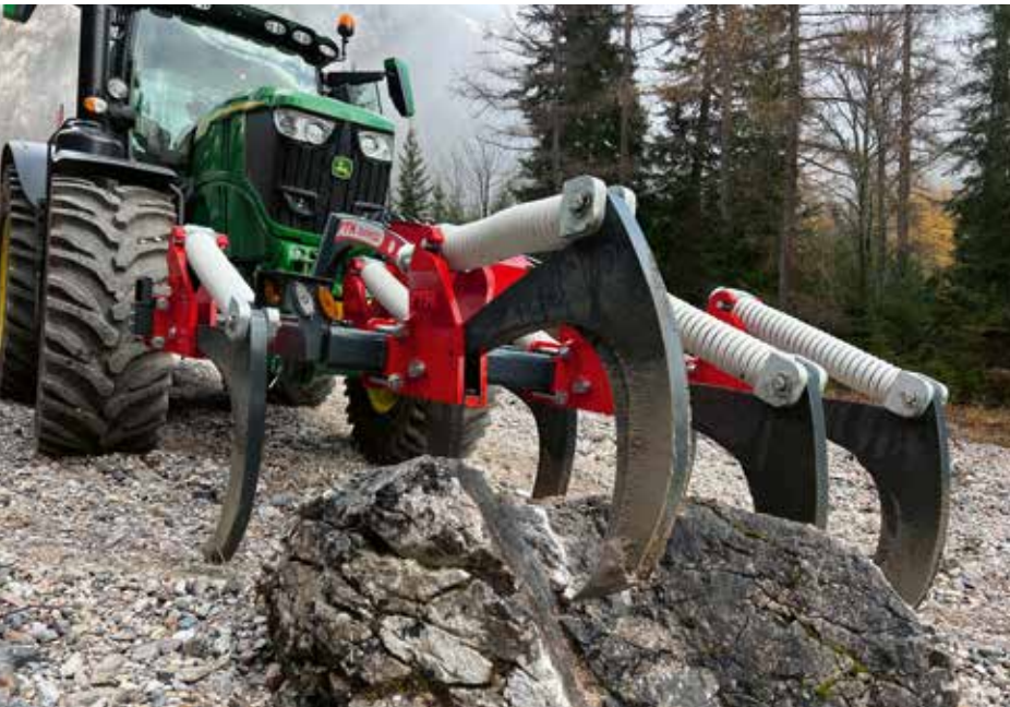
IM ZUGRIFF: Der PTH Ripper mit spezieller Kinematik dreht große Steine und Brocken heraus, um sie für den Steinbrecher PTH Crusher vorzubereiten.
