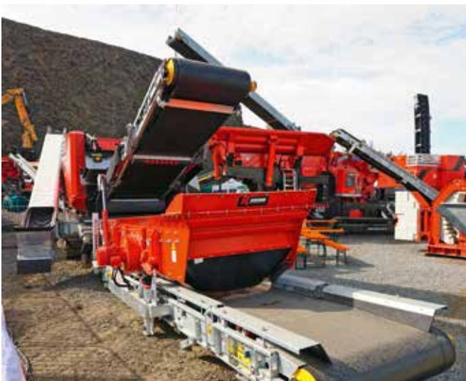
BESONDERHEIT: Das verlängerte Nachsieb des Remax 300 max für höhere Wertschöpfung nicht nur bei siebschwierigem Material.
