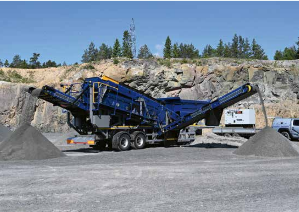
FEINFRAKTIONEN trennt die mobile Siebmaschine Eco6 präzise und schnell von größerem Aufgabegut. Foto: Sven Dassen/maskin mekano
