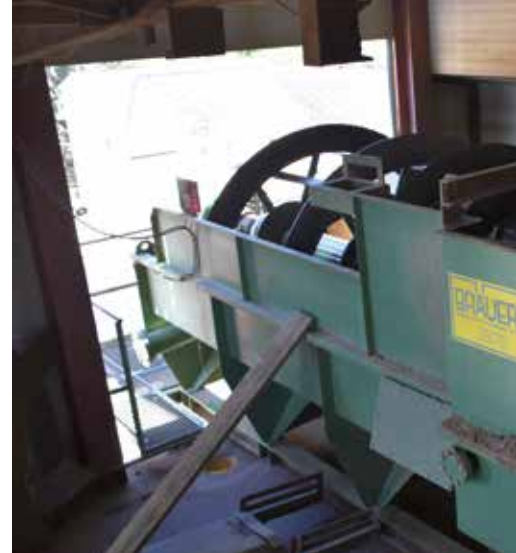
NACHBEREITUNG: Die gesiebten Sandkomponenten werden in einem Schöpfrad entwässert.
