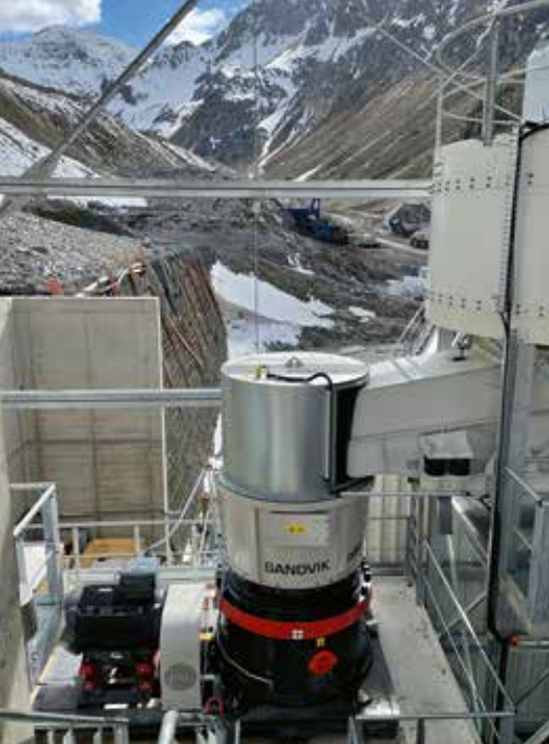
EXAKTE KÖRNRUNGEN: Für alle gewünschten Fraktionen sorgt ein leistungsstarker Sandvik-Hydrocone-Kreiselbrecher der i-Serie.
