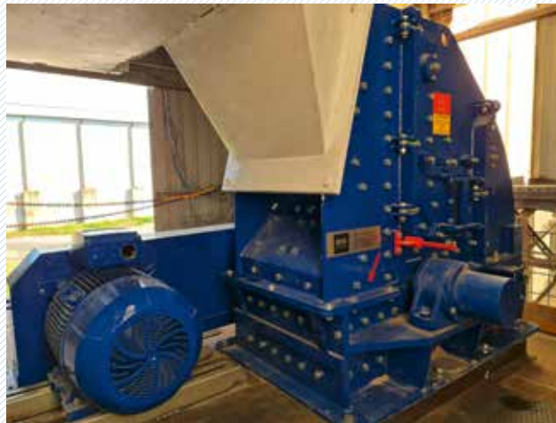
VULKANISCHES GLAS: Zwei Arten von Perlit verarbeitet der Prallbrecher PB 0806. Foto: BHS-Sonthofen
