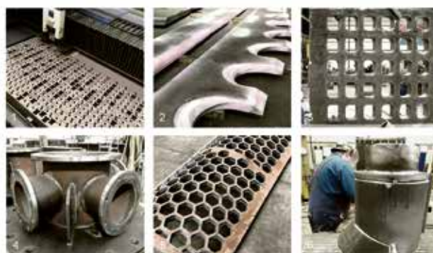
1. Laserschritt mit hoher Toleranzgenauigkeit, 2. Messer mit anzahl Farbänderung, 3. Sonderstab für einen Brecher im Steinbruch (t = 105mm), 4. Materialverteiler aus hochwertigen Abrastube - Rohren, 5. Sieb für die Recyclingindustrie, 6. Förderband für ein Braunkohlekraftwerk.
