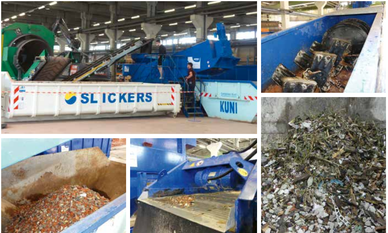
DEMONSTRATION: Ein Zemmler-Multiscreen-Trommelsieb – auch Teil der LIG – klassiert 0/X-Abbruchmaterial auf 10/80. Diese Fraktion wird mit dem HDS-WV behandelt. Ergebnis: starke Wäsche, exakte Leichtgutabtrennung über das Vibrosieb und saubere Mineralik. Ein Lamellenabscheider sorgt für Wasserklärung und -kreislaufführung.
