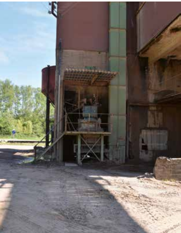
LEISTUNGSSTARK: Der Kegelbrecher sorgt in der Aufbereitung dafür, dass alle Komponenten verwertet werden können.
