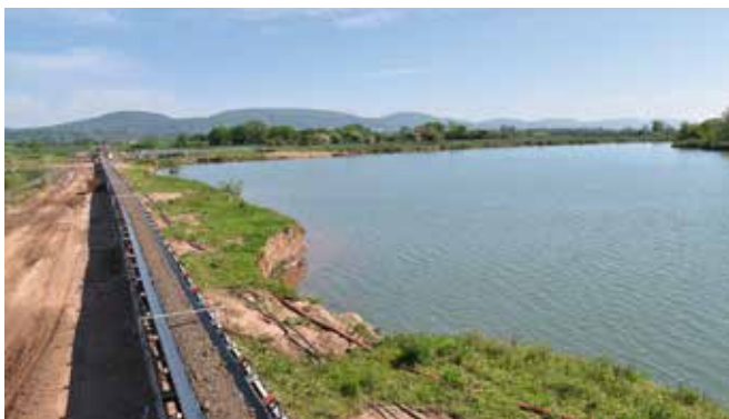
LANGE STRECKE: Das Landband der Nassgewinnung führt über weit mehr als 1 km um den großen Baggersee.
