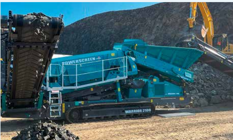
IM LIVE-EINSATZ: das raupenmobile Schwerlastsieb Warrior 2100 von Powerscreen
