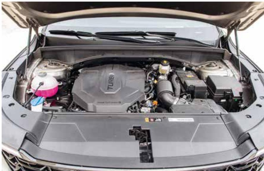
**BESTENS GEDÄMMT:** Der 2,2-l-Turbodiesel-Vierzylinder reicht für die 2,5-t-Fuhre völlig aus.
