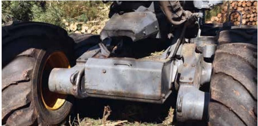
**TECHNIKTRANSFER:** Bei Forstfahrzeugen besonders aus skandinavischer Produktion gehören Bogieachsen zum alltäglichen Standard.
