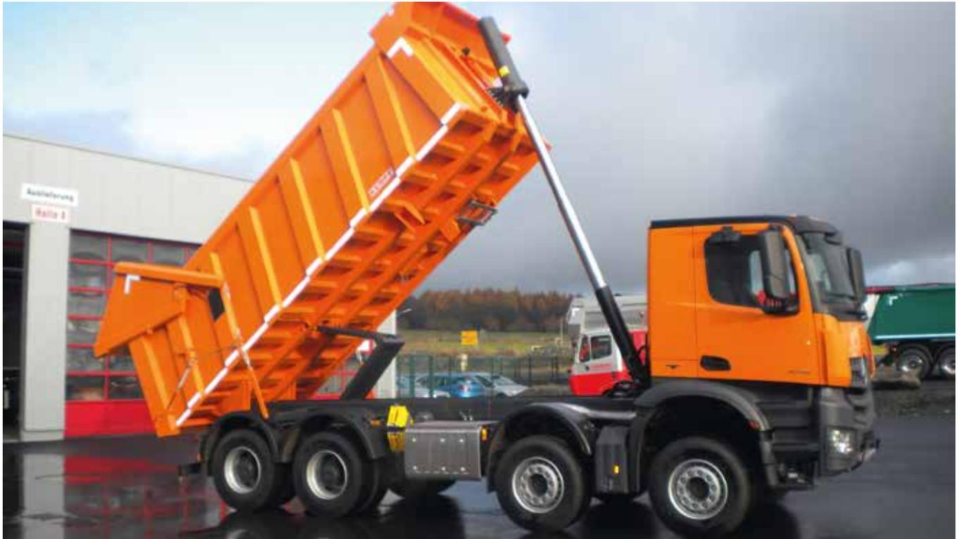
**MASSIVER KLASSIKER:** Die spantenbewehrte Kastenmulde zählt zu den Allroundern für den Steinbrucheinsatz. Fotos: Kempf
