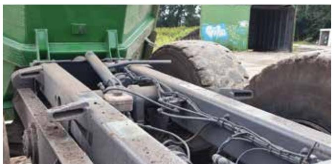
**DIE HINTERACHSEN** des O&K D25 werden von einem Pendeltandemgelenk außen am Hauptrahmen getragen.
