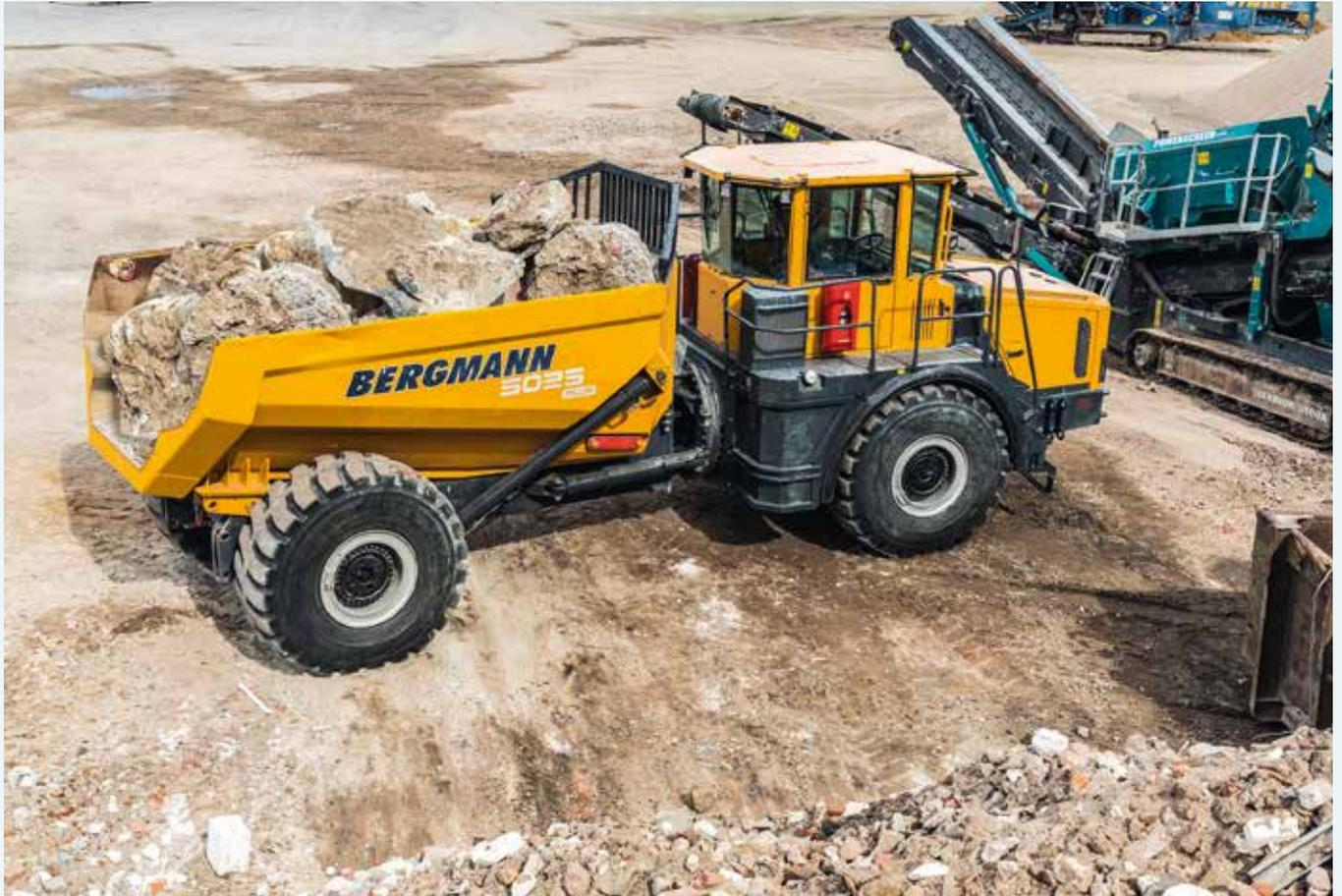
**FÜR DIE WENDIGE NICHE:** Bergmann c828s (5025 HK) 4x4-Tunneldumper mit erkennbar groß dimensioniertem Drehkranz. Foto: Bergmann
