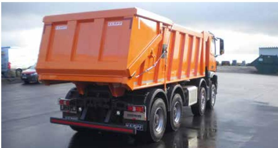
**SIMPEL UND UNVERWÜSTLICH:** Als Muldenabschluss arbeitet eine Zwangsöffnung mit Visiersverschluss.
