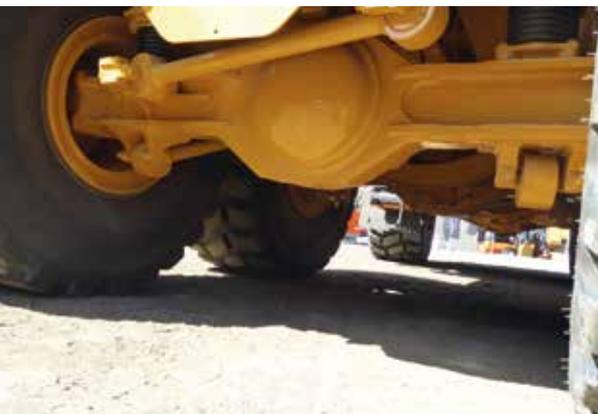
**ÄHNLICH ROKBAK:** Bei den Dumpfern von Caterpillar übernehmen Panhardstab und Längslenker die stabilisierende Funktion.
