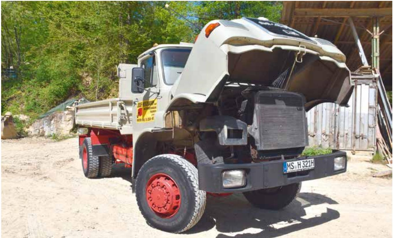
**GROSSE KLAPPE:** Der MAN gewährte durch eine komplett hochklappbare Frontpartie besten Zugang zur Technik. Fotos: Wistinghausen
