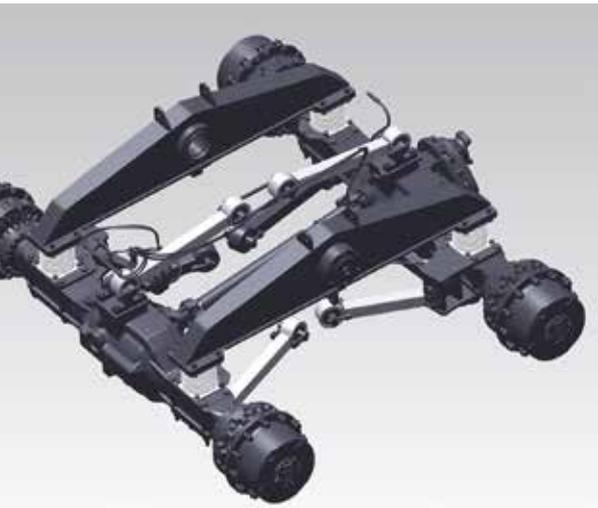
**SIMPEL UND EFFIZIENT:** Die Hinterachsaufhängung bei Rokbak verzichtet auf die A-Rahmen zugunsten von Längslenkern. Foto: Rokbak
