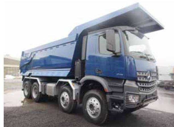
**SPEZIALAUFBAU FÜR DEN FAHRER:** Der Kabinenschutz kann über das gesamte Fahrerhaus gezogen werden.
