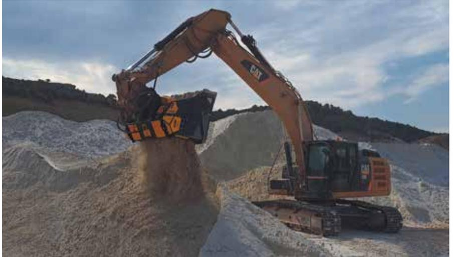
**ZEITGEMÄSSE VERARBEITUNG:** Ein wellenbasierter MB-Crusher-Schauelseparator übernimmt in einem spanischen Gewinnungsbetrieb das Zerkleinern von Kaolin. Foto: MB Crusher
