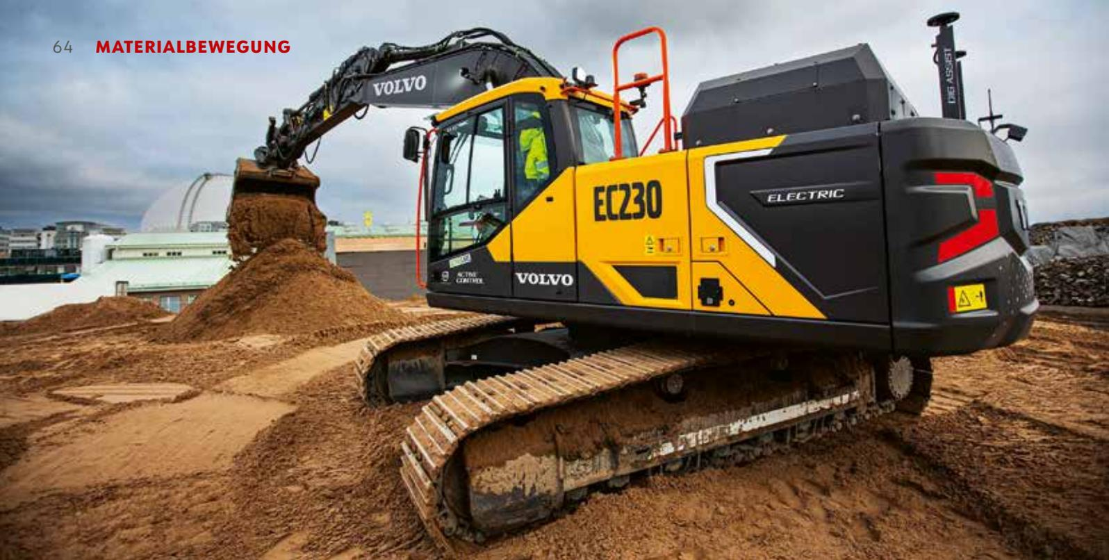
**BATTERIEELEKTRISCHE MITTELGRÖSSE:** der Volvo EC230 Electric. Fotos: Volvo CE
