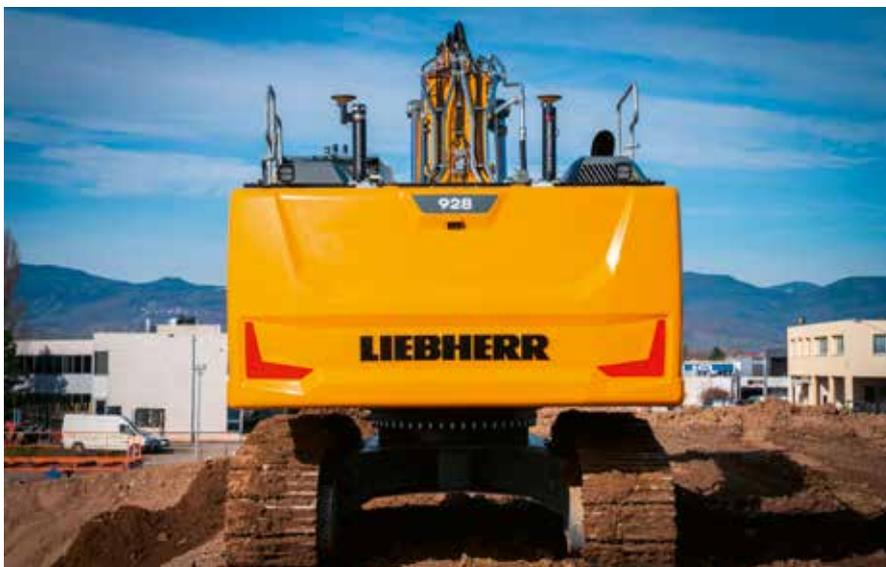
**ANTENNEN MIT GNSS-TECHNOLOGIE** ermitteln die exakte Position der Maschine – dank Leica Geosystems.
