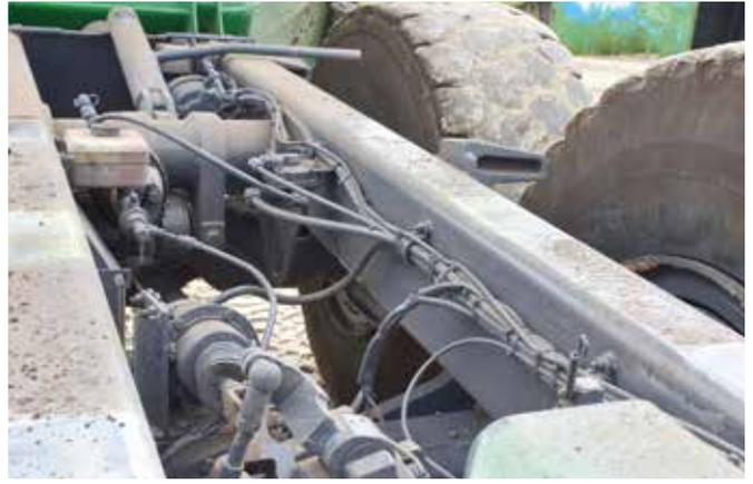
**GUT AUFGEARBEITET:** Rahmen und Antriebsstrang wurden restauriert und bilden das Rückgrat für die weitere Verwendung des Knicklenkers.
