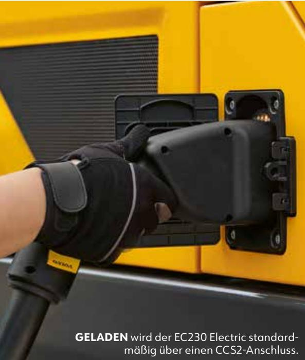
**GELADEN** wird der EC230 Electric standardmäßig über einen CCS2-Anschluss.
