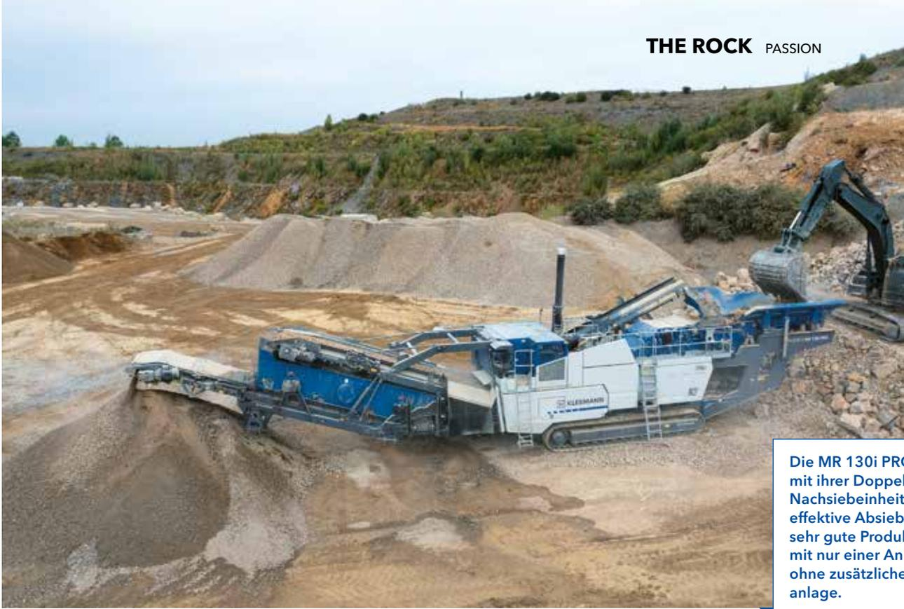
Die MR 130i PRO sorgt mit ihrer Doppeldecker-Nachsiebeinheit für eine effektive Absiebung und sehr gute Produktqualität mit nur einer Anlage - ohne zusätzliche Siebanlage.
