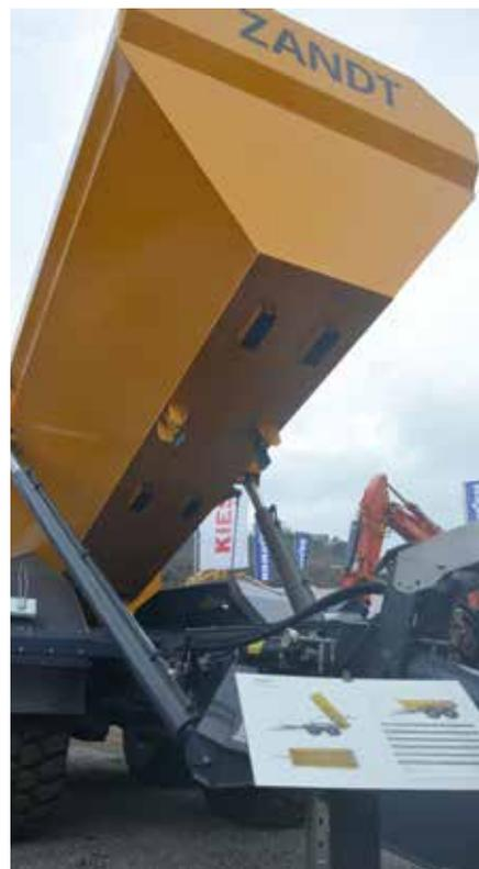
**DURCHDACHT:** Bis zu 70° Kippwinkel zwingen das Material aus der Mulde.
