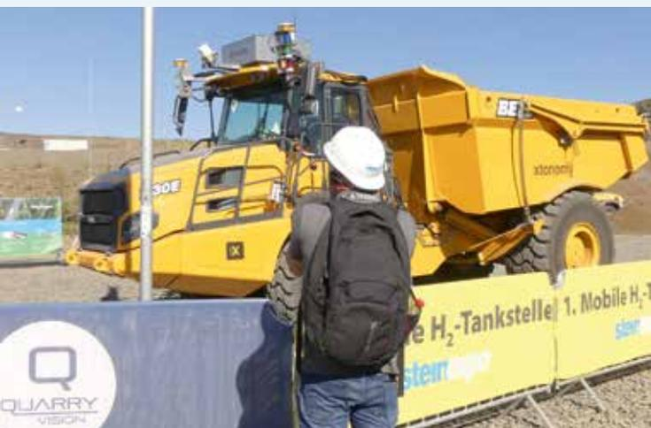
**ZUKUNFTSVISION AUTONOMIE:** Das allererste Mal öffentlich vorgestellt wurde ein Bell B30E mit radar-basierten Xtonomy-Multi-Assistenzsystem, das Muldenkipperereinsätze autark und absolut sicher macht. Foto: gsz
