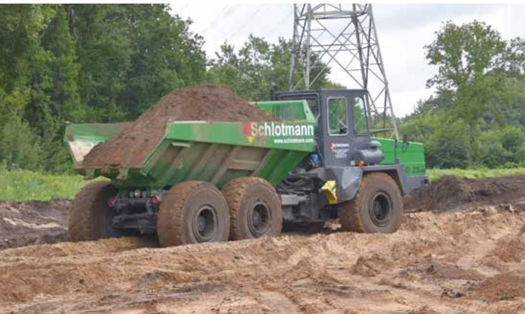
**IM EINSATZ:** Auch heute wühlt sich der betagte 25-Tonner noch souverän voll beladen mit permanentem Allradantrieb (6x6) durch den Sand der Senne.
