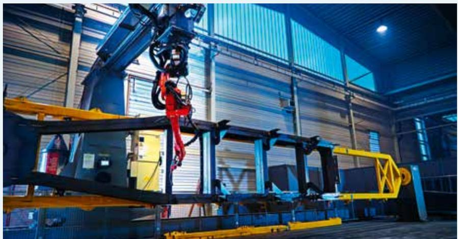
**LEISTUNGSSTARKE MODERNE:** Die Rahmen der Trailer werden hochpräzise auf einem mächtigen Schweißroboter fertiggestellt. Foto: Archiv Kempf
