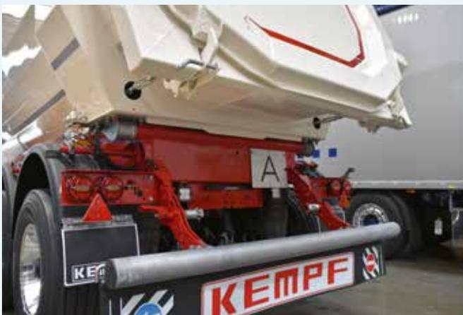
**SICHER DICHT:** Die aufliegenden Muldenklappen verfügen über eine umlaufende Gummidichtung und eine zusätzlich einfach mechanisch bedienbare Verriegelung.
