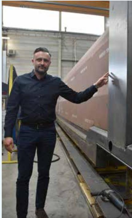
**HANDGEMACHTER KERN:** Vertriebsleiter Manuel Nagy mit einer der hochstabilen Stahlhalbbrundmulden, die bei Kempf im Wesentlichen aus Hardox 500 handgefertigt werden.
