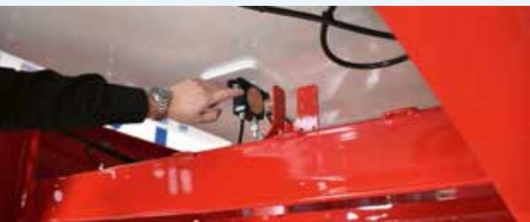
**VERSTECKTES DETAIL:** Am Muldenboden befindet sich recht unscheinbar ein sogenannter Druckluftrollenvibrator, mit dessen Hilfe der Muldenboden leicht gerüttelt werden kann, um anhaftende Lehm- oder Gesteinspartikel beim Entladen zu lösen.
