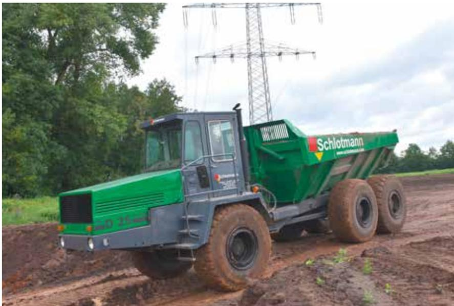
**MARKANTES GESICHT:** Wie auch bei modernen Dumpern ist unter anderem der vor der Vorderachse verbaute Motor charakteristisch für die Fahrzeugklasse.
