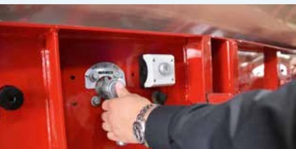
**ERHÖHTE SICHERHEIT:** In der Standardausführung verfügen die Kempf-Trailer über einen mechanischen Handhebel, um das Fahrwerk vor dem Abkippen in den Luftfedern auf den Block zu setzen – also abzusenken.
