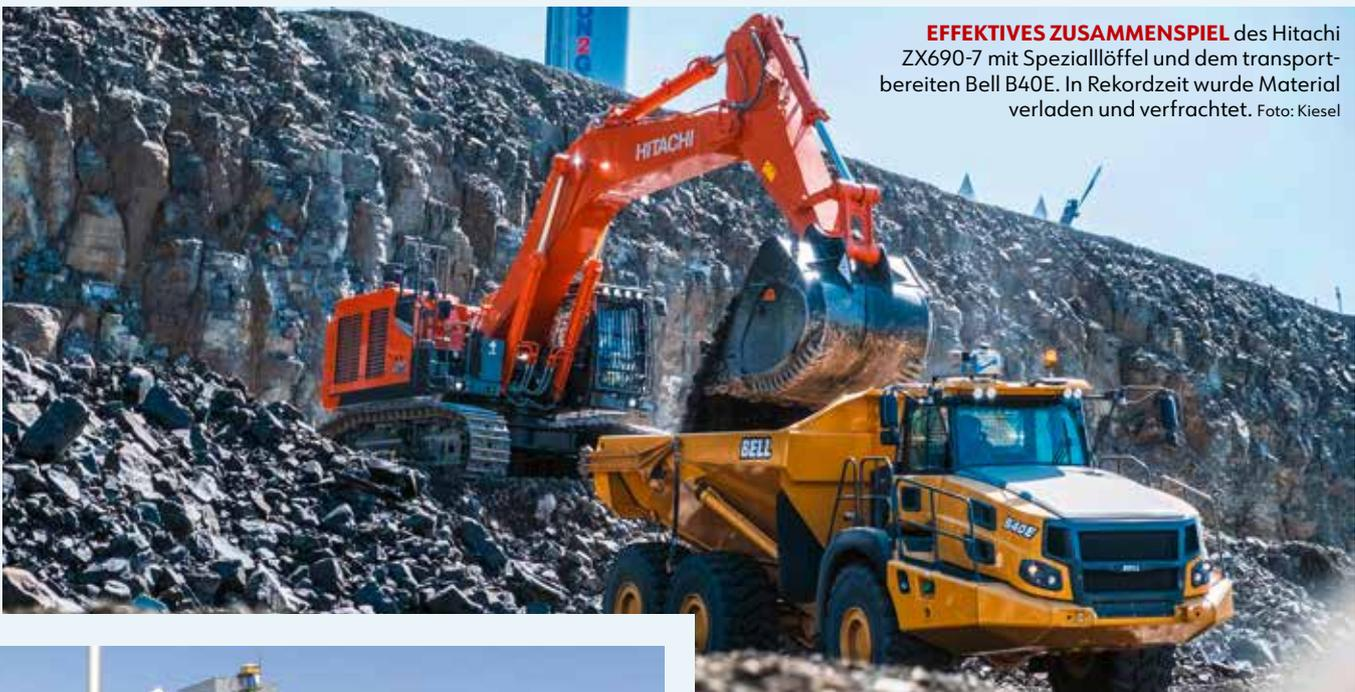
**EFFEKTIVES ZUSAMMENSPIEL** des Hitachi ZX690-7 mit Speziallöffel und dem transportbereiten Bell B40E. In Rekordzeit wurde Material verladen und verfrachtet. Foto: Kiesel
