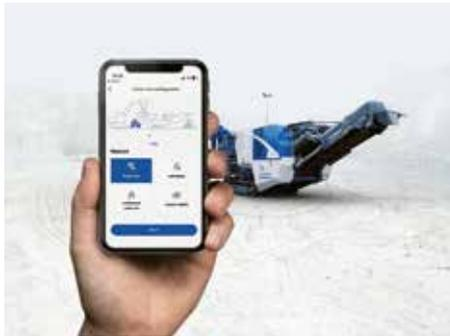
Die Anwendungen für Brechanlagen sind vielfältig. Je nach Aufgabematerial und gewünschtem Endergebnis sind unterschiedliche Maschinenparameter erforderlich und es braucht Zeit und Erfahrung, um die richtigen Einstellungen zu finden. Hierbei erleichtert der Smart Job Configurator den Arbeitsalltag. Das neue Konfigurationstool ist Teil der SPECTIVE CONNECT App und des SPECTIVE Touchdisplays.
