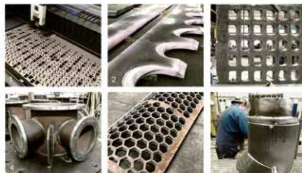
1. Laserzuschnitt mit hoher Toleranzgenauigkeit. 2. Messer mit anzahl Farbänderungsgrüfung. 3. Sonderset für einen Brecher im Steinbruch (t = 115mm). 4. Materialvertaler aus hochwertigen Abrolube - Rohren. 5. Sieb für die Recyclingindustrie. 6. Erreimerbaul für ein Braunkohlekraftwerk.
