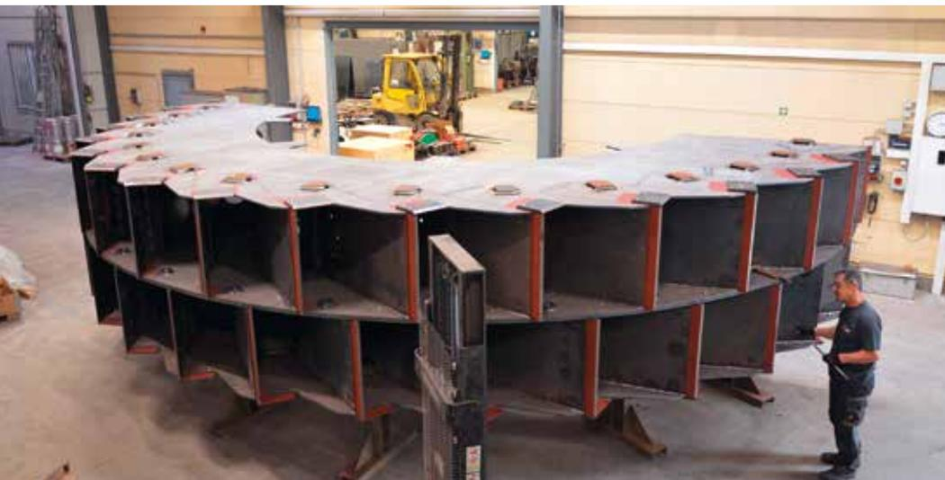
**SUPERLATIV:** 8 m Radius misst das größte Entwässerungsschöpfrad, das Kisa baut – für 800 t/h Durchsatz. Dieses Exemplar kommt schon bald in den USA zum Einsatz.
