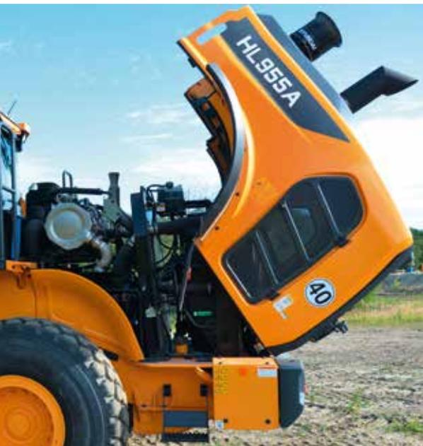
**PRAKTISCH:** eine Wartungsklappe mit integrierten Kotflügeln.
