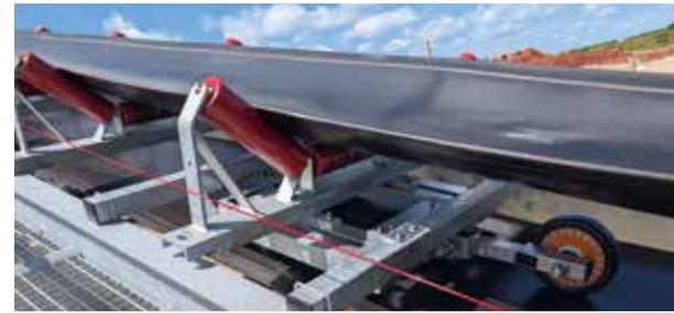
**DIREKT HINTER DEM VORBRECHER** montiert dank verstärktem Rahmen: Bandwaage EBW 10. Foto: MTS
