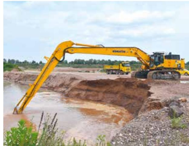
**48 NASSGEWINNUNG:** Ob Entwässerungsschöpfrad, Schrapperanlage, Pumpentechnologie oder Bagger mit Long-Front-Kombination aus Stiel und Ausleger – was zählt, ist eine effiziente Lösung, die vor Ort „passt“.
