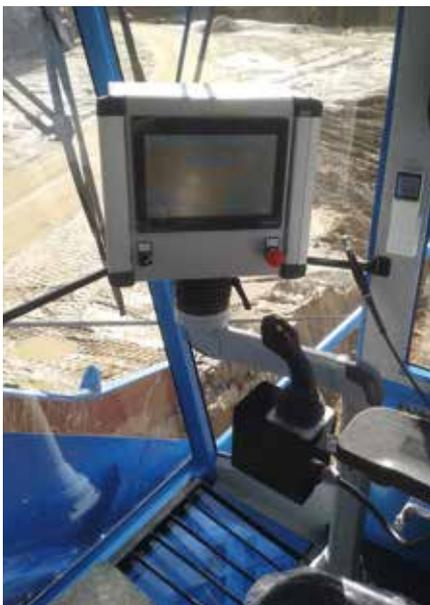
**MODERN UND EFFEKTIV:** Die heutigen Schrapperanlagen lassen sich intuitiv und sicher einfach per Joystick steuern.
