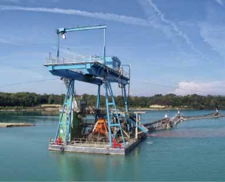
**FÜR GROSSE BAGGERTIEFEN** eignen sich vollautomatische Schwimmgreiferanlagen wie diese. Foto: Rohr Bagger
