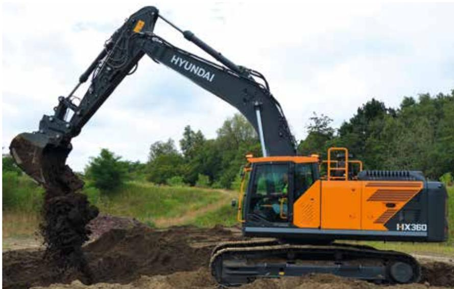
**PROTOTYP:** Der 36-t-Raupenbagger HX360 mit vollständig elektronischer Hydrauliksteuerung.
