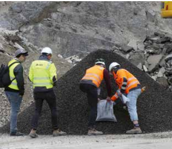
FACHPUBLIKUM LIVE: Nichts bleibt ungeprüft! Probenahme am recycelten Altasphalt und den anderen Stofffraktionen gehört dazu, ebenso die eingehende Begutachtung der Brecherbesonderheiten.
