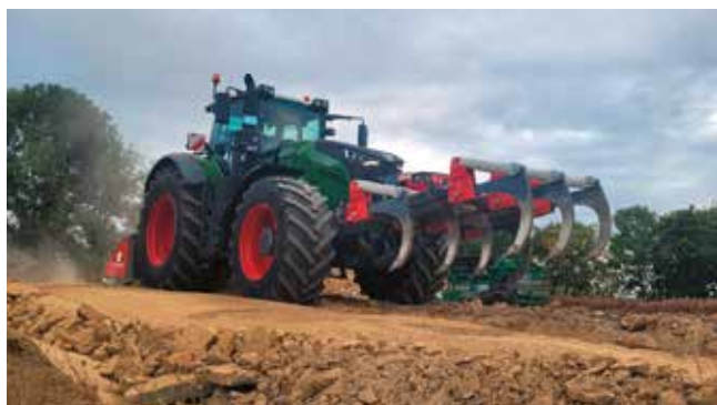
EIN ECHTER AUFRÉISER: Der PTH-Ripper hat sich als Tiefenlockerer bewährt. Fotos: PTH
