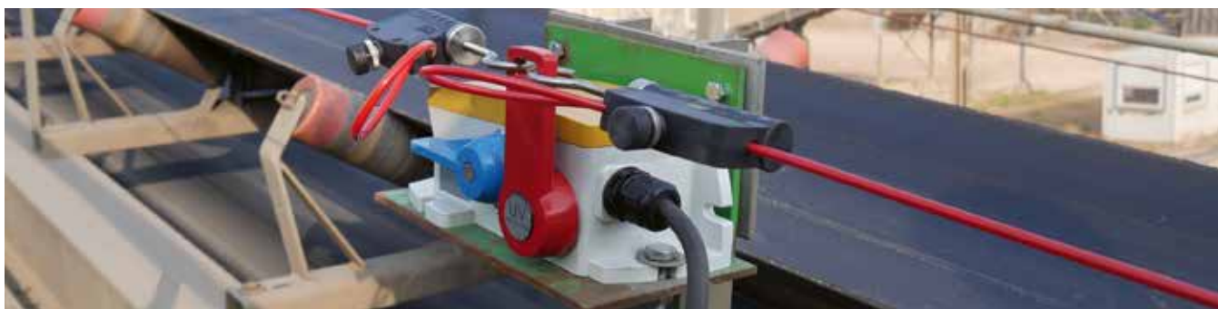
TEIL DES HEAVY-DUTY-PROGRAMMS: Extrem robuste Schaltgeräte der Baureihe ZS 92 für die Überwachung von Förderbändern. Foto: steute
