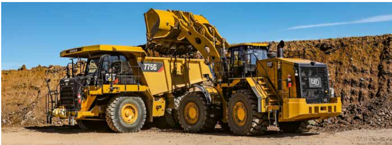
WELTNEUHEIT: der Cat-Radlader 988 GC beim Ladespiel. Fotos: Zeppelin Baumaschinen
