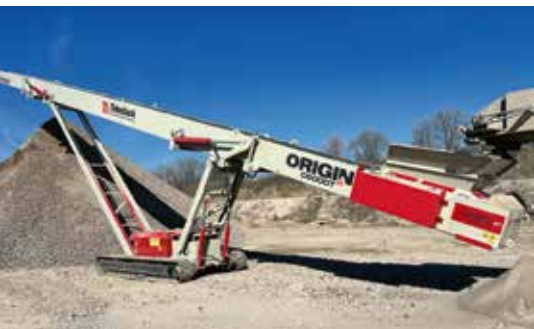
EINSTIEGSMODELL: der Telestack C6000T mit über 12 m Abwurfhöhe. Fotos: Kölsch/Christophel
