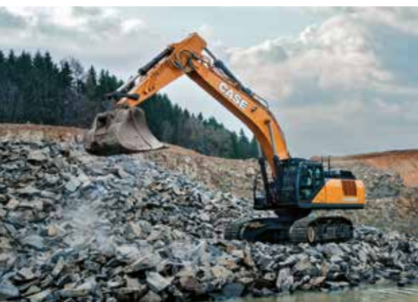
ATTRAKTIVES KRAFTPAKET: der 50-t-Raupenbagger CX490D mit 270 kW. Fotos: Case
