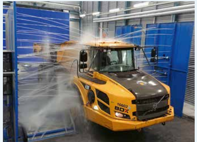
DEMUCKING IN AKTION: automatische Reinigung eines Dumpers
