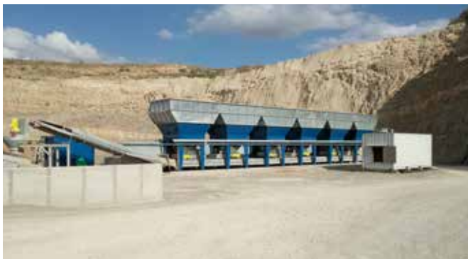
BASISVERSION RD 700 in Fünffach-Ausführung: produziert Mineralgemische schnell, präzise und wirtschaftlich.
