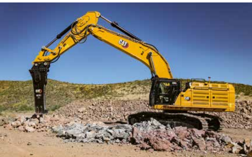
PRODUKTIVES GROSSGERÄT: Der neue hydrostatische Schwenkreis des Cat-Kettenbaggers 374 gewinnt die Schwenkbremseenergie zurück und steuert den Zylinderölfluss unabhängig.
