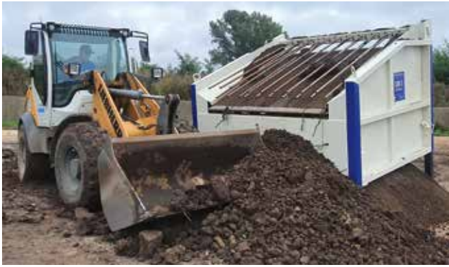
BEI DER BODEN-AUFBEREITUNG: das Baustoff-Recyclingsieb SBR 3.
