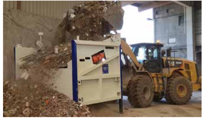
SBR 4 IN AKTION: hier als Bauschutt-Vorsieb. Fotos: EAG Einfach Aufbereiten
