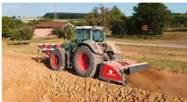
FRISCH GELOCKERT: So wird das Material nachfolgend mit erheblich weniger Verschleiß vom Steinbrecher „PTH-Crusher“ zu graderfähigem Material verarbeitet.
