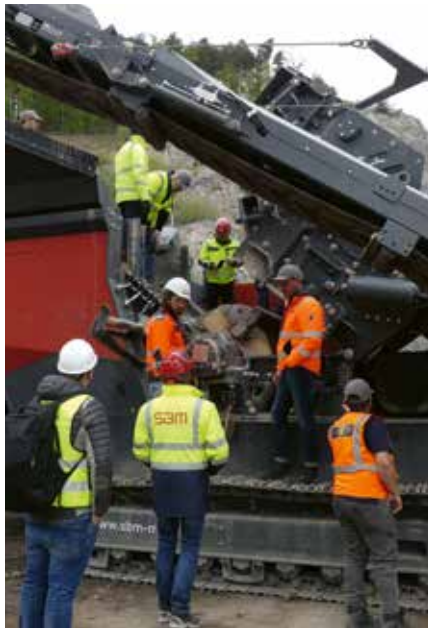
FACHPUBLIKUM LIVE: Nichts bleibt ungeprüft! Probenahme am recycelten Altasphalt und den anderen Stofffraktionen gehört dazu, ebenso die eingehende Begutachtung der Brecherbesonderheiten.
