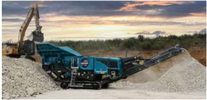
DURCHSATZSTARK: Der raupenmobile Powerscreen-Backenbrecher Premiertrak 400X zerkleinert bis zu 400 t/h.
