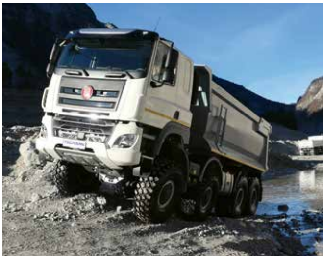
TRAKTIONSSTARK IN JEDEM GELÄNDE: Dafür sorgt Tatra mit Zentralrohrrahmen und luftgefederter Einzelaufhängung.
