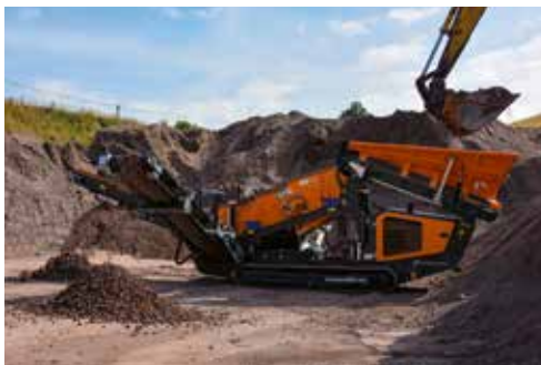
ALLESKÖNNER: Portafill-Schwerlastsieb MR-5X mit hohem Durchsatz von bis zu 200 t/h.
