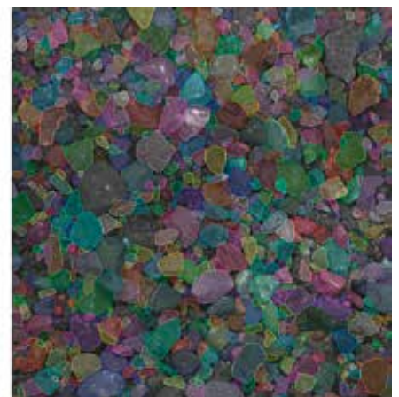
OPTISCHER KONTROLLEUR: Forscher der Montanuni Leoben entwickelten gemeinsam mit den F&E-Fachleuten bei SBM den optischen Sensor oberhalb des Hauptaustragsbandes und das Analyse-Verfahren zur Bestimmung der Kornverteilung.
