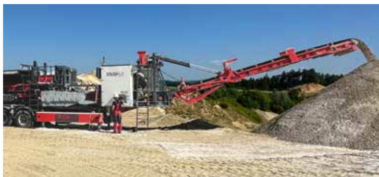
SCHONENDE ZERKLEINERUNG: Walzenbrecher der SGC-Serie für den Einsatz in der Tertiärstufe. Fotos: Crush + Size Technology
