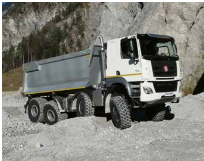
WENDIG WIE SONST KEINER: Eine Tatra-Spezialität sind die optional lenkbaren Achsen. Das betrifft alle Angetriebenen. Fotos: Tatra
