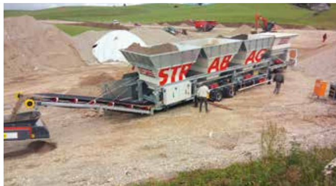
SATTELMOBILE VERSION RD 700 M: kann für kurzfristige Einsätze gemietet werden. Fotos: Tegethoff-König Dosiertechnik
