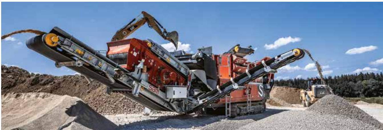
ALLSEITS BEKANNT: Prallmühle mit neuem Doppeldecksieb von SBM. Als Messeneuheit stellt der Hersteller nun auch den Backenbrecher Jawmax 300 mit Doppeldeck vor.
