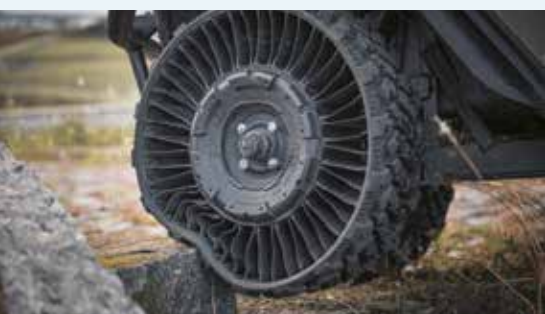
PLATTFUSS ADE: Der Michelin X Tweel ist eine komplette Rad-Reifen-Kombination als Ersatz für Reifen plus Felge plus Ventil. Fotos: Michelin
