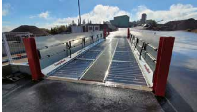
SAUBERE ARBEIT: Sunny-Wash-Lkw-Reifenwaschanlagen passen perfekt wie ein Maßanzug. Fotos: CHE Stahlbau
