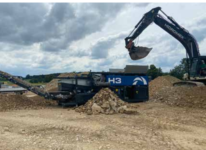
MOBILER EXPERTE: der hakenliftmobile 3-Fractionen-Spezialseparator Splitter H3. Foto: Anlagenbau Günther
