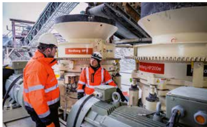
ZWEI KEGELBRECHER IM PARALLEL BETRIEB: Der neue Nordberg HP200e kommt hier direkt neben dem bewährten Nordberg HP3 zum Einsatz. Beide Systeme sind für die Zusammenarbeit perfekt aufeinander eingespielt.
