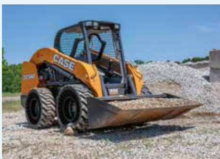
PLATTFUSS ADE: Der Michelin X Tweel ist eine komplette Rad-Reifen-Kombination als Ersatz für Reifen plus Felge plus Ventil. Fotos: Michelin
