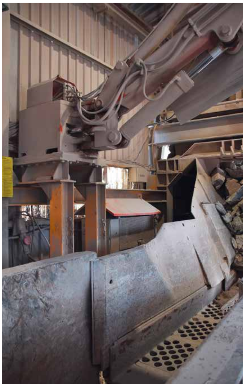
VOR DEM BRECHER: Zwangsgeführte Exzenter-Vibrationssiebe werden häufig als Beschicker für Vordrecher eingesetzt. Foto: bwi
