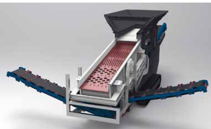
FÜR GROBE AUFGABEN: Die Exzenter-siebanlage HBN von Haver & Boecker Niagara überträgt Grobstücksiebtechnik auf mobile Anwendungen. Foto: Haver & Boecker Niagara
