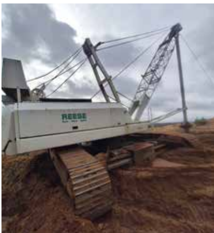
BÖSCHUNGSWINKEL-POLIZEI: Ein Seilbagger samt Igelwalze sorgt für den maximalen 50°-Winkel im Sinne sicherer Rohkiesgewinnung. Fotos, sofern nicht anders angegeben: tne
