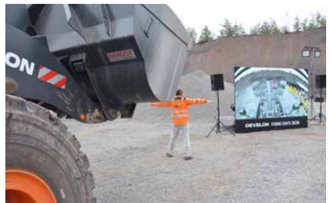
GEGEN TOTE-FRONT-WINKEL hilft das Sichtsystem „Transparent Bucket 2.0“. Das auf der Leinwand zu sehende Bild wird dem Fahrer in der Kabine angezeigt.
