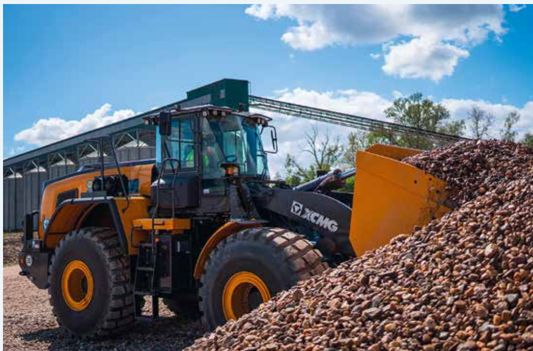
EINE BATTERIELADUNG dieses E-Radladers hält 6 bis 8 h, was einem Arbeitstag gleichkommt. Foto: Holemans
