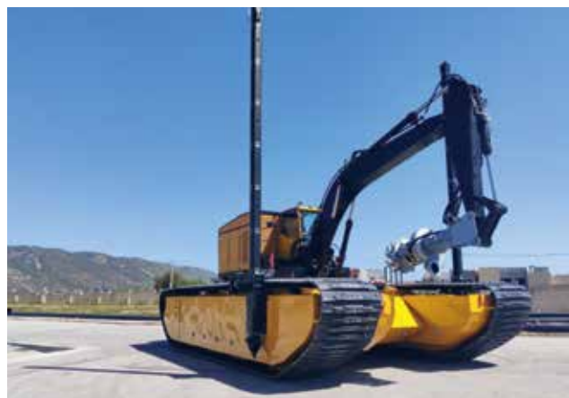
AMPHIBISCHER DRM-BAGGER mit Hochleistungspumpe am Ausleger. Foto: Dragflow
