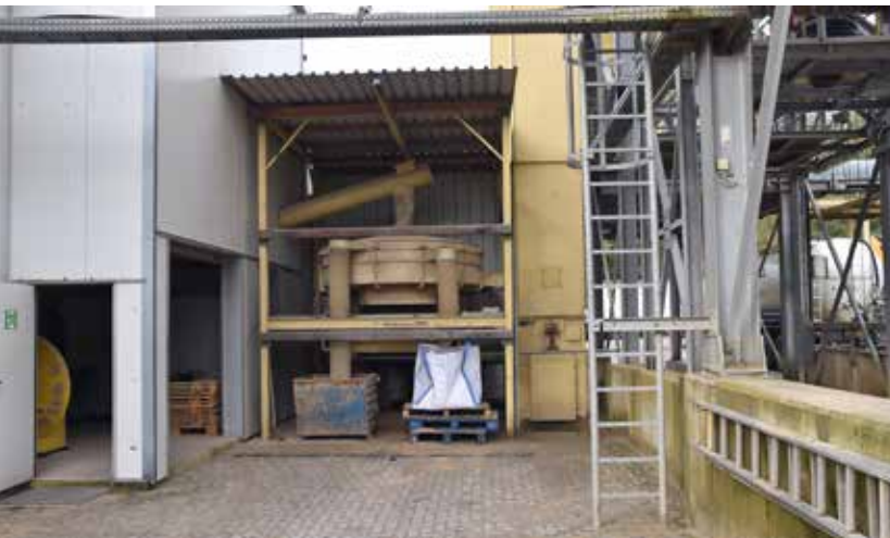
FÜR BESONDERE TRENNAUFGABEN: Taumelsiebe kommen etwa bei der Feinsandseparierung und anderen Spezialanwendungen zum Einsatz. Foto: bwi
