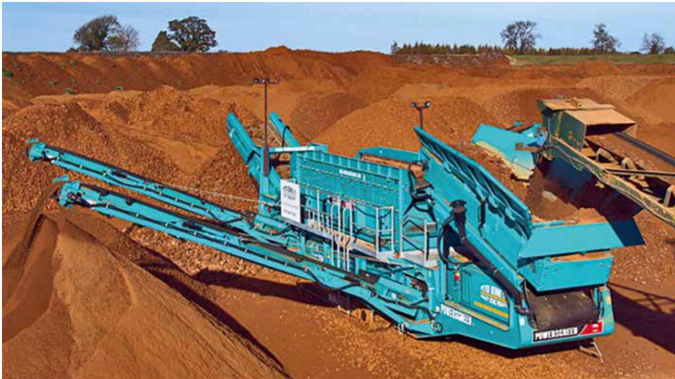
MOBILER EXOT: Die Powerscreen Horizon 6203 arbeitet als Linearschwinger in Horizontalbauweise mit Siebdeck ohne Gefälle. Foto: Powerscreen
