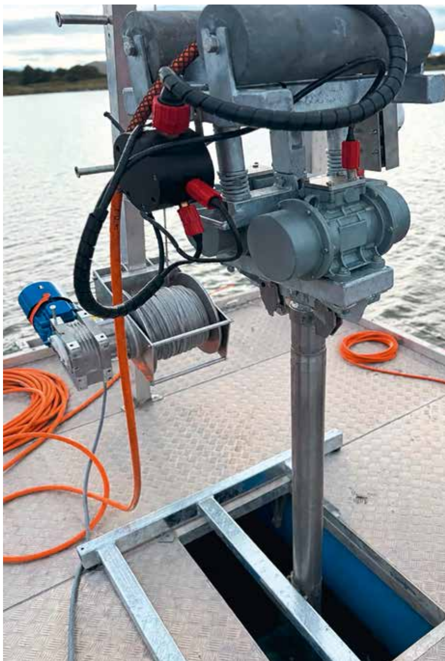
AUF DEM BAGGERSEE arbeitet der Vibracorer Mini-VC mit 2-m-Kernrohr montiert, 0,8 t Antriebseinheit, 800 kg Vibrationskraft, ohne Absatzgestell durch den Moon-Pool auf einem kleinen Ponton.
