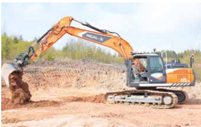
FÜHRERLOS PRODUKTIV: Das Real-X-System zeigte in der Live-Demo, wie autonomes Baggern funktioniert. Fotos, sofern nicht anders angegeben: tne
