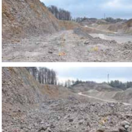
**VORHER – NACHHER, TEIL 1:** Der zur Sprengung vorgesehene Bereich ist intakt und befahrbar, während die Sprengbeanspruchung danach an der aufgewirkten Oberfläche erkennbar ist.
