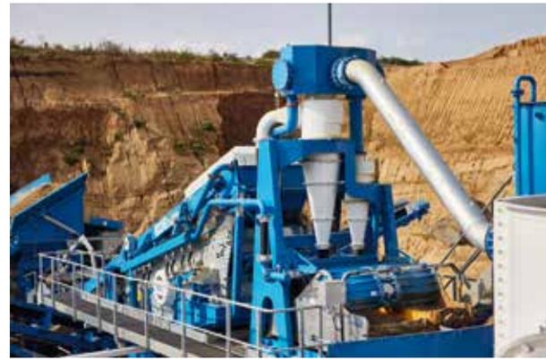
**DIE MODULARE WASCHANLAGE** M2500 umfasst die Beschickung, Klassierung, das Waschen und die Verhaldung auf einem einzigen Chassis.
