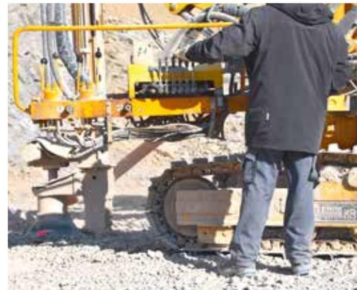
**SIMPLE BEDIENUNG** für gekonnte Arbeit: Das Klemm-Universalbohrgerät lässt sich über einen kleinen Steuerstand mit wenigen Hebeln bedienen.
