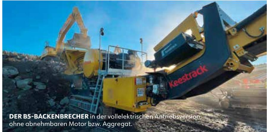
**DER B5-BACKENBRECHER** in der vollelektrischen Antriebsversion, ohne abnehmbaren Motor bzw. Aggregat.
