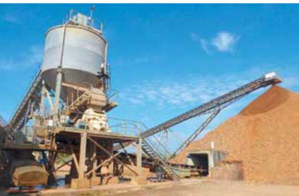
**LEISTUNGSSTÄRKE IM VERBORGENEN:** Der Überkornbrecher verfügt über das einzige Silo vor Ort. Die Halden verfügen allesamt über Unterflur-Abzugsorgane.
