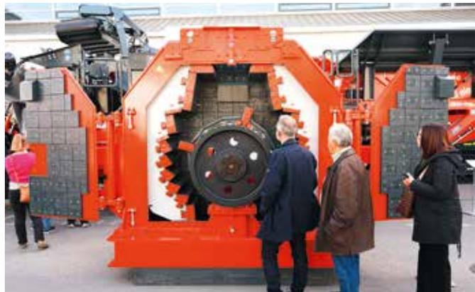
DER REVERSIERBARE PRALLBRECHER SMR 13/7/4 arbeitet in der Sekundär- oder Tertiärstufe und ist Bestandteil des neuen OEM-Lieferprogramms „SBM Components“.
