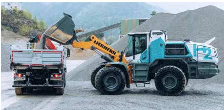
**GROSSE FUSSTAPFEN:** Der Liebherr-Großradlader mit Wasserstoffmotor wird in einem mehrjährigen Testbetrieb im Kanzelsteinbruch erprobt. Fotos: Strabag, Martin Anger
