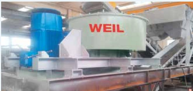
**VOLL INTEGRIERT:** Vertikalprallbrecher BD8 in einer mobilen Einheit. Fotos: Weil
