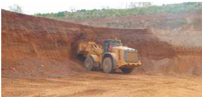
**EINFACH, ABER EFFIZIENT:** Das nutzbare Vorkommen ist recht heterogen aufgebaut, ermöglicht aber einen einfachen Trockenabbau mittels Radlader.
