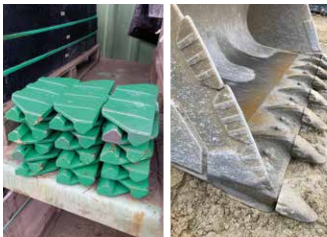
SEITENSCHUTZSCHILDE von Esco bewähren sich hervorragend beim Schutz stark belasteter Schaufelsegmente. Fotos: HS-Schoch®
