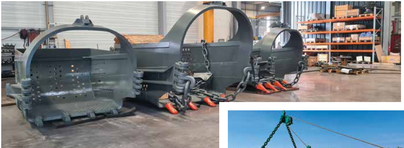
EIN TRIO ZEIGT ZÄHNE: IEV-Schleppschaufeln am Produktionsort in Verdun. Foto: IEV
