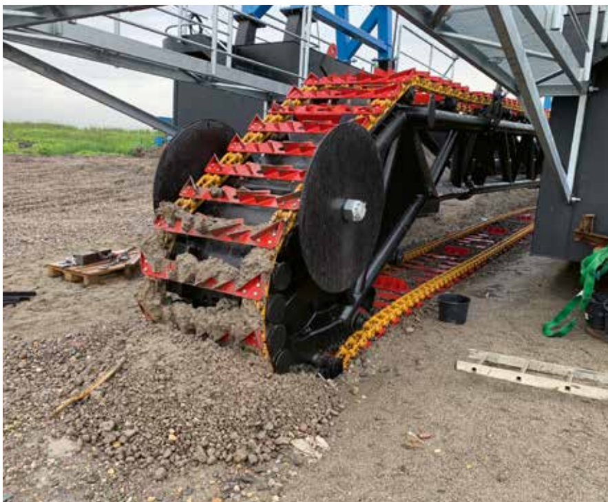
BEWÄHRTES PRINZIP: Bei den Spezialvarianten von FFA Fiebig läuft eine Förderkette vor dem Saugrohr.
