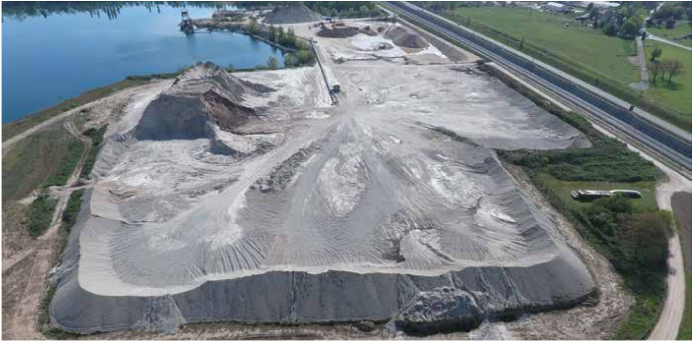
DAS „NEGATIV“ VOM TUNNEL: Sande und Kiese, die den Tunnelröhren weichen mussten, wurden auf einer separaten Fläche im Kieswerksgelände zwischengelagert. Fotos: Kern-Gruppe
