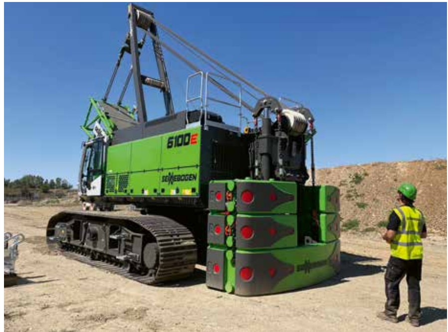
SCHNELL GERÜSTET: Das Selbstmontagesystem spart vor Ort den zusätzlichen Hilfskran. Raupen sowie Heckballast kann der 6100 HD selbst aufnehmen und absetzen.
