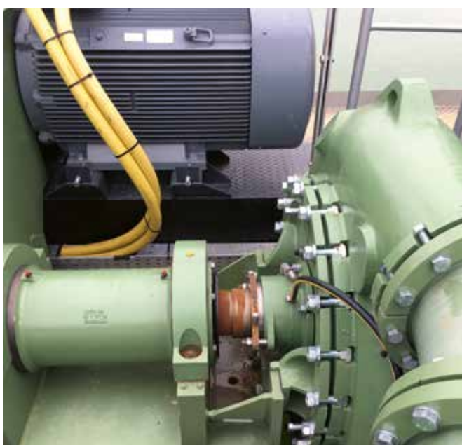
VOLLE KRAFT VORAUSS: Antriebe stehen zwischen 160 bis 400 kW mit Baggerpumpen in Nennweiten 200 bis 350 zur Verfügung.
