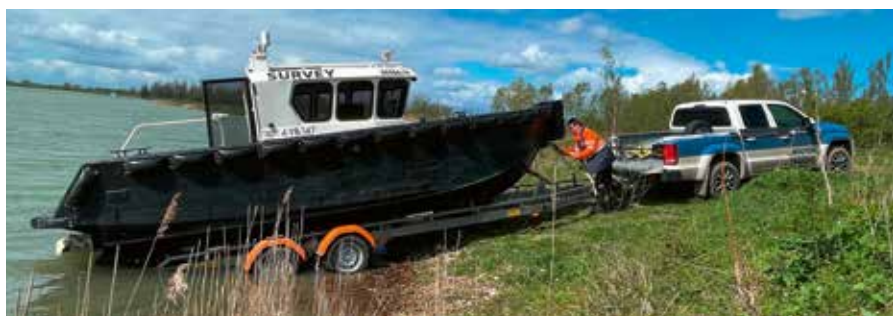
VOLUMENBESTIMMUNG: Für die Datenerhebung unter Wasser wird ein modern ausgestattetes multi-beam-Peilboot eingesetzt.
