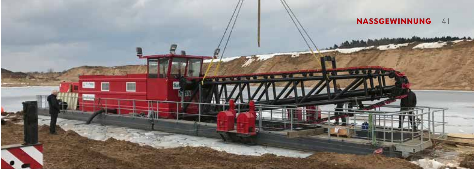
AUCH NACHRÜSTBAR: Für den Einsatz der Förderkette vor dem Saugrohr muss allerdings ein tragfähiges Vorschiff vorhanden sein.
