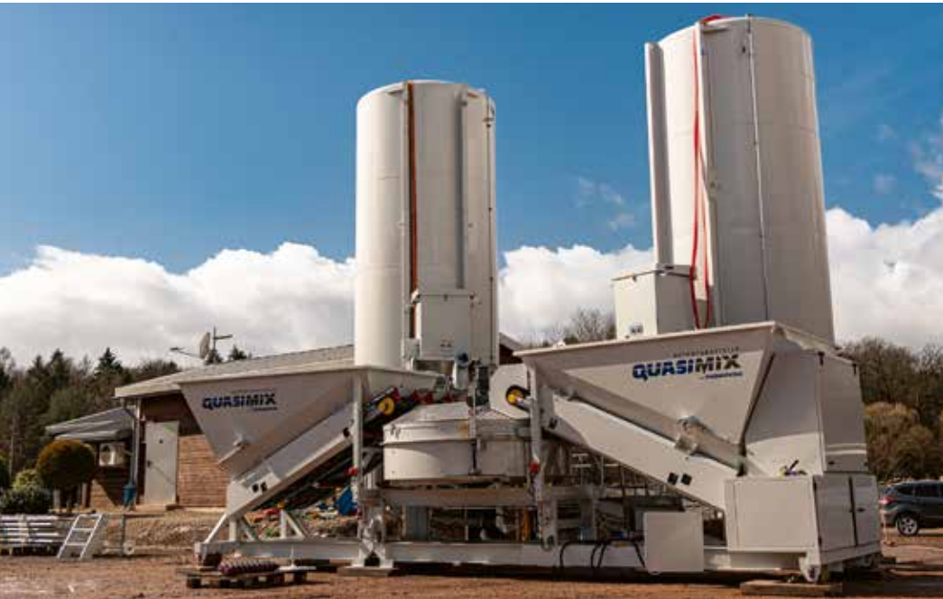
KLASSISCHE INSTALLATION: Quasimix 1000 mit je zwei Doppelbunkern und Silos sowie 1-m 3 -Mischer. Fotos: Promekon
