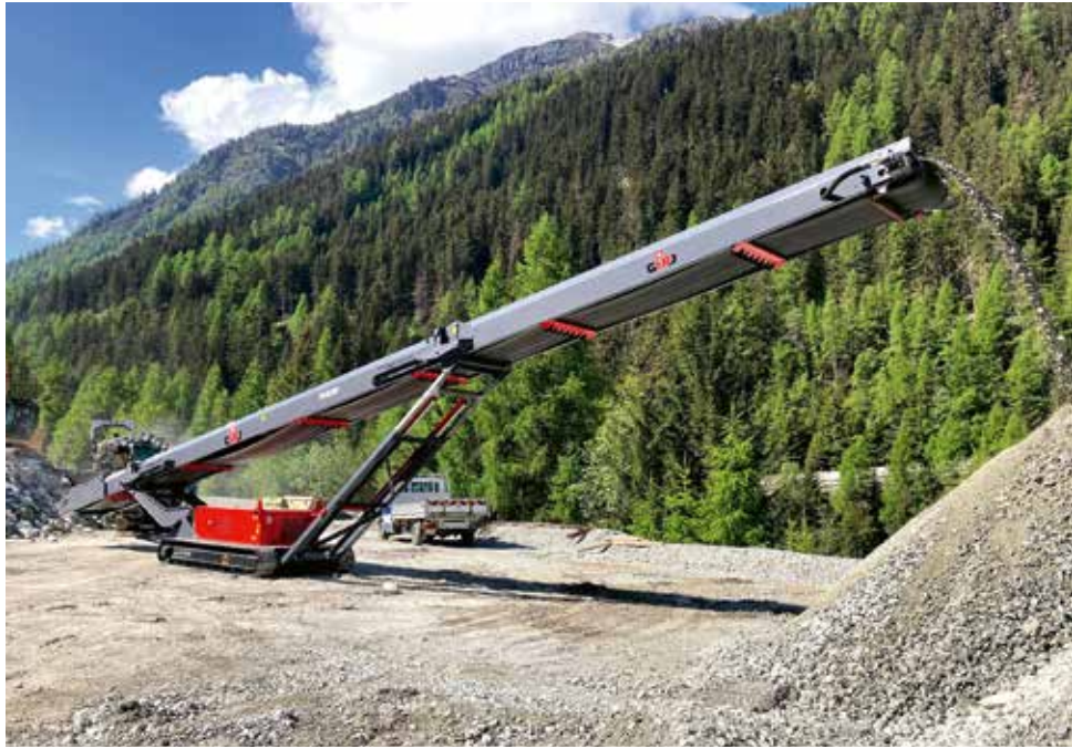
PRODUKTIV IM BETRIEB: Gipo-Haldenband im radladersparenden Einsatz. Foto: Gipo
