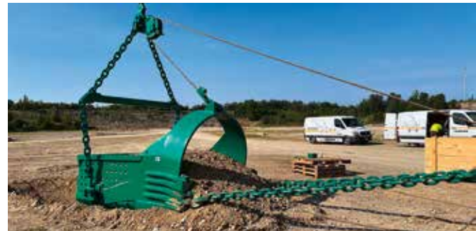
BEREIT ZUR MONTAGE für den Gewinnungseinsatz an einem Liebherr-Hydroseilbagger. Foto: Negrini
