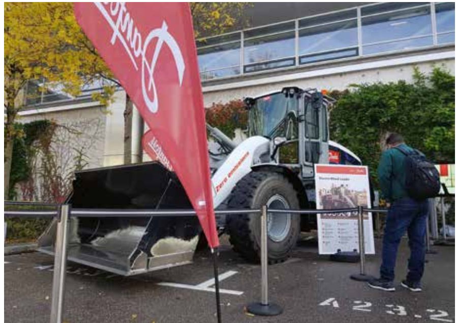
ANSCHAUUNGS-OBJEKT: ein mit 15 Danfoss-Komponenten elektrifizierter Cat-Radlader.
