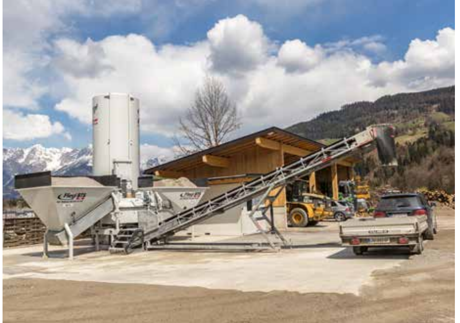
EINFACHER GEHT'S NICHT: Kleine Mengen qualitativ hochwertigen Betons sind mit der Fliegl-Betontankstelle BTS schnell und zuverlässig hergestellt.
