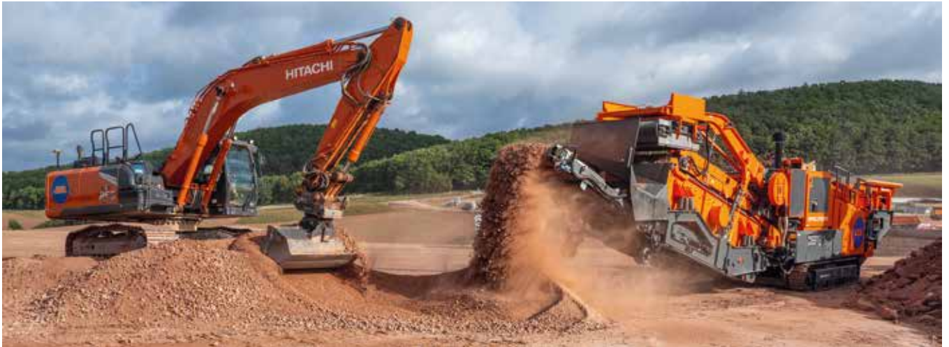
DIE HOHE DURCHSATZLEISTUNG auch bei harten Materialien ist eine der Stärken des Gipo-Prallbrechers.
