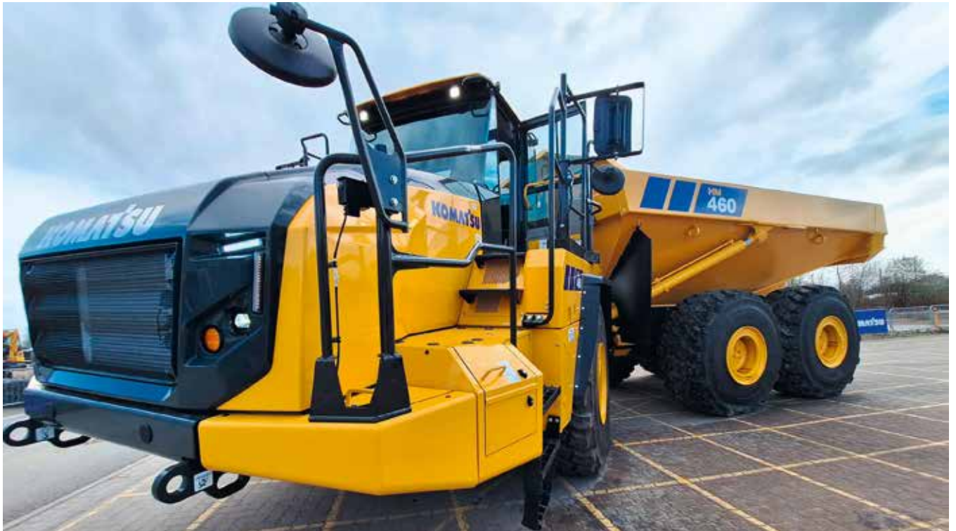
SPARSAMER NUTZLAST-RIESE: der knickgelenkte Muldenkipper HM460-6. Fotos: tne
