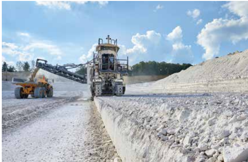
DIREKT AUF DEN DUMPER: Die komplexen Maschinentypen verfügen über interne Leitbleche und Bandanlagen, die eine Übergabe auf ein schwenk- und höhenverstellbares Abwurfband erlauben.
