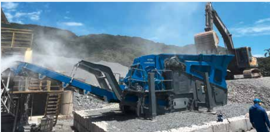
BLAUES KRAFTPAKET: elektrisch betriebener Rotorbrecher. Foto: Vortex
