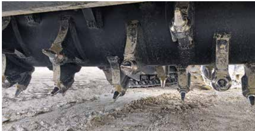
VARIANTEN MÖGLICH: Durch die Ausbildung und Anordnung von Walze und Reißmeißeln lassen sich die Surface-Miner auf unterschiedliche Lagerstättenparameter ausrichten.
