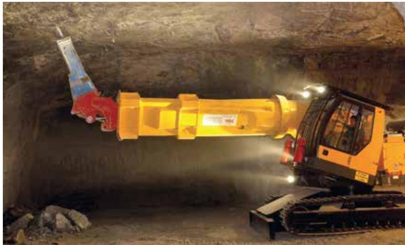
**BEWEGLICHER ARM:** Die großen TML-Modelle verfügen über einen frei rotierbaren Teleskoparm sowie eine gepanzerte FOPS-Kabine. Fotos: TML
