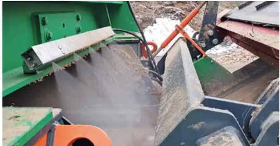
**VIELFÄLTIGE ANWENDUNGSBEREICHE:** Die Düsentechnik kann an jeder beliebigen Stelle einer mobile Schredder- oder Brecheranlage direkt positioniert werden.
