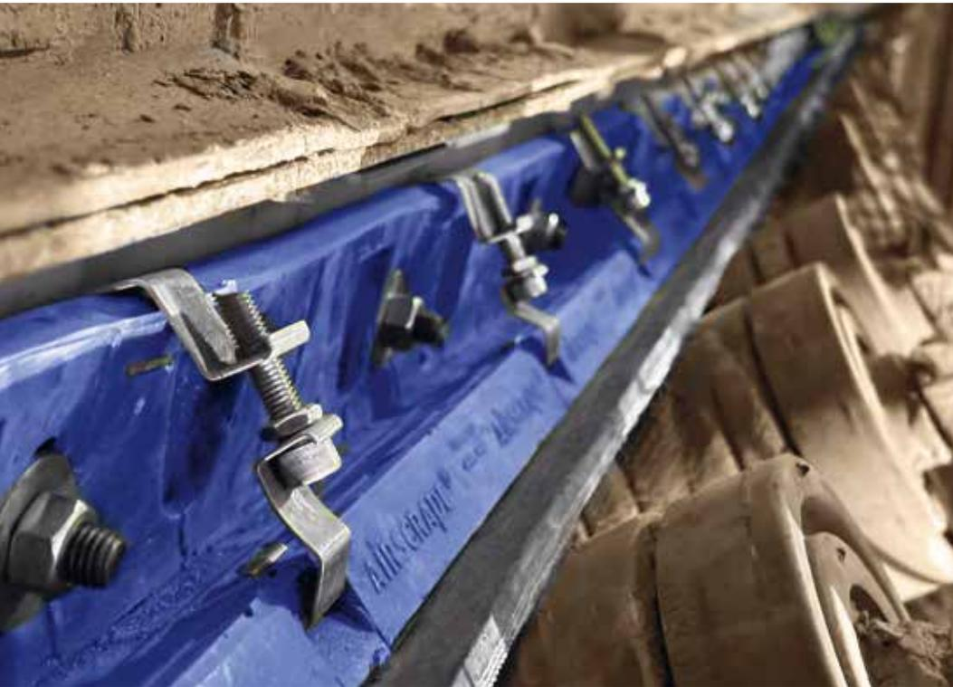
**STAUB UND MATERIALVERLUST WAREN GESTERN:** Airscrape hilft effektiv an Förderband-Übergaben. Foto: Scrapetec
