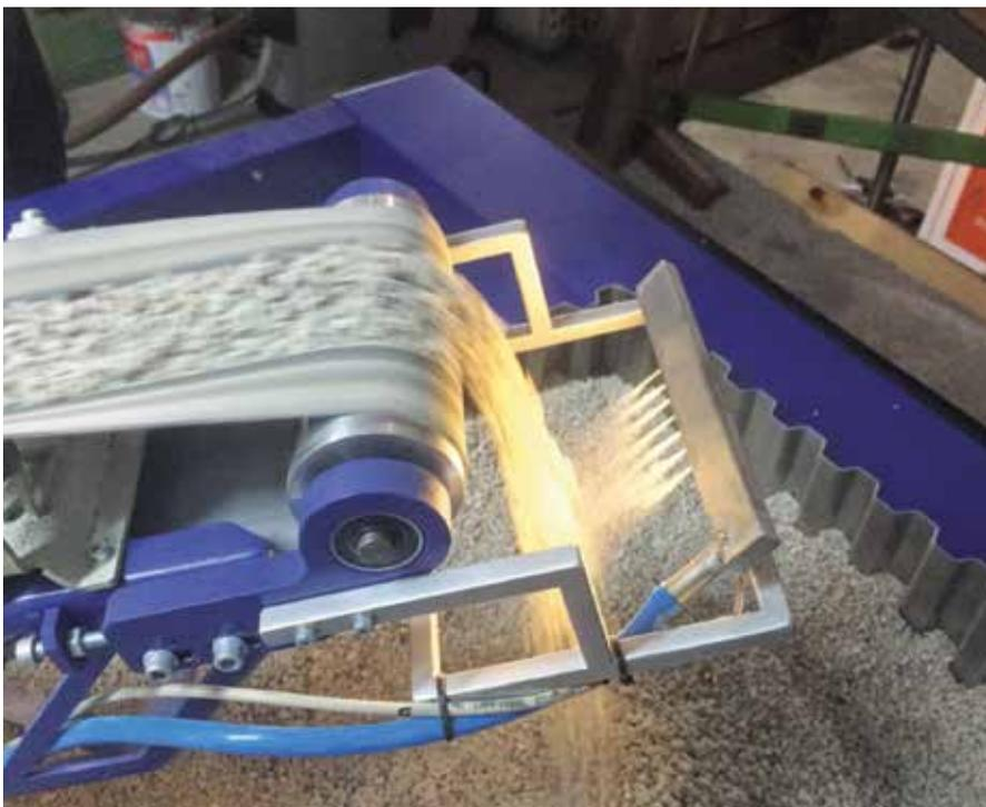
**NAH AN DER PROBLEMZONE:** Unmittelbar am Bandabwurf nebeln Sprühleisten direkt in den fallenden Materialstrom.
