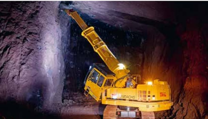
**WEITREICHEND FLEXIBEL:** Das Spitzenmodell TML Unidachs 850 deckt mit drehbarem Oberwagen und Kippkabine einen bemerkenswerten Arbeitsbereich ab.
