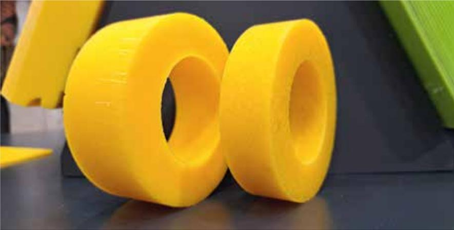
**KEIN SICHTBARER UNTERSCHIED:** Wenn aus rezykliertem Polyurethan, aufbereitet und granuliert, neue Werkteile entstehen, gleichen Qualität und Optik der des Originalwerkstoffs.
