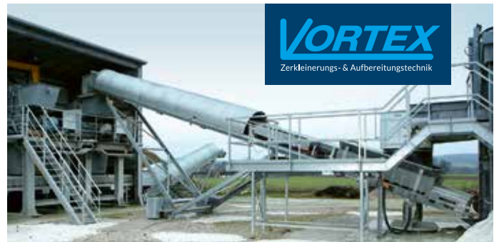
KIES, NATURSTEIN, RC-MATERIAL: Mit dem leistungsstarken innocrush-Prallbrecher ic35 bewältigt Mayr das erhöhte Aufkommen an Brechaufträgen. Fotos: innocrush
