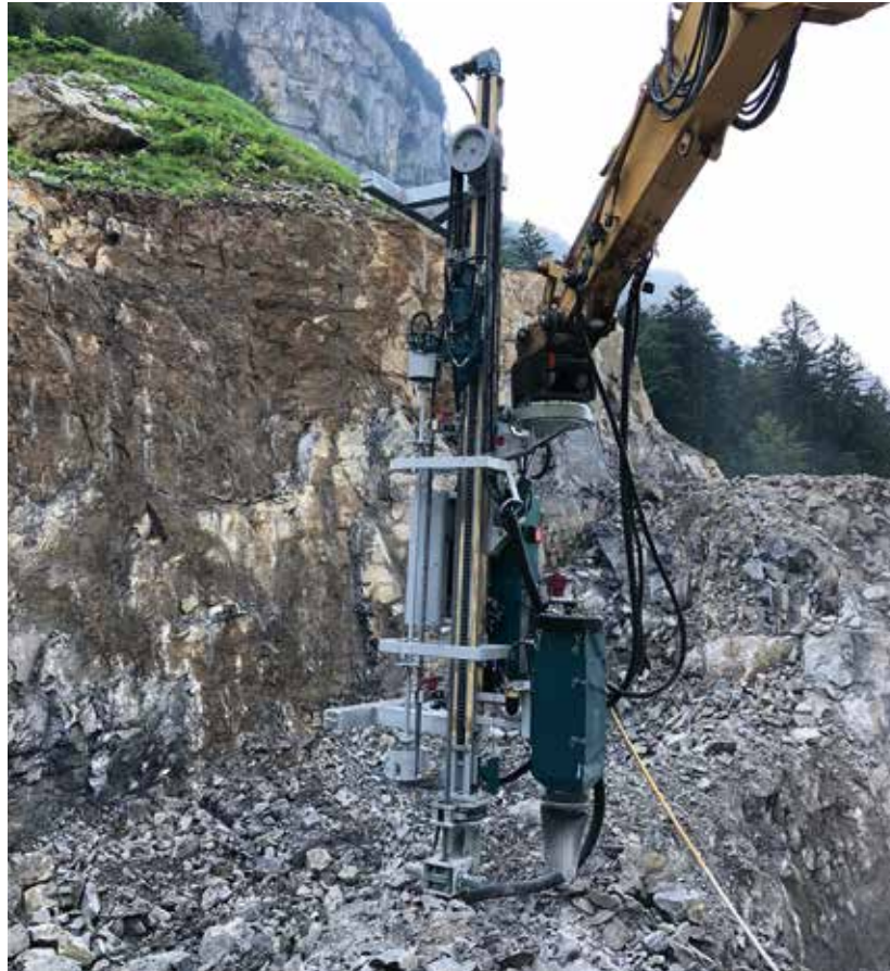
ANBAUBOHLAFETTEN für den Steinbrucheinsatz werden individuell auf die speziellen Anforderungen des jeweiligen Anwenders konfiguriert und gebaut. Foto: Lumesa
