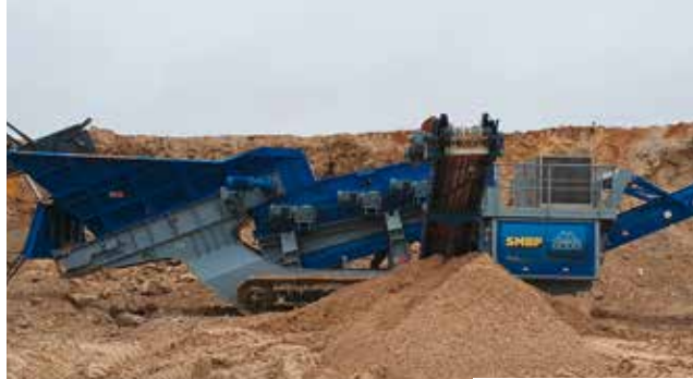
VOLLSTÄNDIG AUTARK arbeitet die erste kettenmobile AMR-Fingerrollenrost-Anlage seit 2019 in Frankreich.
