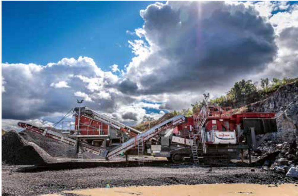
BRECHEN UND SIEBEN ALS GESAMTMOBILE EINHEIT: Der Doppelbrecher L120-330 von Jonsson hat 27,3 m Gesamtlänge, rund 133 t Gesamtgewicht und kommt erstmalig in Deutschland zum Einsatz. Fotos: mogroup
