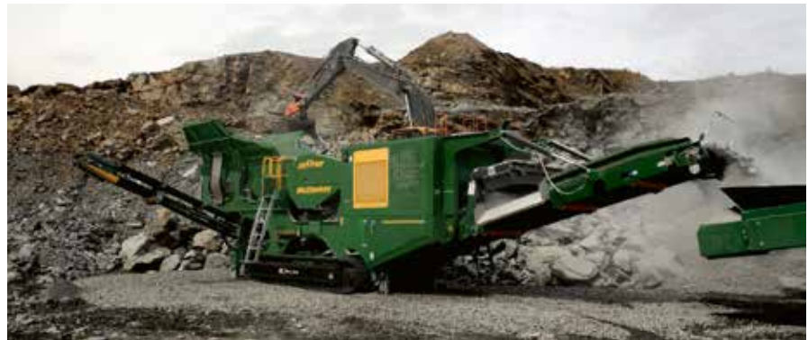
VERBESSERTER MATERIALFLUSS und eine hohe Stundenkapazität im Gesteinseinsatz zeichnen den Backenbrecher J4 aus. Foto: McCloskey
