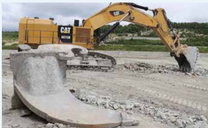
MECHANISCHE GEWINNUNG: Mit dem Reißen und Verladen des Kalksteins in Lengerich ist der 140-t-Bagger Cat 6015B gut ausgelastet. Fotos: Cat/Zeppelin
