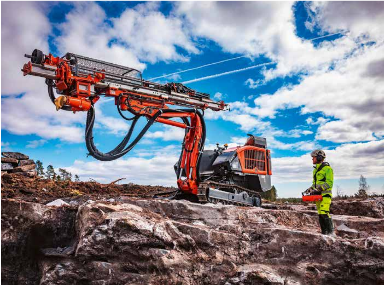
UPGRADE: Neuer Motor, breiterer Unterwagen, Karussell und Ein-Loch-Automatisierung sind Kennzeichen des Dino DC420Ri, der seit Ende 2022 verfügbar ist. Foto: Sandvik
