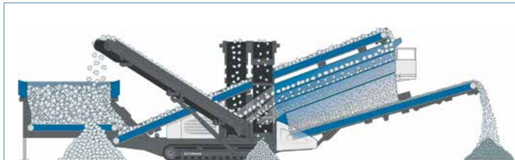
FLEXIBEL IN DER AUSRÜSTUNG: Eine typische Klassiersiebmaschine hat einen großen Aufgabebunker und zeichnet sich durch variable Siebdeckmöglichkeiten aus.
