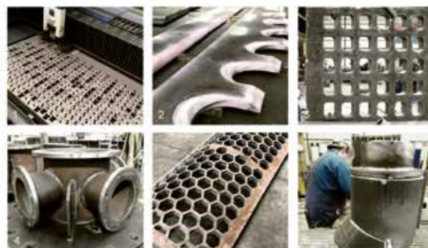
1. Laserzuschnitt mit hoher Toleranzgenauigkeit. 2. Messer mit anisot. Farbendringprüfung. 3. Sondersieb für einen Brecher im Steinbruch (t = 145mm). 4. Materialvertaler aus hochwertigen Abrieblufe - Rohren. 5. Sieb für die Recyclingindustrie. 6. Förderband für ein Braunkohlekraftwerk.
