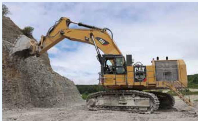
MECHANISCHE GEWINNUNG: Mit dem Reißen und Verladen des Kalksteins in Lengerich ist der 140-t-Bagger Cat 6015B gut ausgelastet. Fotos: Cat/Zeppelin
