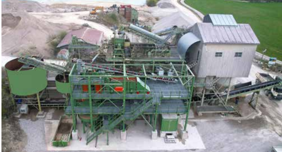
KOMBINATION: Eine Kies- und eine Bodenaufbereitungsanlage arbeiten direkt nebeneinander im Gelände eines Kiesunternehmens. Foto: Kilian Willibald GmbH
