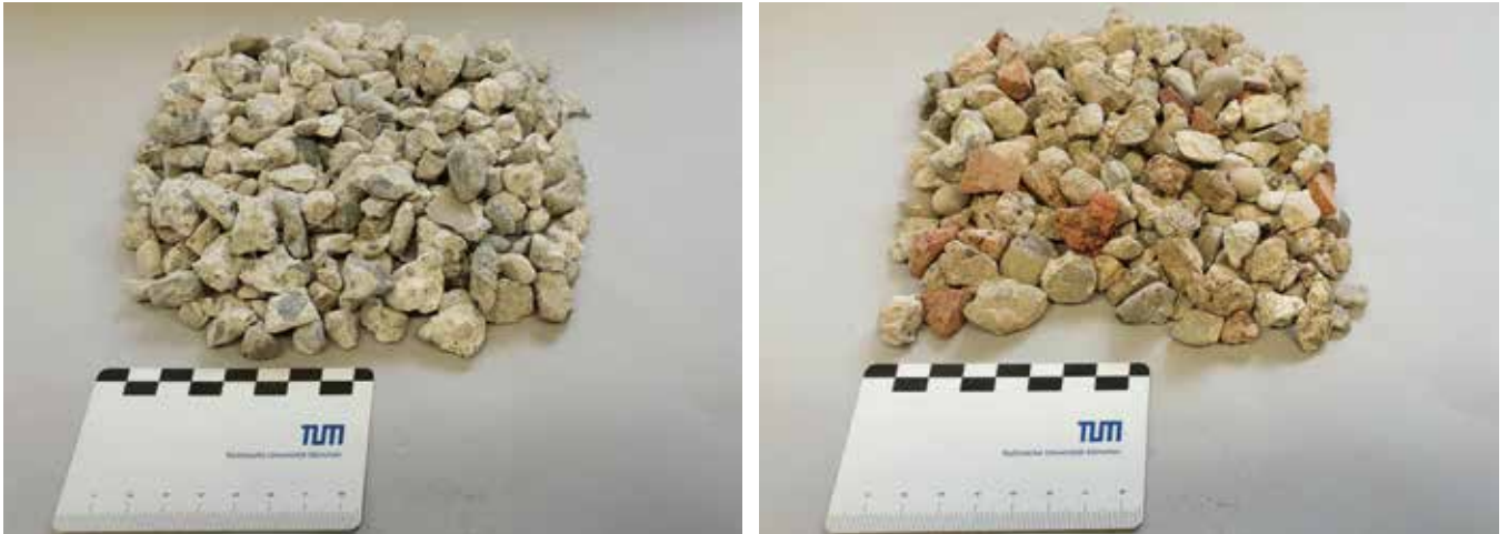
VERGLEICH: Aufbereitete RC-Beton-Gesteinskörnung 8/16. (Typ 1 nach DIN 4226-101; Mindestanteil der Stoffgruppe „Beton“ beträgt 90 M.-%, I.) und Beton-Gesteinskörnung 8/16 (Typ 2 nach DIN 4226-101; Mindestanteil der Stoffgruppe „Beton“ beträgt 70 M.-%) Fotos: K.-H. Krefz
