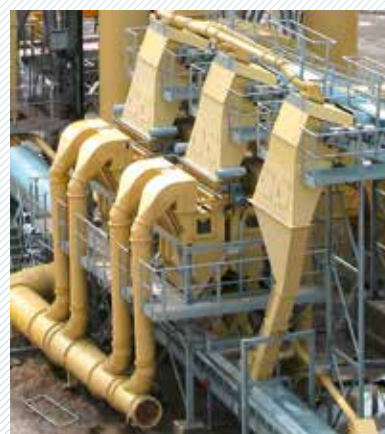
KASKADENSICHTER arbeiten nach einem einfachen Prinzip und zeichnen sich durch eine hohe Effizienz bei der Feinstkornabtrennung aus. Foto: Scheuch/Internet
