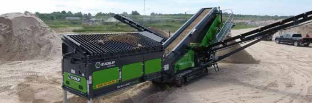
ANGEPASSTE AUFGABEBUNKER: Bei Klassiersieben wie der EvoQuip Falcon 1220 schützt meist ein Stangensieb – oder Grizzly – das nächste Siebdeck vor zu groben Brocken. Foto: Moerschen
