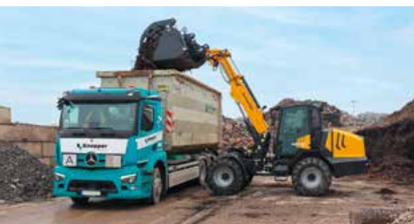
MEISTER ALLER KLASSEN: Schäffer-Teleradlader sind gefragte Maschinen in Verladung von Schütt- und anderen Gütern. Foto: Schäffer
