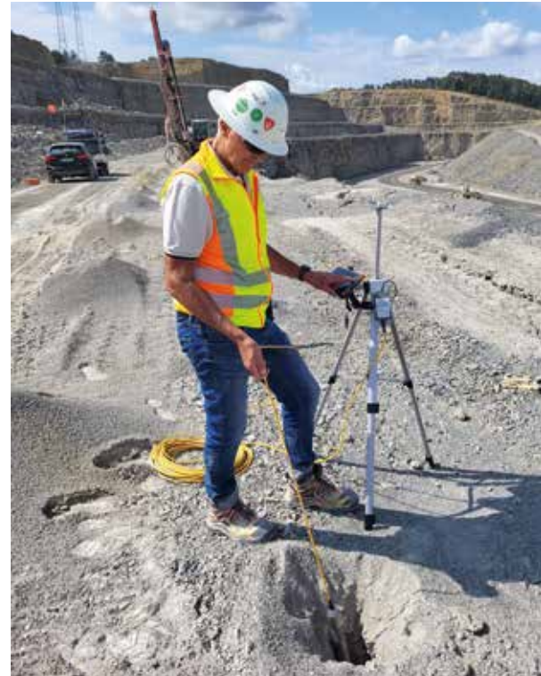
GÄNGIGE PRAXIS: eine Bohrlochvermessung mit Bohrlochsonde. Fotos: Geo-konzept GmbH
