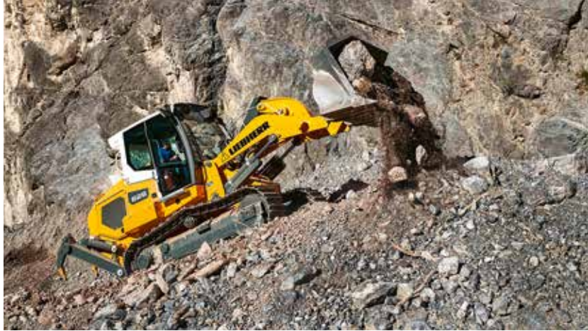
VORSTOSS IN UNSICHEREM TERRAIN: Mit der Geländegängigkeit einer Laderaupe können auch steile und unwegsame Haldenbereiche bearbeitet werden.
