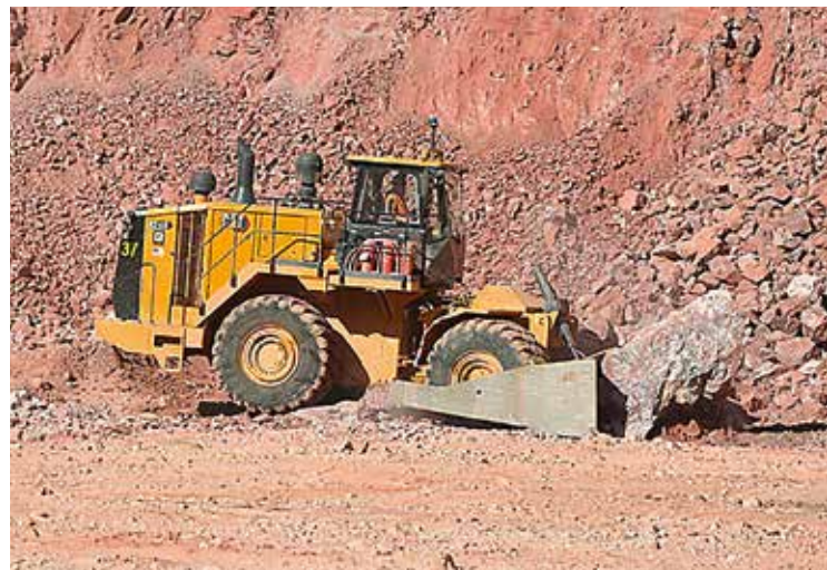
UNGEWÖHNLICH UND MOBIL: Mit einem Raddozer kombiniert der Anwender einige Merkmale der Planierdraupe mit der Mobilität eines großen Radladers.
