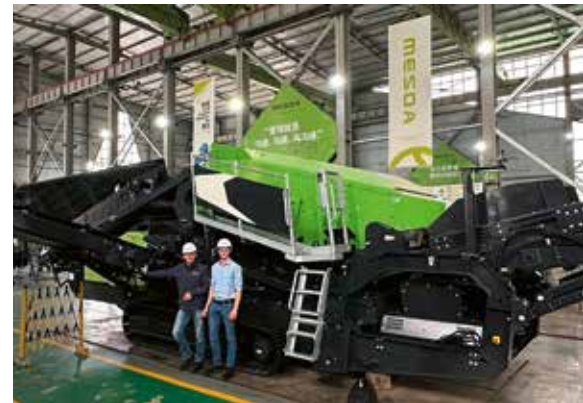
BEREIT ZUR ABHOLUNG: Sönke Strehl (l.), Inhaber Teufelsmoor Baumaschinen, vor einer S5D-Grobstücksiebanlage im Mesda-Werk. Die Anlage mit dieselhydraulischem Antriebskonzept bietet hohe Leistung und Flexibilität im Einsatz.
