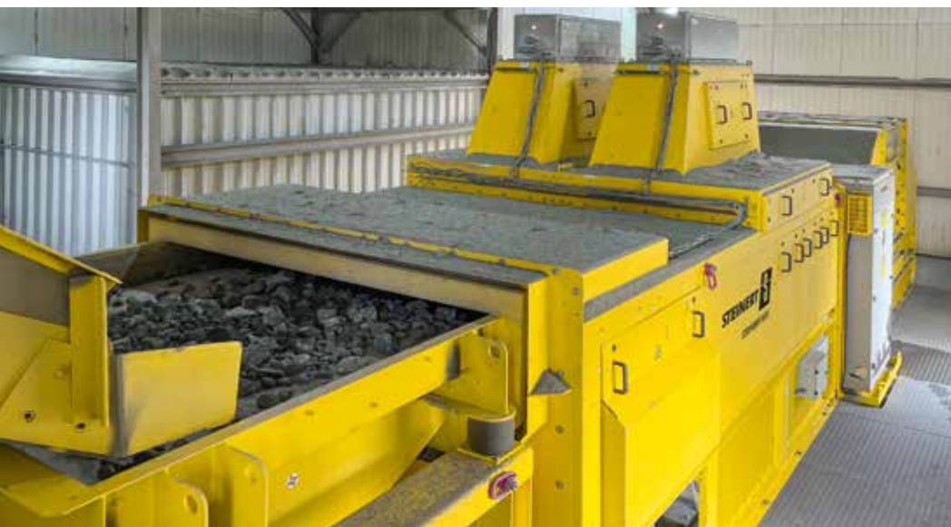
MULTISENSOR-SORTIERUNG ALS KOMBINATIONSSORTIERSYSTEM: Das Steinert-KSS-Sortiersystem kombiniert den Röntgentransmissionssensor mit drei weiteren Sensoroptionen (Induktionssensor, 3D-Lasersensor und Farbsensor). Foto: Steinert
