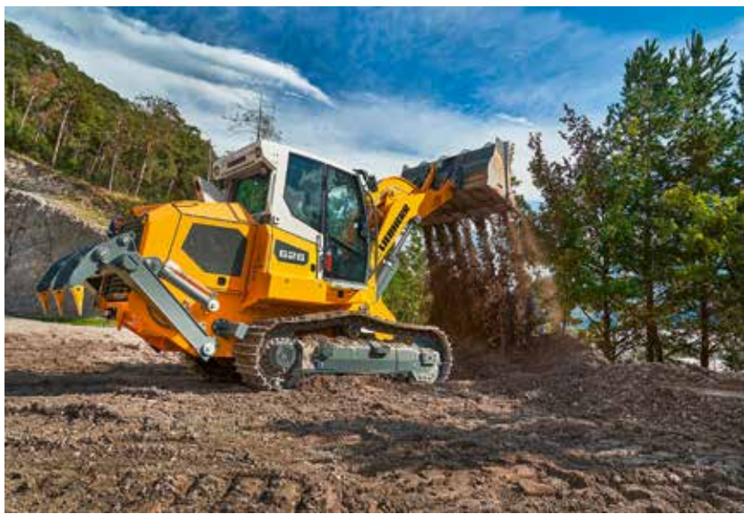
AUSSTATTUNGSOPTIONEN ALS TRUMPF: Laderaupen lassen sich wie Dozer auch mit Heckaufreißer ausstatten. Fotos: Caterpillar/Liebherr
