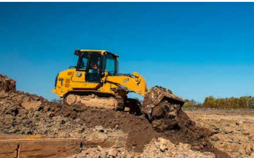
SICHER AUF LOSEM BODEN: Die Raupenkettensysteme üben nur geringen Bodendruck aus und erlauben das Arbeiten auf weichem Untergrund.
