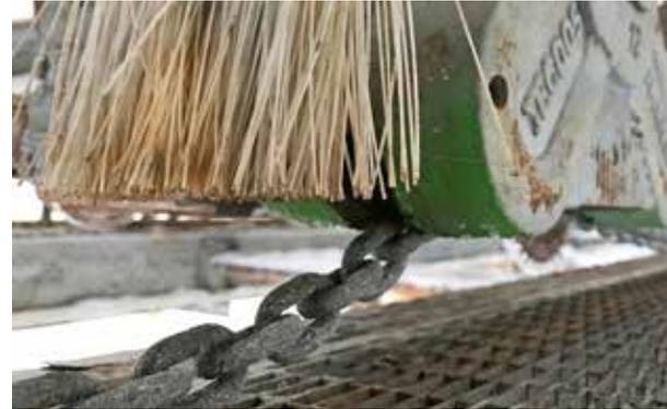
**ANTRIEBSSYSTEM** bestehend aus Tecdos-Omega Drive-Antrieb und Tecdos-Rundstahlkette.
