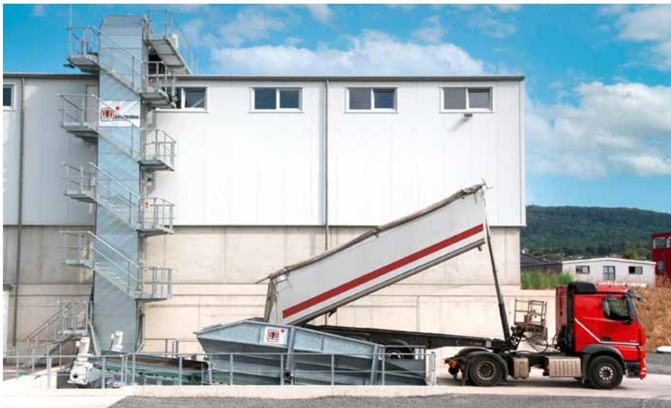
**TRANSPORTBETONWERK ELGERSHAUSEN:** Für den Neubau lieferte VHV Anlagenbau an Weser-Diemel-Beton die gesamte Fördertechnik von der Annahmestation bis hin zum Wiegeband vor der Transportbeton-Mischanlage.
