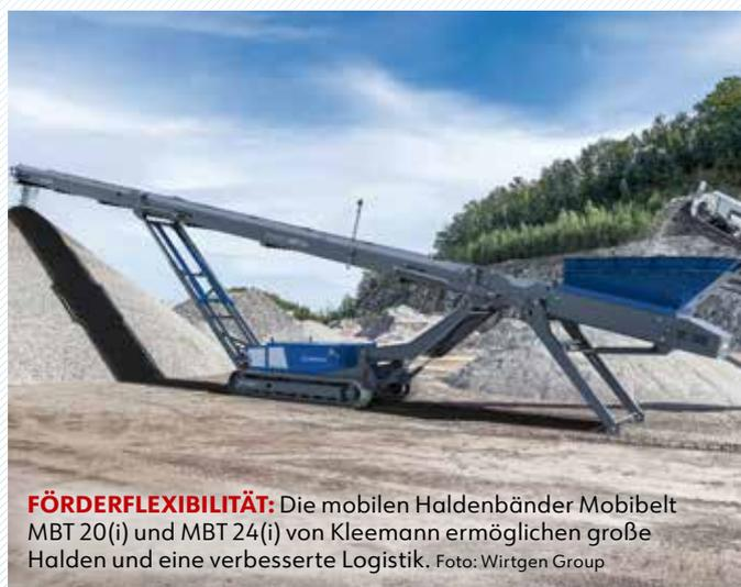
**FÖRDERFLEXIBILITÄT:** Die mobilen Haldenbänder Mobibelt MBT 20(i) und MBT 24(i) von Kleemann ermöglichen große Halden und eine verbesserte Logistik. Foto: Wirtgen Group
