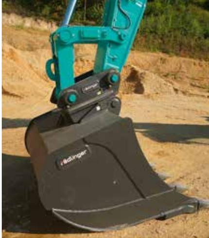
**AUF KUNDENWUNSCH** rüstete EMB den 37-Tonner mit einem 2,3-m<sup>3</sup>-Tiefelöffel am mechanischen Schnellwechsler aus ...
