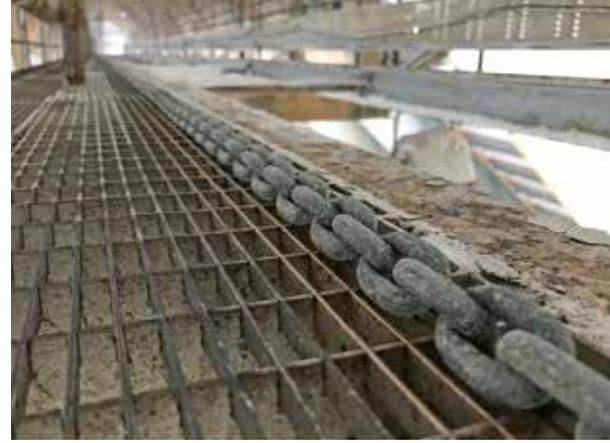
**ROBUSTE PFLICHTERFÜLLUNG:** Die Tecdos-Rundstahlkette aus einsatzgehärtetem Stahl trotz aggressiven Medien und Witterungsbedingungen.
