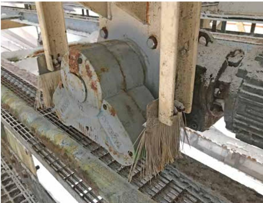
**KOMPAKTER ANTRIEB:** Der Teccos Omega Drive ist direkt am SEW-Motor befestigt. Fotos: K+S
