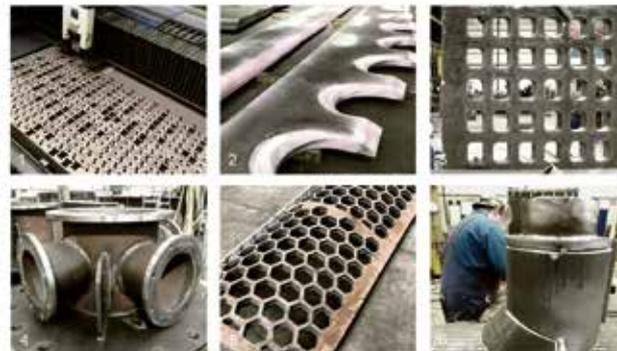
1. Laserschnitt mit hoher Toleranzgenauigkeit. 2. Messer mit anachit Farbendringprüfung. 3. Sondersatz für einen Brecher im Steinbruch (t = 105mm). 4. Materialverteiler aus hochwertigen Abzulauf-Röhren. 5. Sieb für die Recyclingindustrie. 6. Erreimerbaul für ein Braunkohlekraftwerk.
