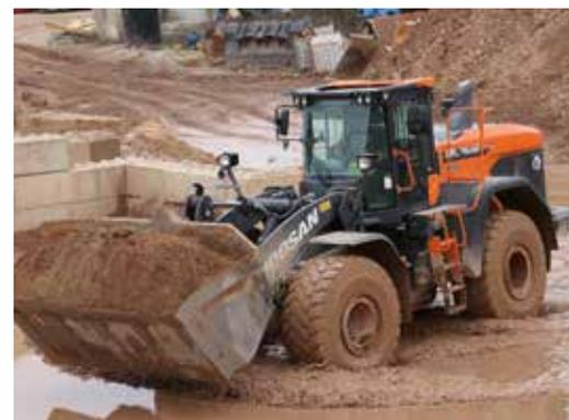
**HOHE KAPAZITÄT:** Bei Müller und Töchter wird der Radlader mit einer 4,7-m<sup>3</sup>-Schaufel eingesetzt. Fotos: Doosan
