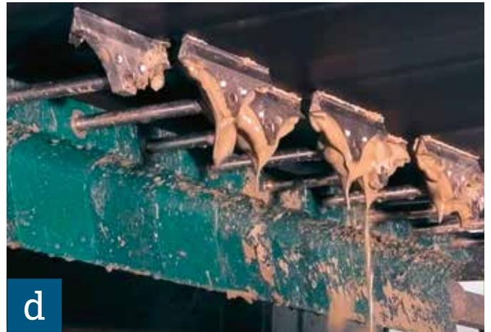
**MODULE DES SYSTEMS:** Scrapper Intelligence Modul (SIM) (a), Motorisierungsset mit S3 Sensorik (b), Messrolle mit Sensorik (c) und Abstreifer (d).
