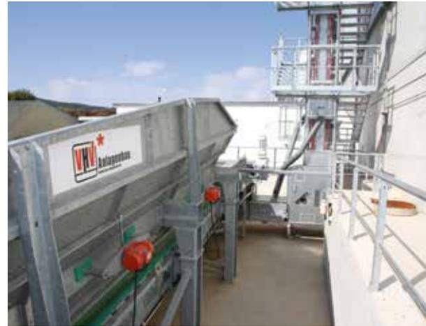
**DIE ROTEN RÜTTLER** wirken direkt auf die Spaltroste, sodass Materialreste zuverlässig entfernt werden. Die Bunkerbleche benötigen keine Rüttler, was sich lärmindernd auswirkt. Anlagenfotos: VHV
