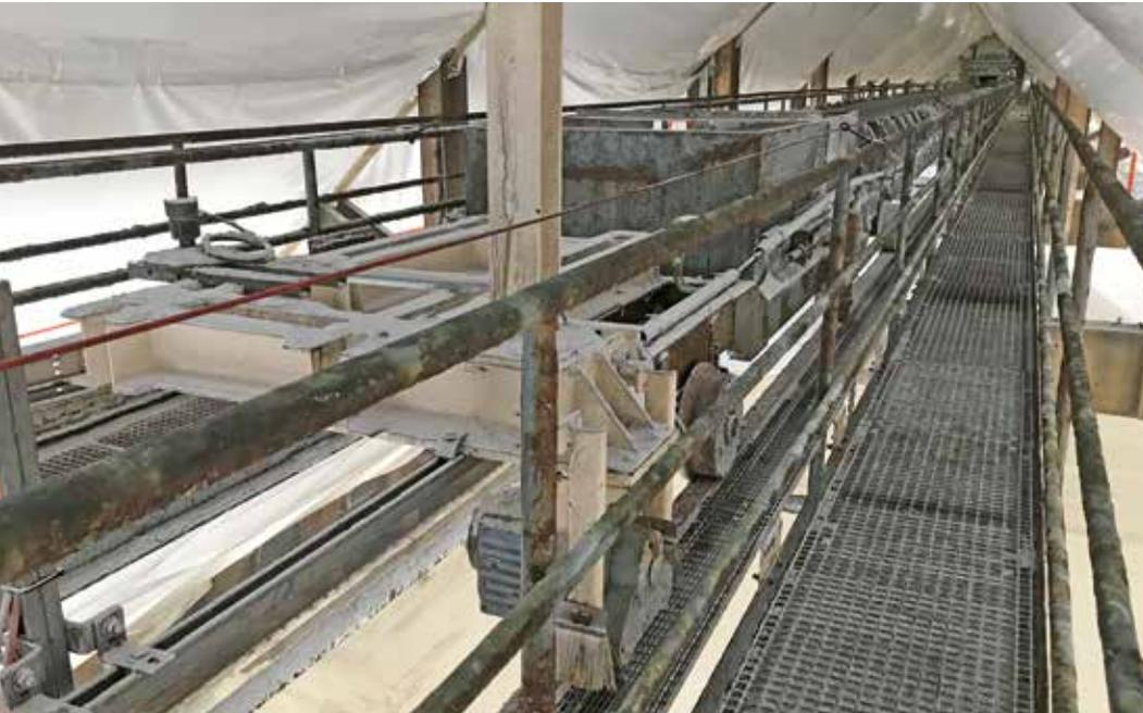
**FAHRWEG IN LUFTIGER HÖHE:** Der optimierte Bandabsetzer von 70 m Länge arbeitet in über 20 m Höhe.
