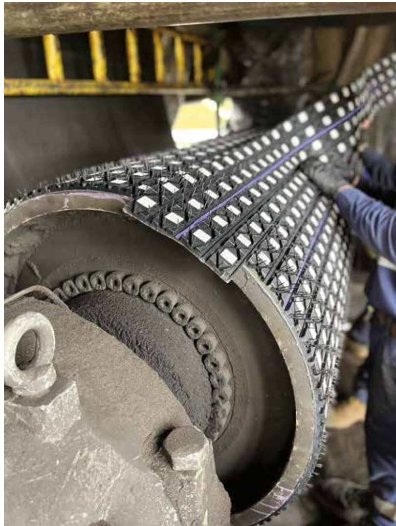
FÜR BESTMÖGLICHEN GRIP sorgen die verschiedenen Trommelbeläge.
