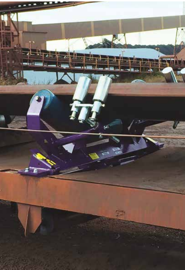
SELBSTJUSTIERENDE BANDFÜHRUNGSSYSTEME verhindern große Schäden an Band und Anlage. Fotos: Flexco
