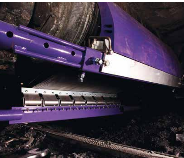
PERFEKT ABGESTIMMT: Die Kombination von Primär- und Sekundärabstreifern sorgt für bis zu 90 % Reinigungsleistung.
