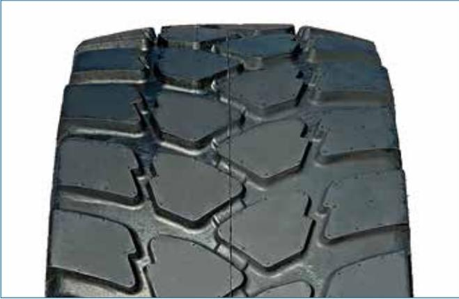
**GROSSER FUSSABDRUCK:** Die speziellen Flotationsreifen von Ascenso verbinden Heavy-Duty-Eigenschaften mit geringem Bodendruck.
