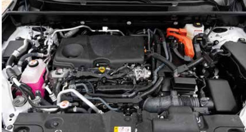
**TECHNIK SCHÖN VERPACKT:** Der Blick in den Motorraum zeigt den 2,5-l-Vier-Zylinder-Benziner und Teile der Elektronik für den auch verbauten E-Motor.
