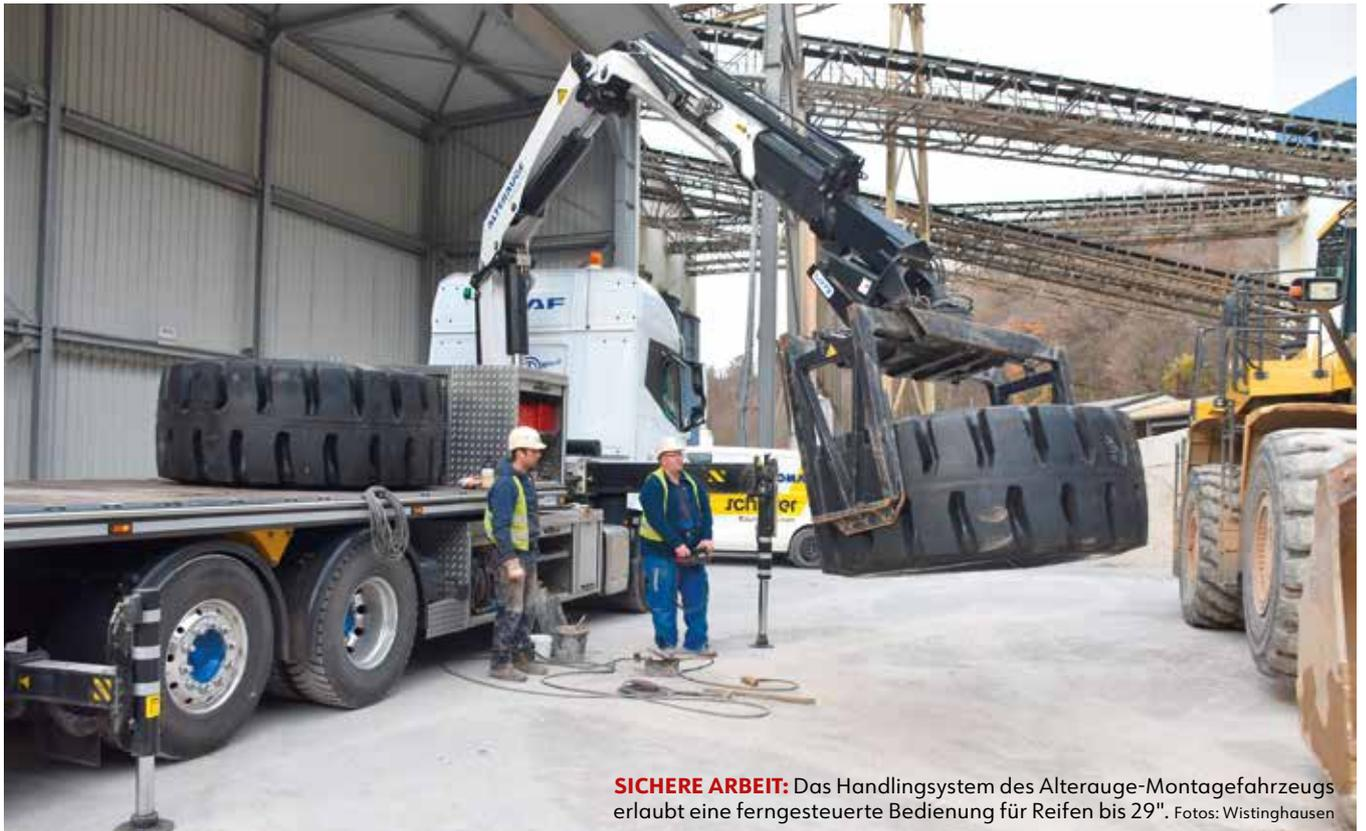
**SICHERE ARBEIT:** Das Handlingsystem des Alterauge-Montagefahrzeugs erlaubt eine ferngesteuerte Bedienung für Reifen bis 29". Fotos: Wistinghausen
