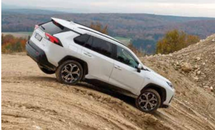
**BERGAB MIT REGELN:** Die Elektronik greift beim Bergabfahren ins ABS, in Lenkung und Gaspedal ein.
