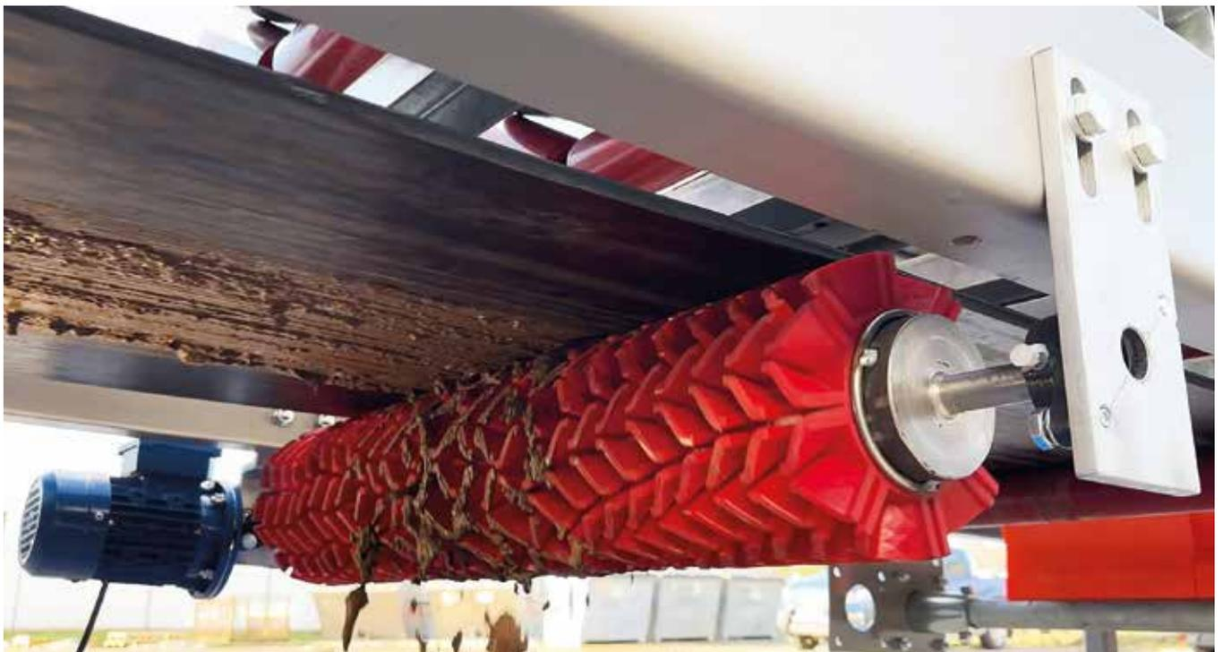
**DIE UNTERGURT-ABSTREIFROLLE** von Pucest ist speziell für die effiziente Reinigung des Untergurts von Förderbändern entwickelt worden.
