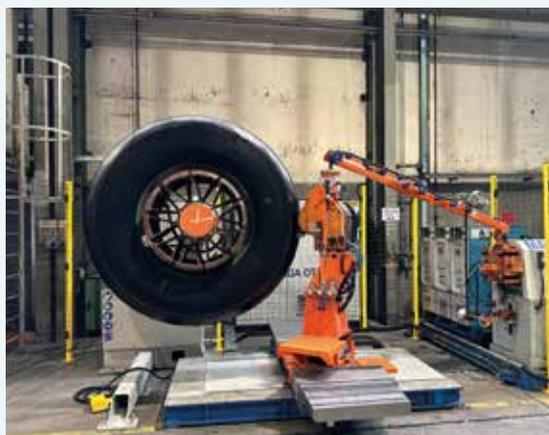
**EXAKTE FERTIGUNG:** Bei Marangoni entstehen große EM-Reifen auf modernen Runderneuerungsmaschinen ...
