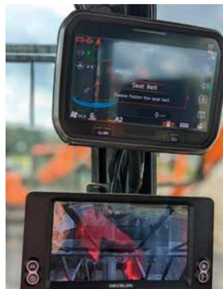
**SINNVOLLE NEUHEIT:** Das „Smart Transparent Bucket“-System für Radlader leuchtet die toten Winkel mithilfe zweier Kameras in Echtzeit vor der Schaufel aus.
