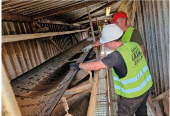
**REMA-EXPERTEN** wählten ein spezielles Förderbandprofil für einen optimalen Materialtransport der feuchten Hackschnitzel. Foto: Rema Tip Top
