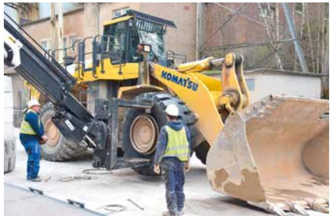
**TYPENSPECIFISCHE ERLEICHTERUNG:** Der schwere Radlader kann sich mit seinem Schaufelvolumen um die 7 m<sup>3</sup> selbst aufbocken.
