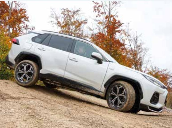
**STIELHANG GEHT IMMER:** Im Allradantrieb-Modus hilft der Elektromotor für die Hinterachse weiter.
