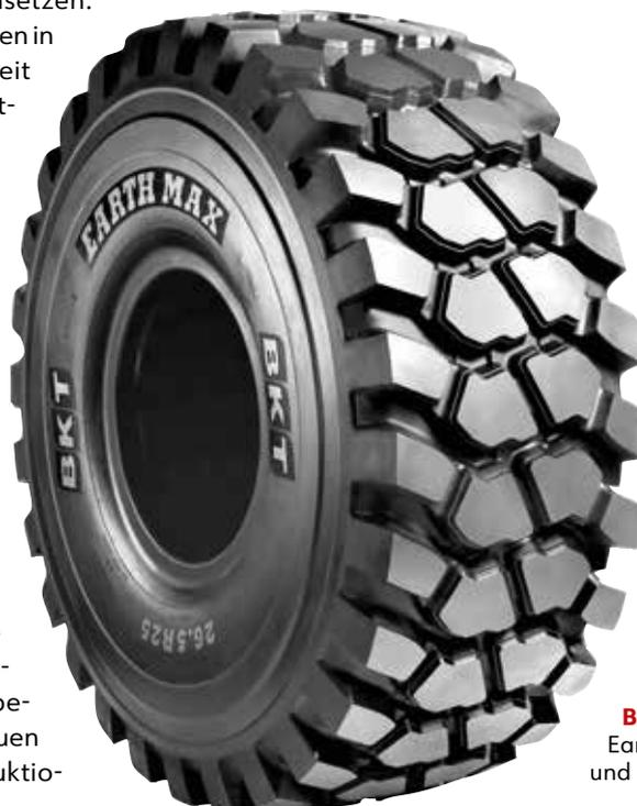
**BEISPIELHAFTER EM-REIFEN:** Dieser BKT Earthmax SR-41 hat eine Dimension 26.5R25 und die Kennung: E4\*/L4\*.
