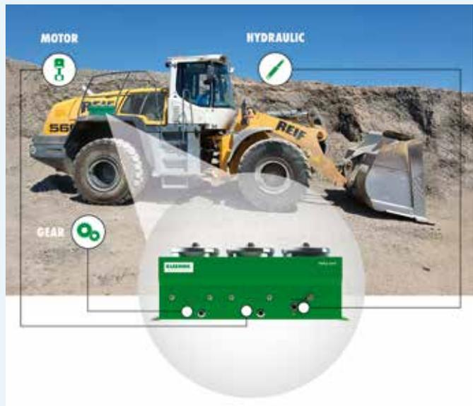
**MOTOR, HYDRAULIK, GETRIEBE:** Drei verschiedene Ölkreisläufe profitieren gleichzeitig von der Feinstfilterung der Kleenoil Triple Unit im Nebenstrom. Foto: Kleenoil Panolin
