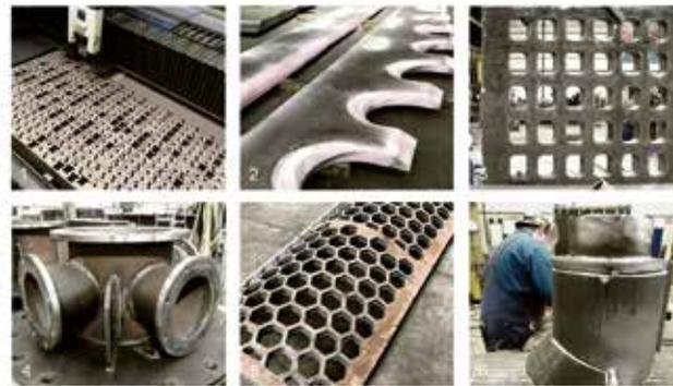
1. Laserschnitt mit hoher Toleranzgenauigkeit. 2. Messer mit anodisierter Farbendringprüfung. 3. Sondersieb für einen Brecher im Steinbruch (t = 145mm). 4. Materialverteiler aus hochwertigen Abrieblufe-Röhren. 5. Sieb für die Recyclingindustrie. 6. Förderbauteil für ein Braunkohlekraftwerk.
