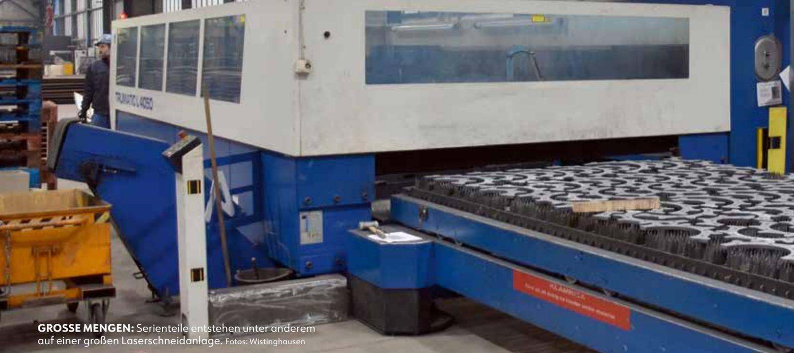
**GROSSE MENGEN:** Serienteile entstehen unter anderem auf einer großen Laserschneidanlage. Fotos: Wistinghausen
