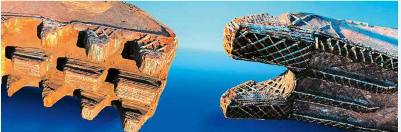
**AUFPANZERUNGEN** wie hier an einem Pulverisierer sind an allen zu regenerierenden Anbaugeräten möglich. Foto: HS-Schoch
