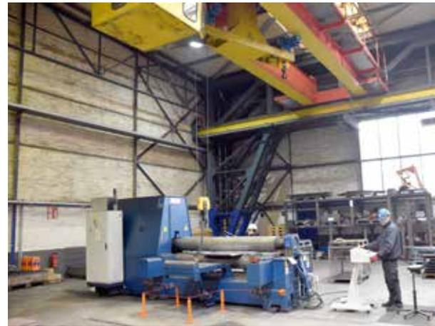
**GROSSE TIEFE:** Für den Bau von Zylinderrundungen lässt sich die Walzanlage einsetzen.
