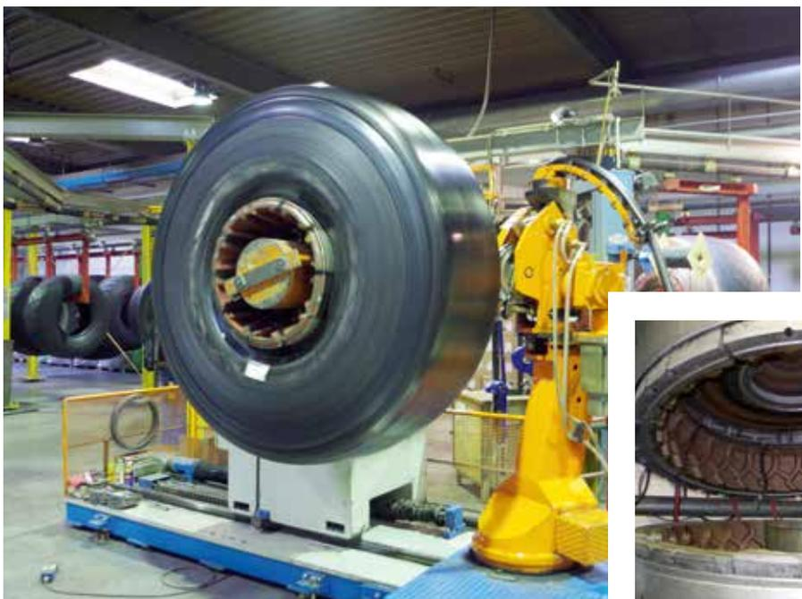
**SPEZIALISIERT:** Auf hochmodernen Maschinen werden die Rodos-Reifen im Werk in Dortmund bearbeitet. Der Prozess entspricht der Neureifen-Fertigung.
