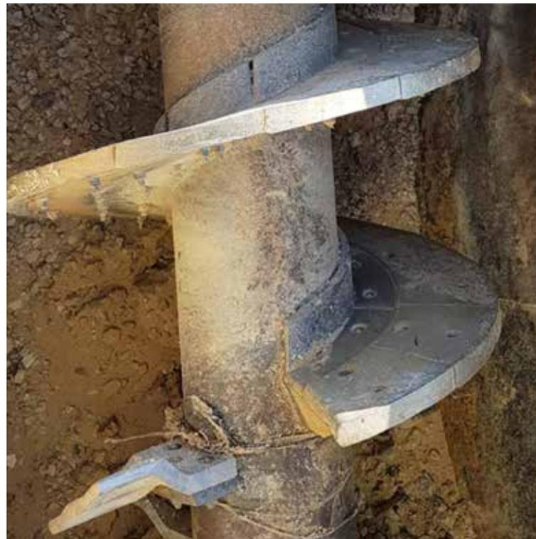
**ARBEITSKRAFT ERHALTEN:** Anhand von Zeichnungen oder Mustern werden die unterschiedlichsten Verschleißteile für alle Typen von Sand- und Kieswaschanlagen gefertigt. Fotos: Verotool.de
