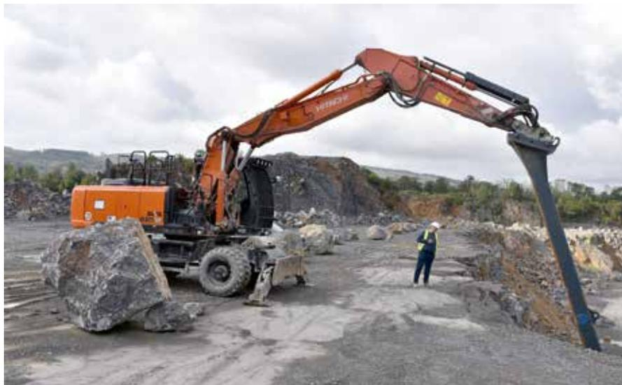
**STEINBRUCHGEEIGNET:** Der Hitachi ZX220W-5 verfügt über eine Vier-Pratzen-Abstützung sowie ein Rops/Fops-Kabinenschutzdach. Fotos: Wistinghausen
