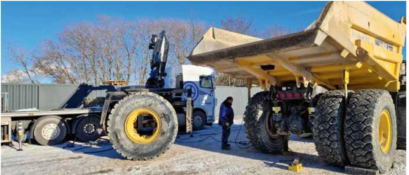
**GRUNDLAGE FÜR DEN SERVICE** sind gut ausgestattete Montage-Lkw mit Kran und Reifenkralle. Die Monteure von Alterauge wechseln mehrere Hundert EM-Reifen im Jahr.
