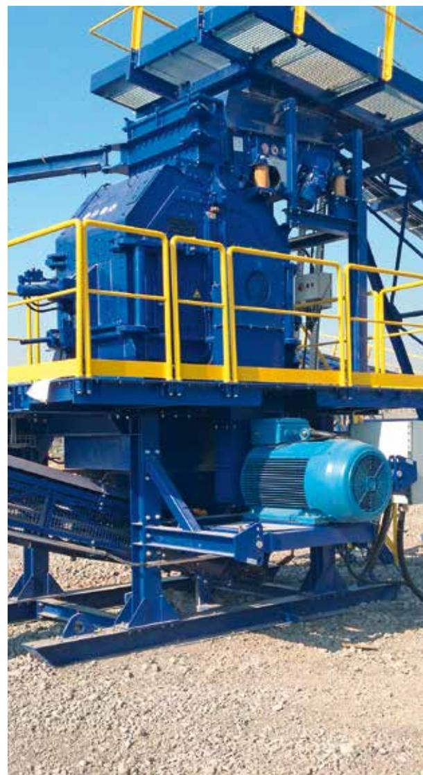
**EINSATZ AUF KUFEN:** Der geringe Installationsaufwand der SMR-Brecher erlaubt auch den wirtschaftlich-flexiblen Einsatz als semistationäre Brechstufe.
