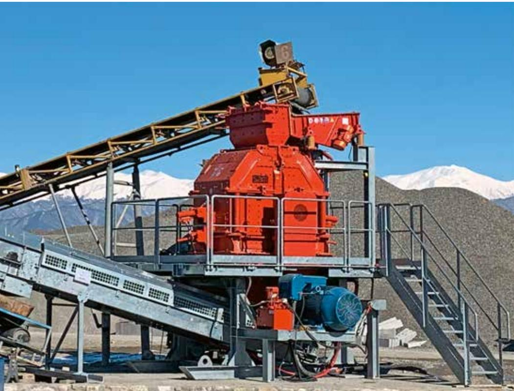
**BRECHPRODUKTE AUS ÜBERKORN:** Die SMR-Technologie im Einsatz bei der Verarbeitung von Kiesüberkorn zu sandarmen Endprodukten. Fotos und Grafik: SBM MP
