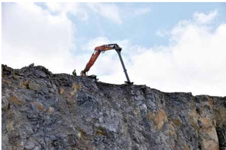
**ZUM BERAUBEN** der Wände kommt eine eigens designte Stoßlanze als spezieller Ausleger zum Einsatz. Der Bediener steuert das Gerät in Sichtweite von der unteren Sohle aus, der Einweiser am Gerät steht in Funkkontakt mit ihm.
