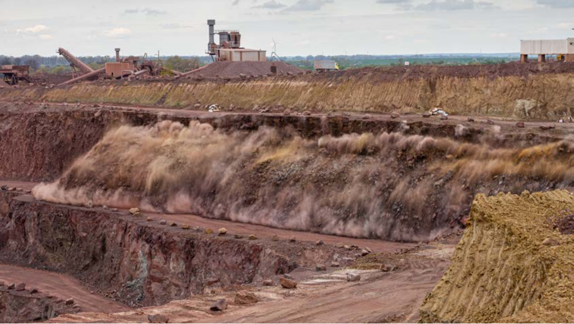
Abbildung 4: Sprengung auf der obersten Andesit-Sohle.
