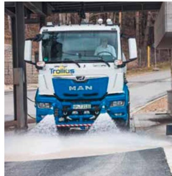
**Das Fahrzeug auf Basis eines MAN TGS 26.510 hat diverseste Möglichkeiten der Staubbindung mit Wasser.**
