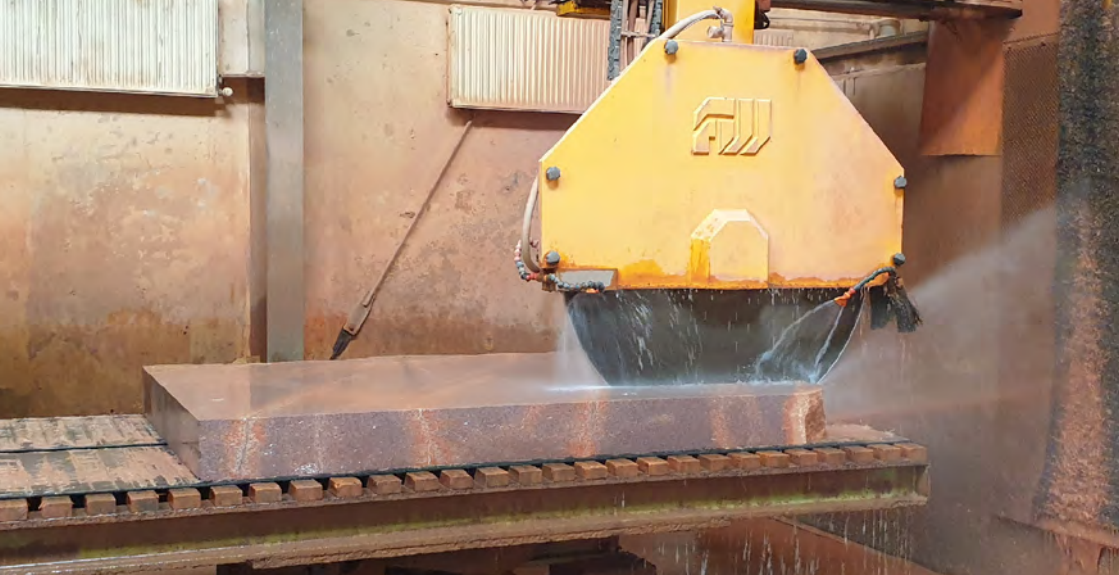
Abb. 1: Sägen einer Werksteinplatte in der Betriebsstätte der Rochlitzer Porphyry GmbH (Foto: T. Járóka / LfULG).
