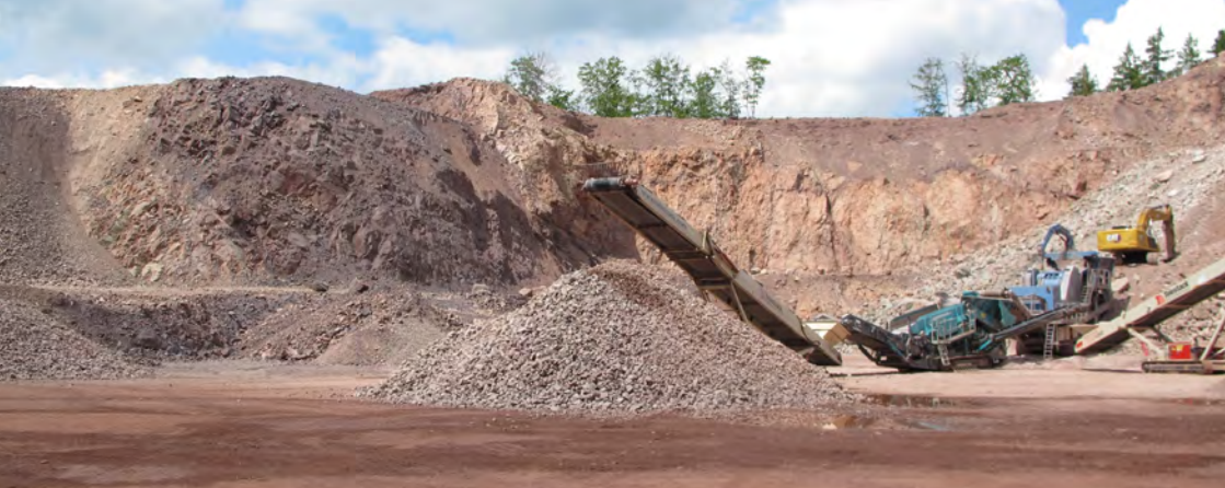
Abb. 3: Klassierung des gewonnenen Rhyoliths mittels mobiler Brecheranlage im Tagebau Etterwinden (Foto: TLUBN)
