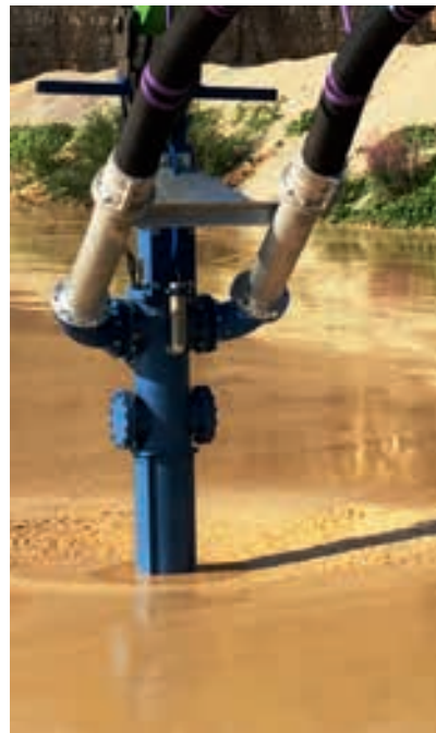
Um die Suspension zu nutzen, wurde ein Sennebogen-Umschlagbagger in Eigenregie mit einer Wangen-Saugpumpe und einem Zunhammer-Übergabegalgen inkl. einer aufwendigen Verrohrung umgebaut.
