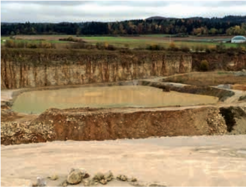
Bislang wurde noch eine große Menge der Kalk-/Dolomit-Suspension 0–20 \mu in ein Vorhaltebecken gepumpt.
